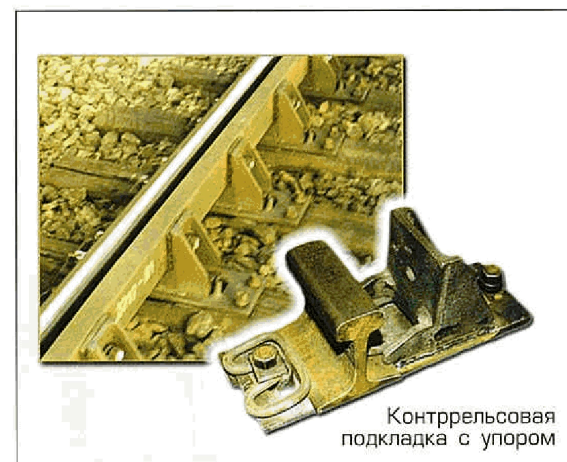
При эксплуатации таких узлов бывают случаи разрыва болтов, что влияет на безопасность движения. В новой конструкции контррельс изготовлен из другого профиля и не связан с ходовым рельсом. Боковой износ контррельса можно компенсировать за счет установки регулировочных металлических пластин.
