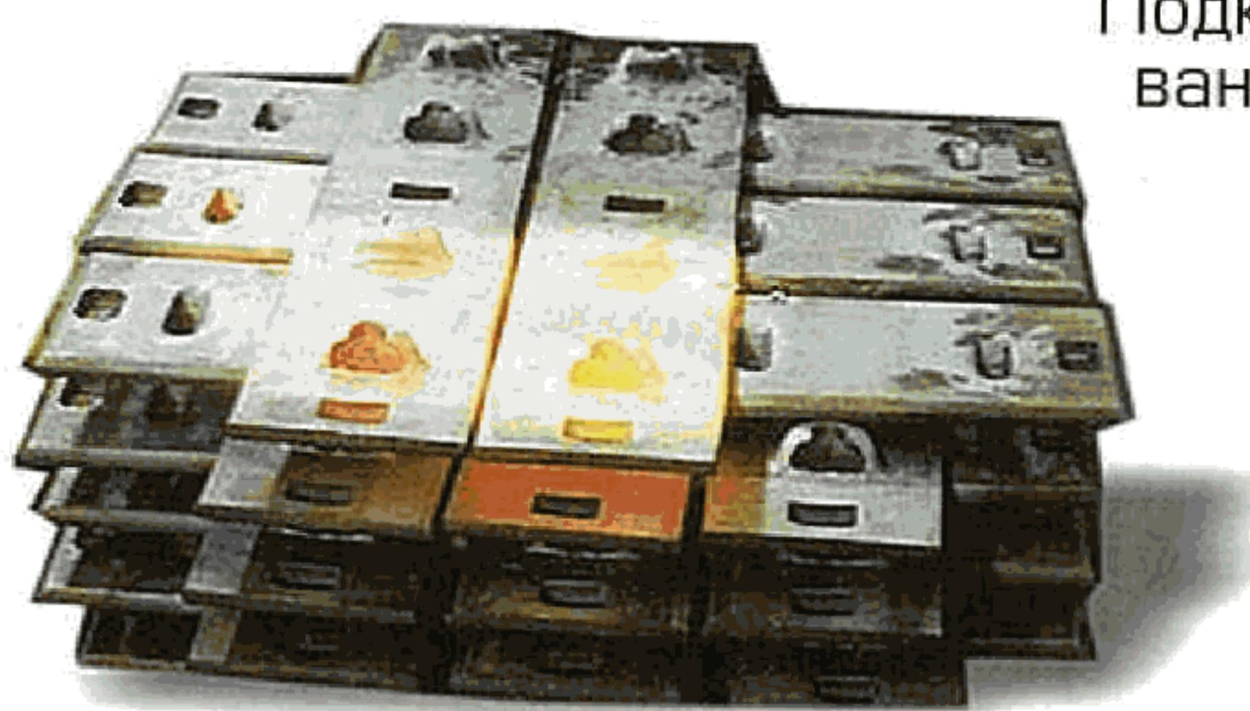
При применении подкладок с высокими ребордами внедряется принцип раздельного скрепления деталей перевода с брусьями, которое позволяет производить замену элементов стрелочного перевода, не отделяя подкладки от бруса. Подкладки с высокими цельнотянутыми ребордами позволяют повысить надежность скрепления, получить стабильность рельсовой колеи за все время эксплуатации, при этом значительно сокращаются затраты на текущее содержание.
