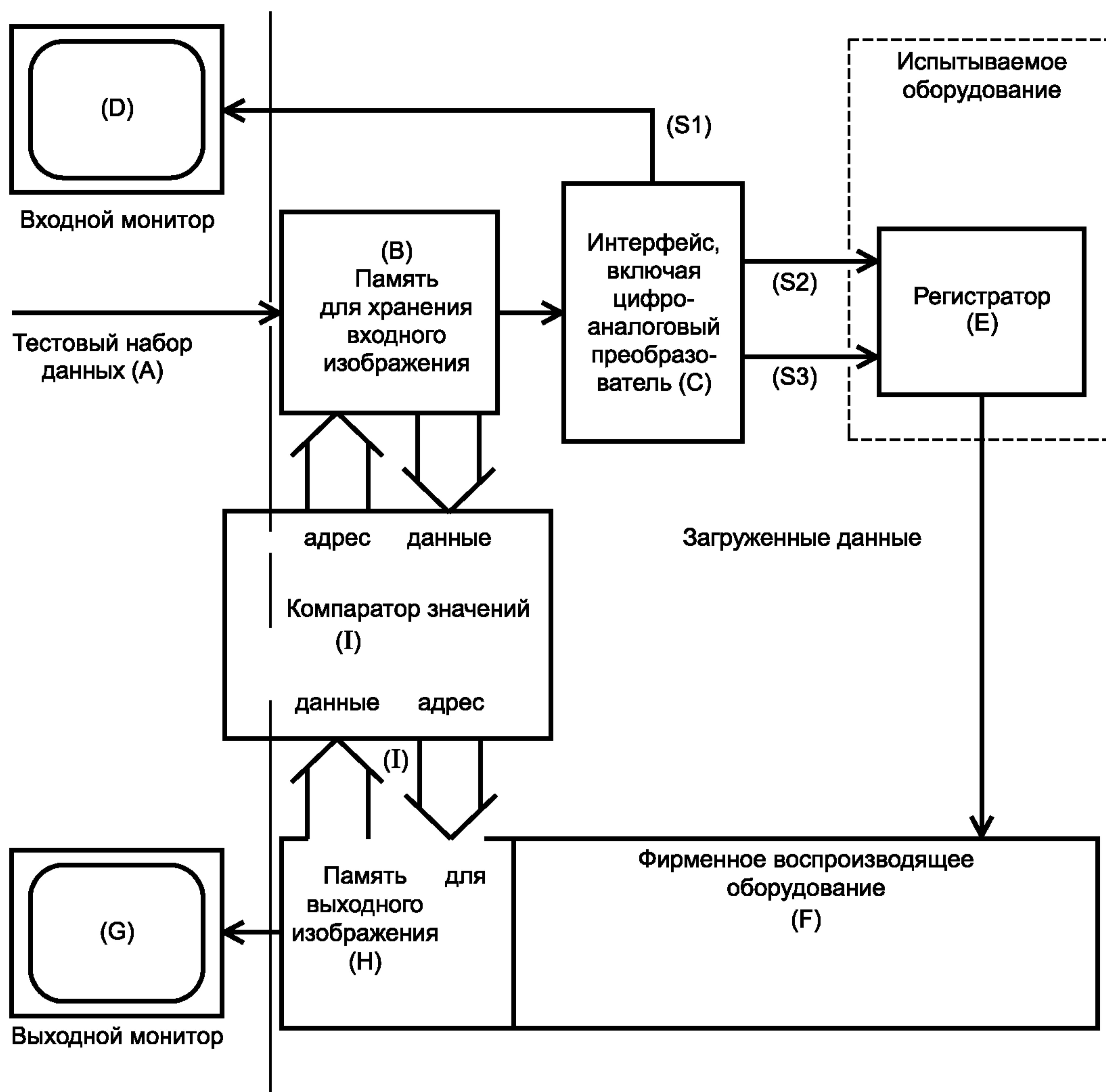
Рисунок 1 — Блок-схема испытаний
