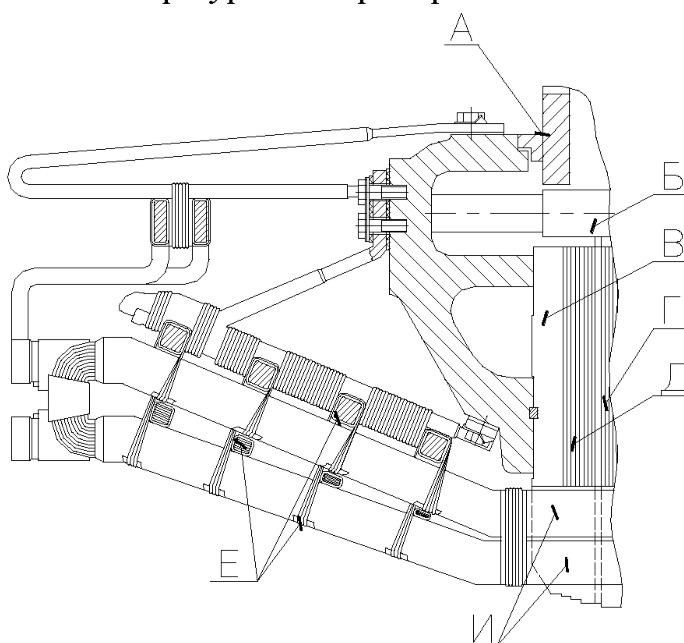
Статор турбогенератора ТВ2-100-2 (ТВ2-150-2)
