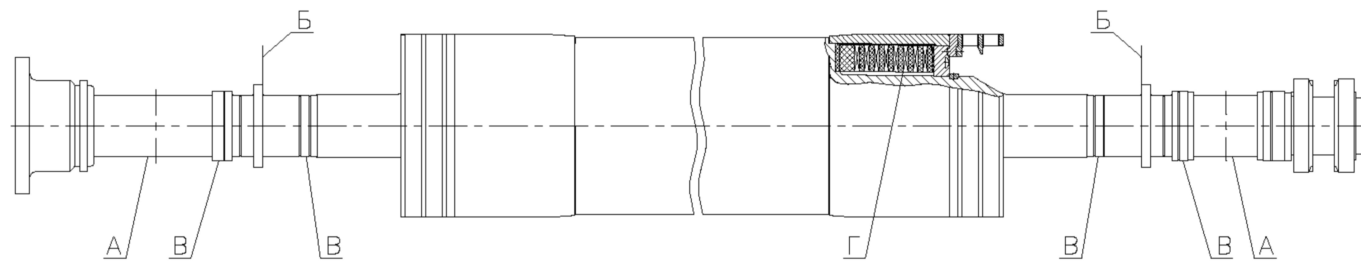
Ротор турбогенераторов ТВ2-100-2 и ТВ2-150-2
