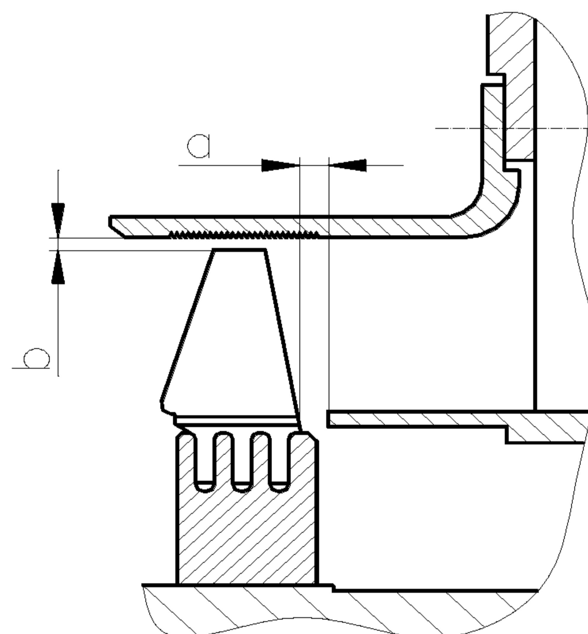
Рисунок 8.2 - Осевые и радиальные зазоры между вентилятором и обтекателем (турбогенераторы TB2-100-2 и TB2-150-2).
