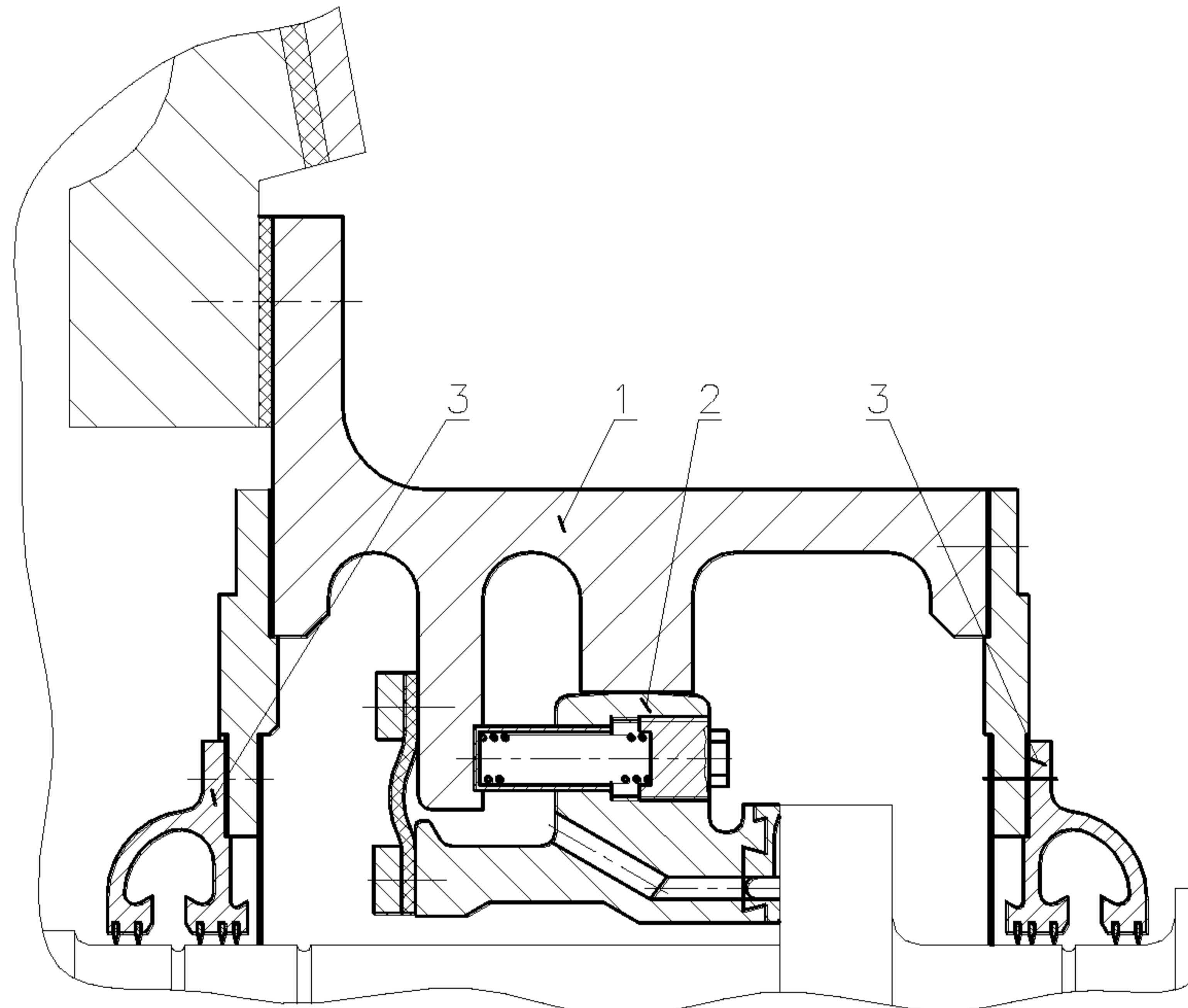
1 – корпус уплотнения; 2 – вкладыш уплотнения; 3 – маслоуловитель;
