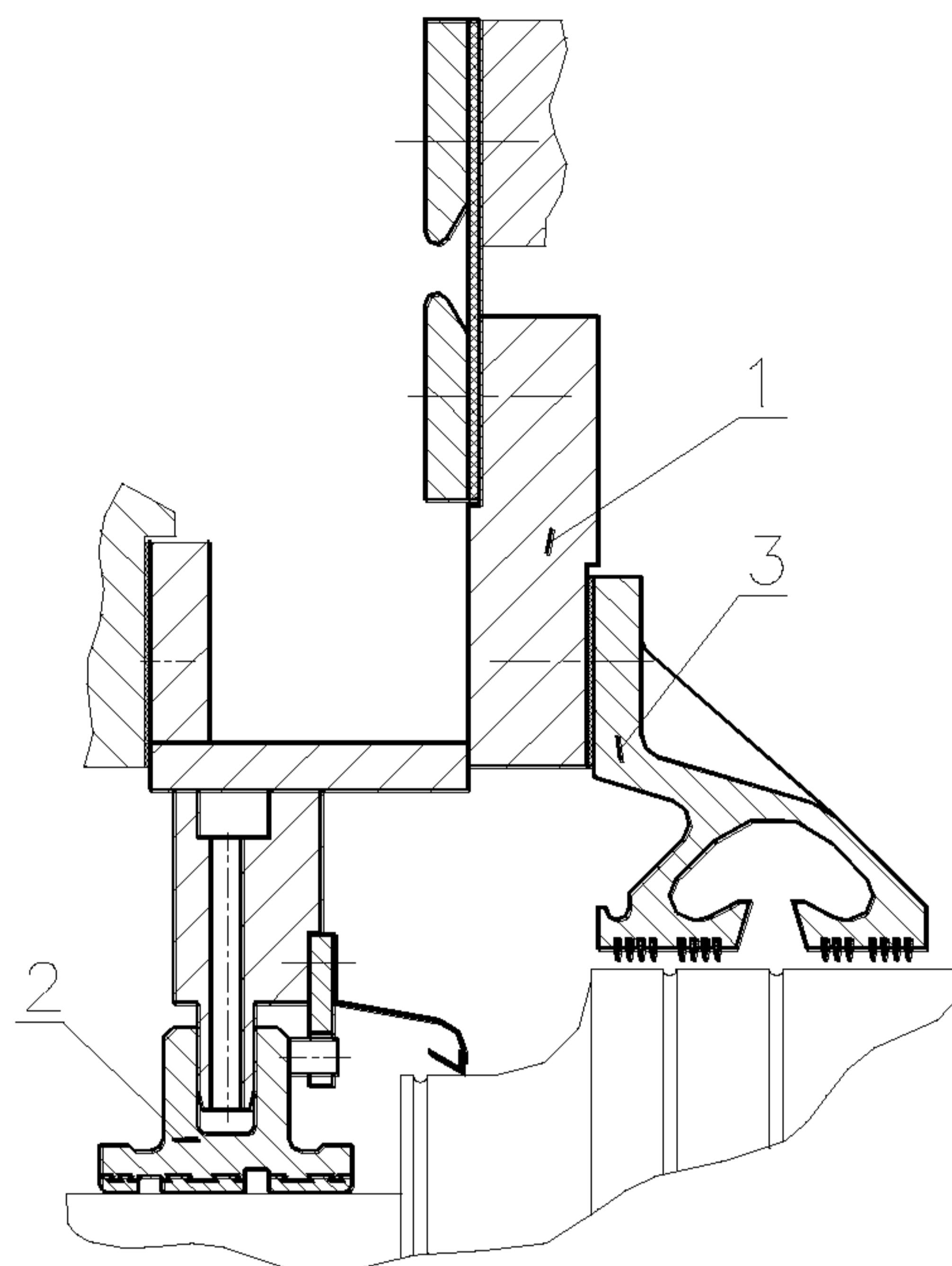
1 – корпус уплотнения; 2 – вкладыш уплотнения; 3 – маслоуловитель.
