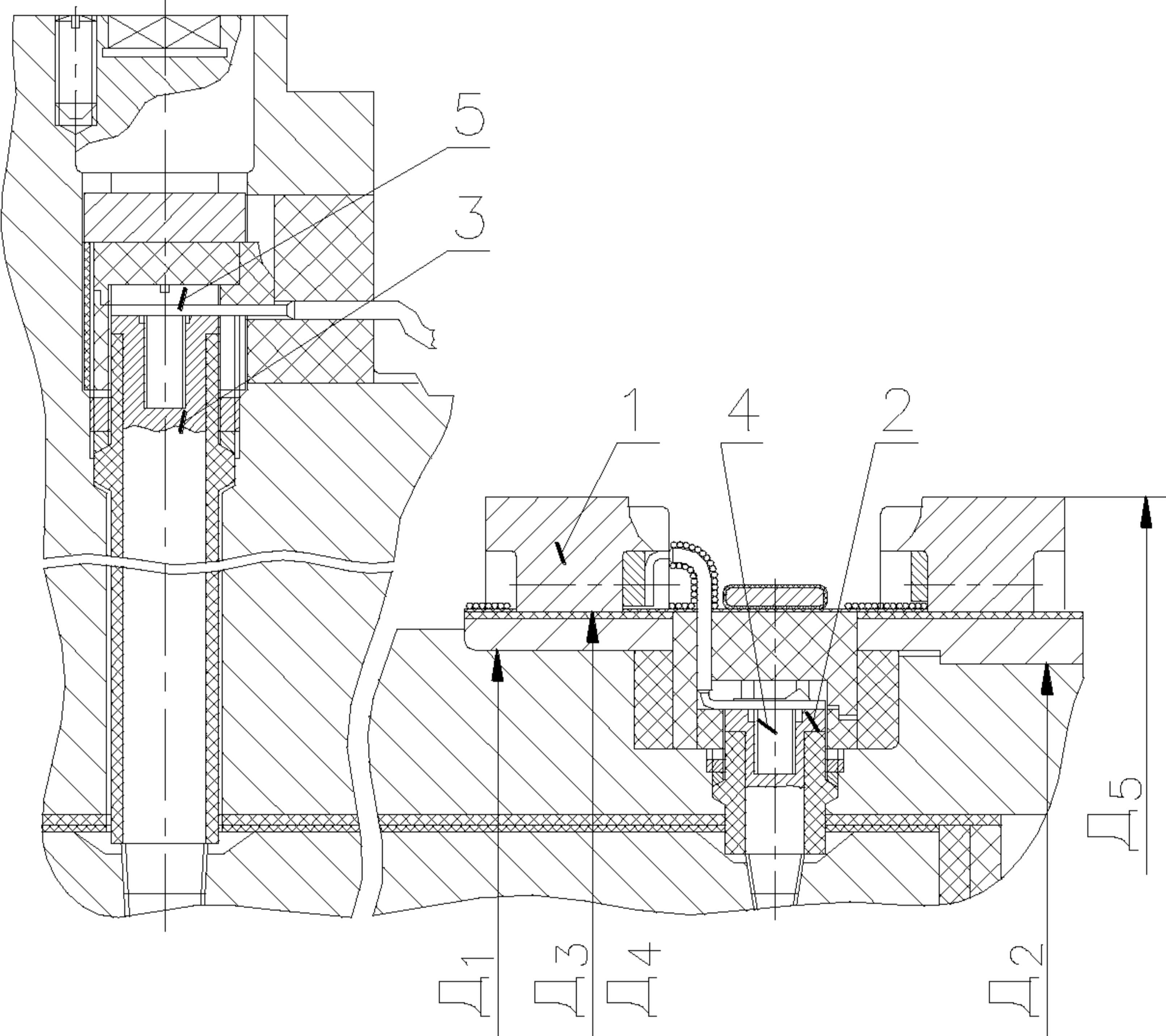
1 – контактное кольцо; 2, 3 – токоведущий болт; 4,5 – контактный винт.
