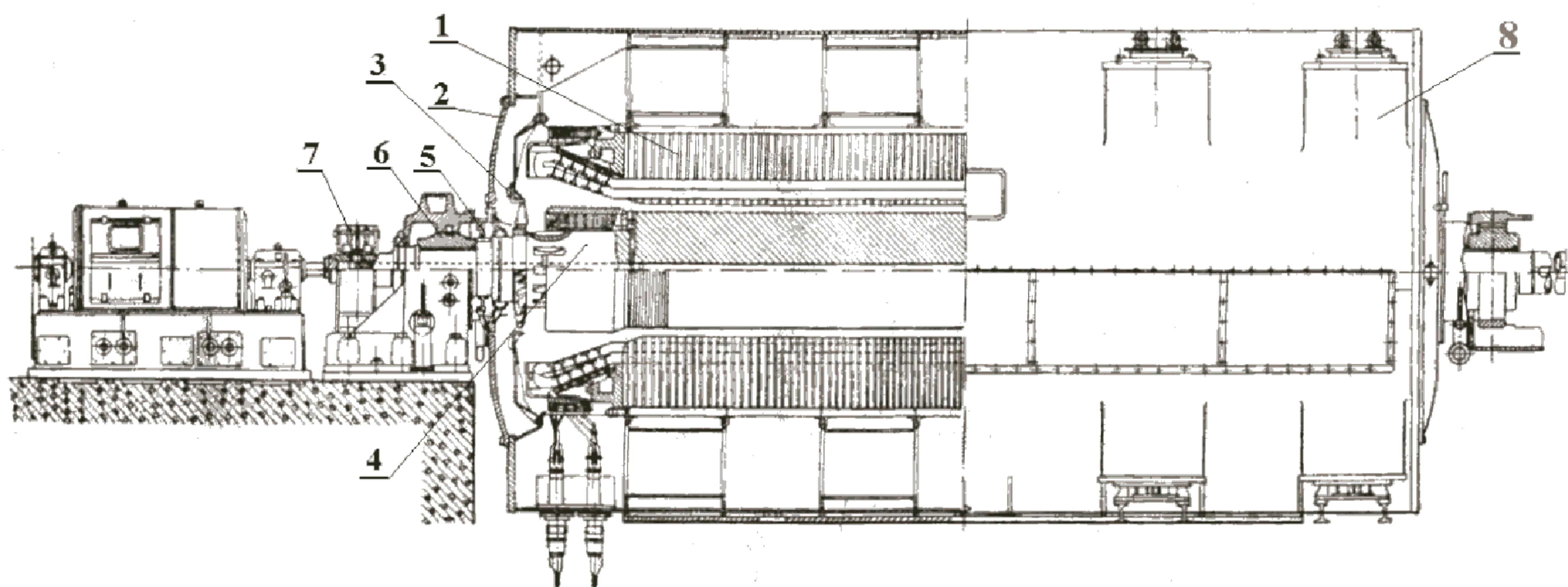
1 – статор; 2 – щит наружный; 3 – обтекатель; 4 – ротор; 5 – уплотнение вала ротора; 6 – подшипник; 7 – щеточный аппарат; 8 – газоохладитель
