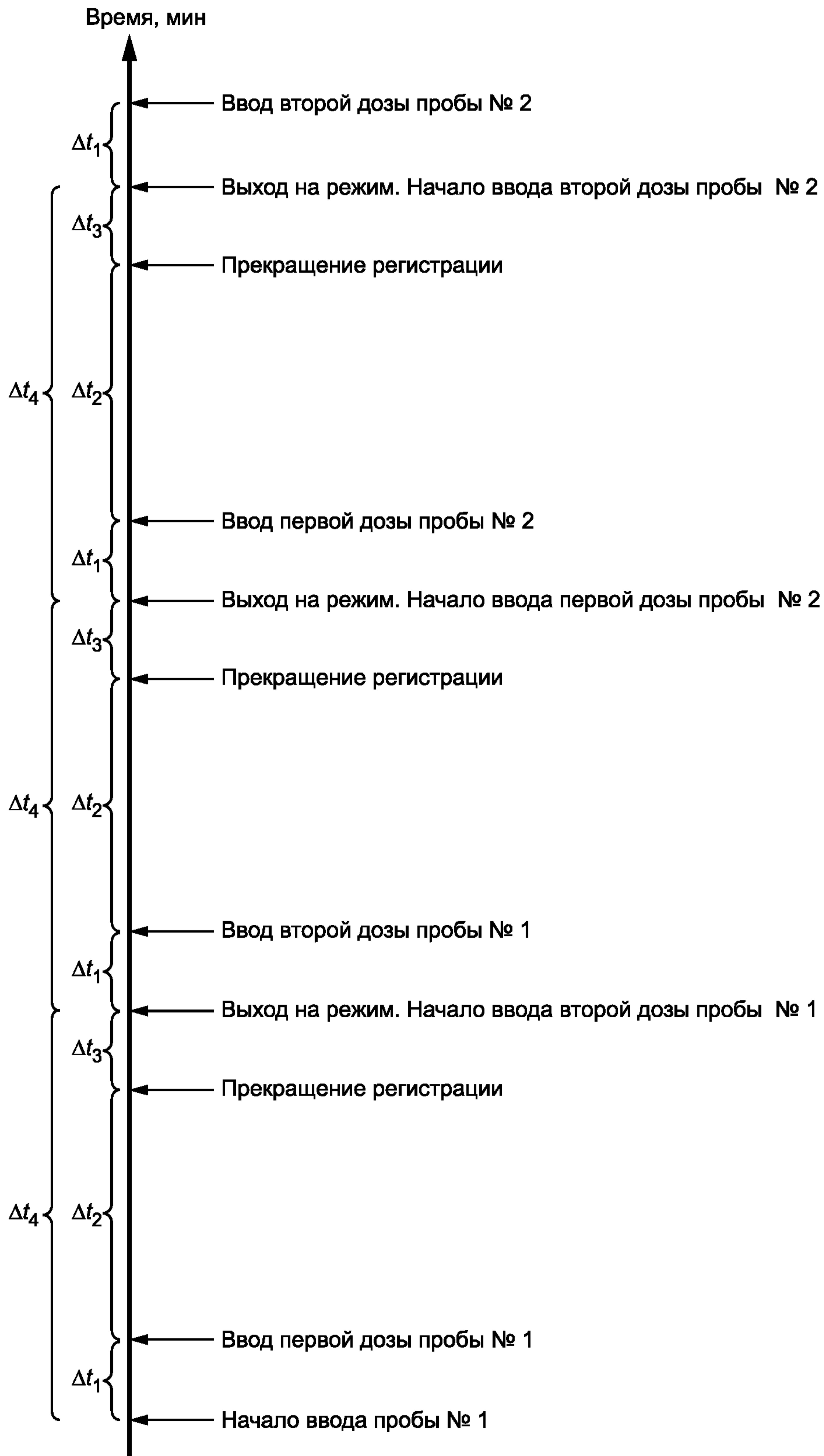
$\Delta t_1$  — период дозирования;  $\Delta t_2$  — время анализа;  $\Delta t_3$  — время выхода на исходный режим;  $\Delta t_4$  — время циклов анализа (около 7 мин)
