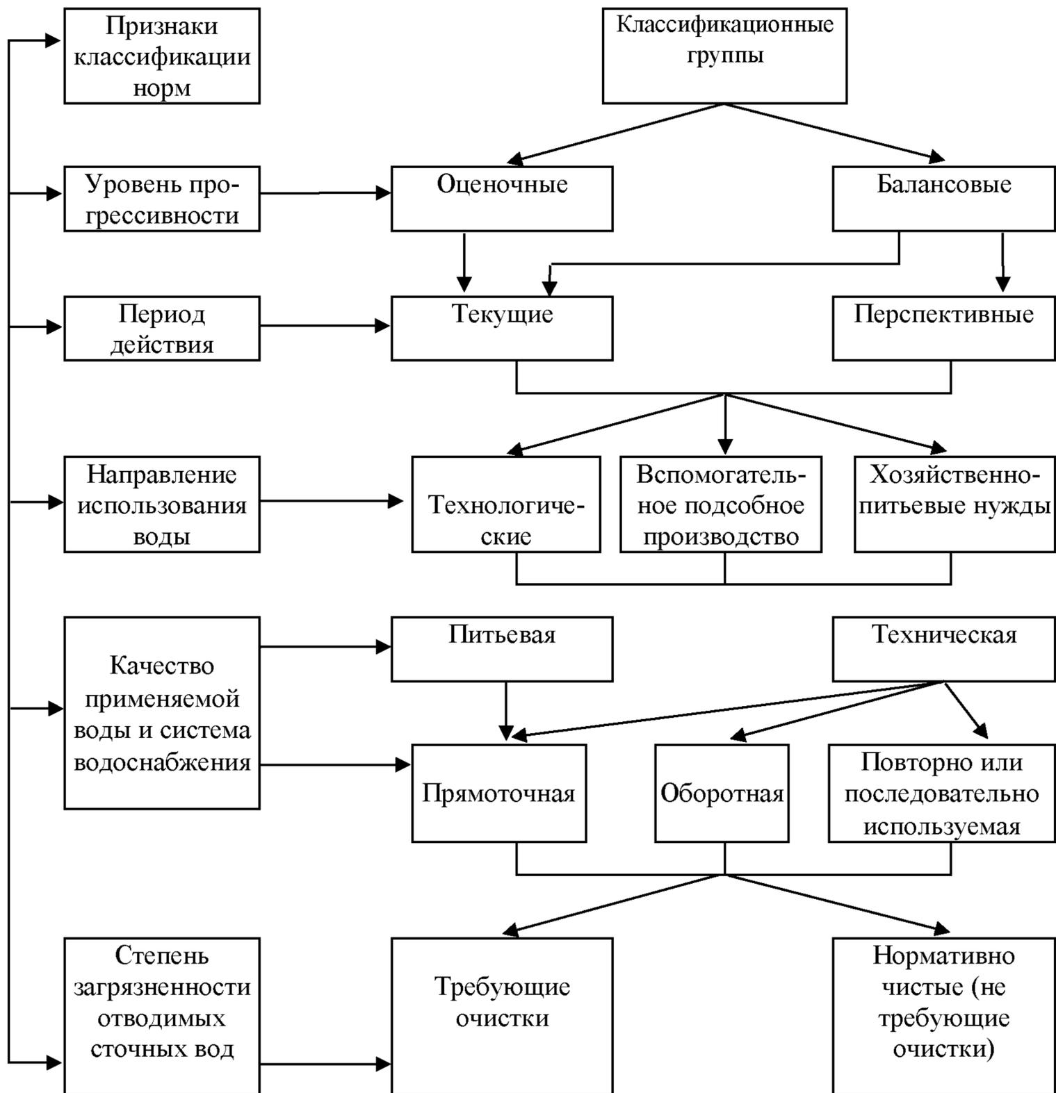
Рисунок 1 - Классификация норм водопотребления и водоотведения на ТЭС
