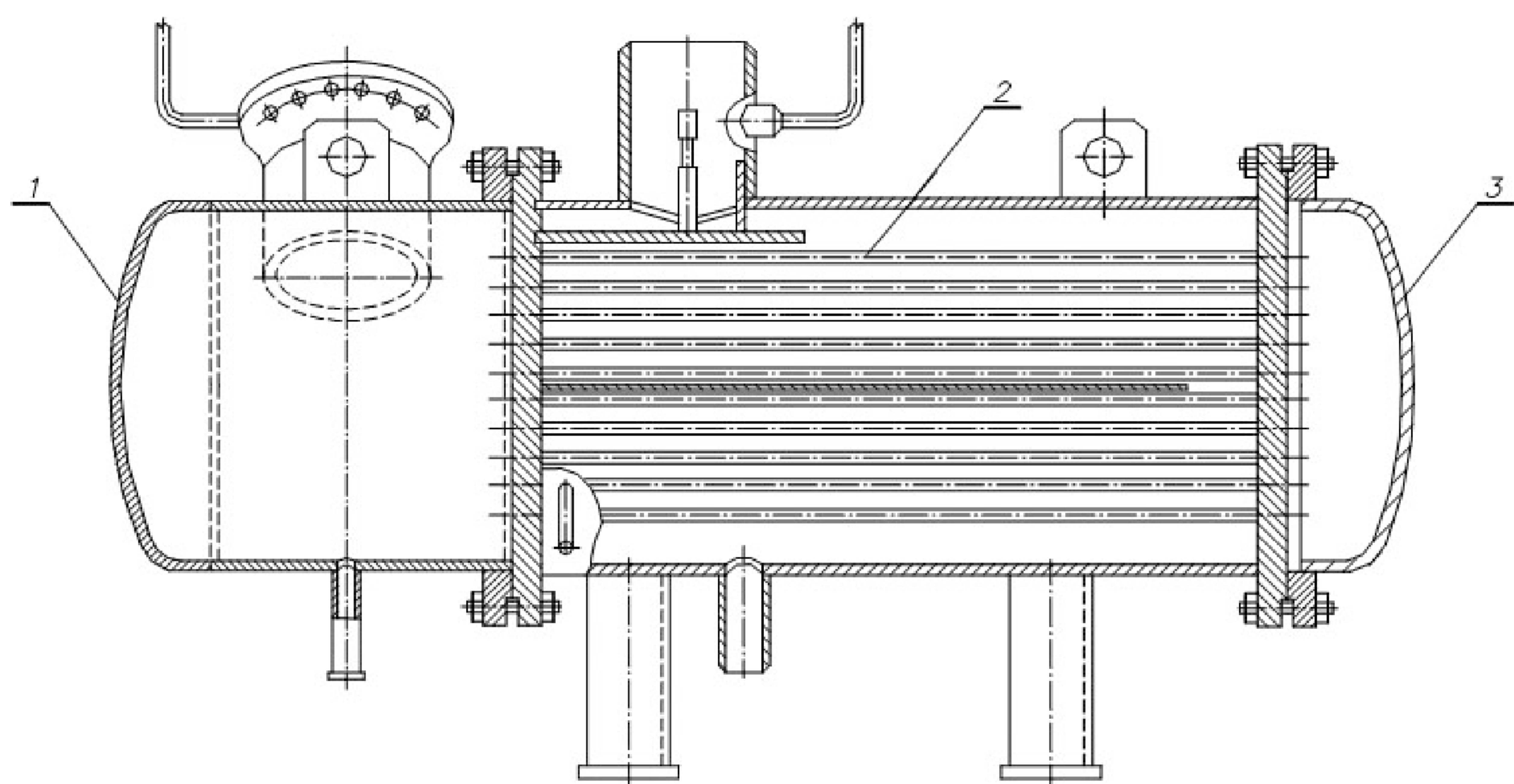
1 – Крышка передняя; 2 – Система трубная; 3 – Крышка задняя
