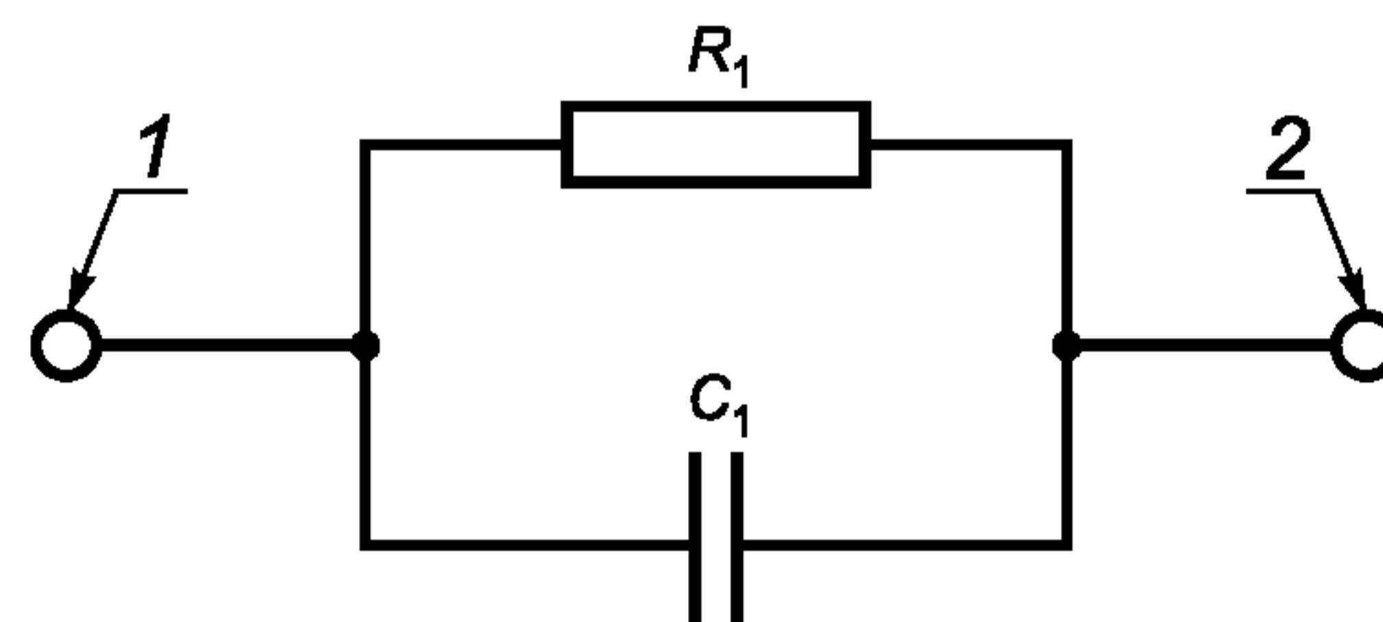
1 и 2 — клеммы для подключения меры;  $R_1$  — мера активного электрического сопротивления;  $C_1$  — мера электрической емкости
