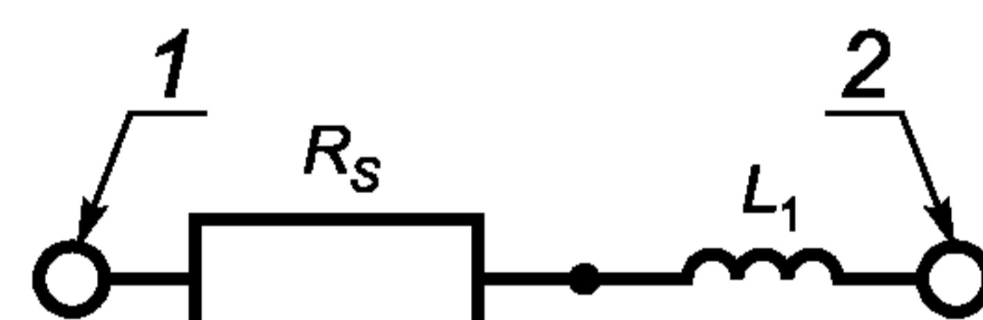
Рисунок В.2 — Составная мера добротности
