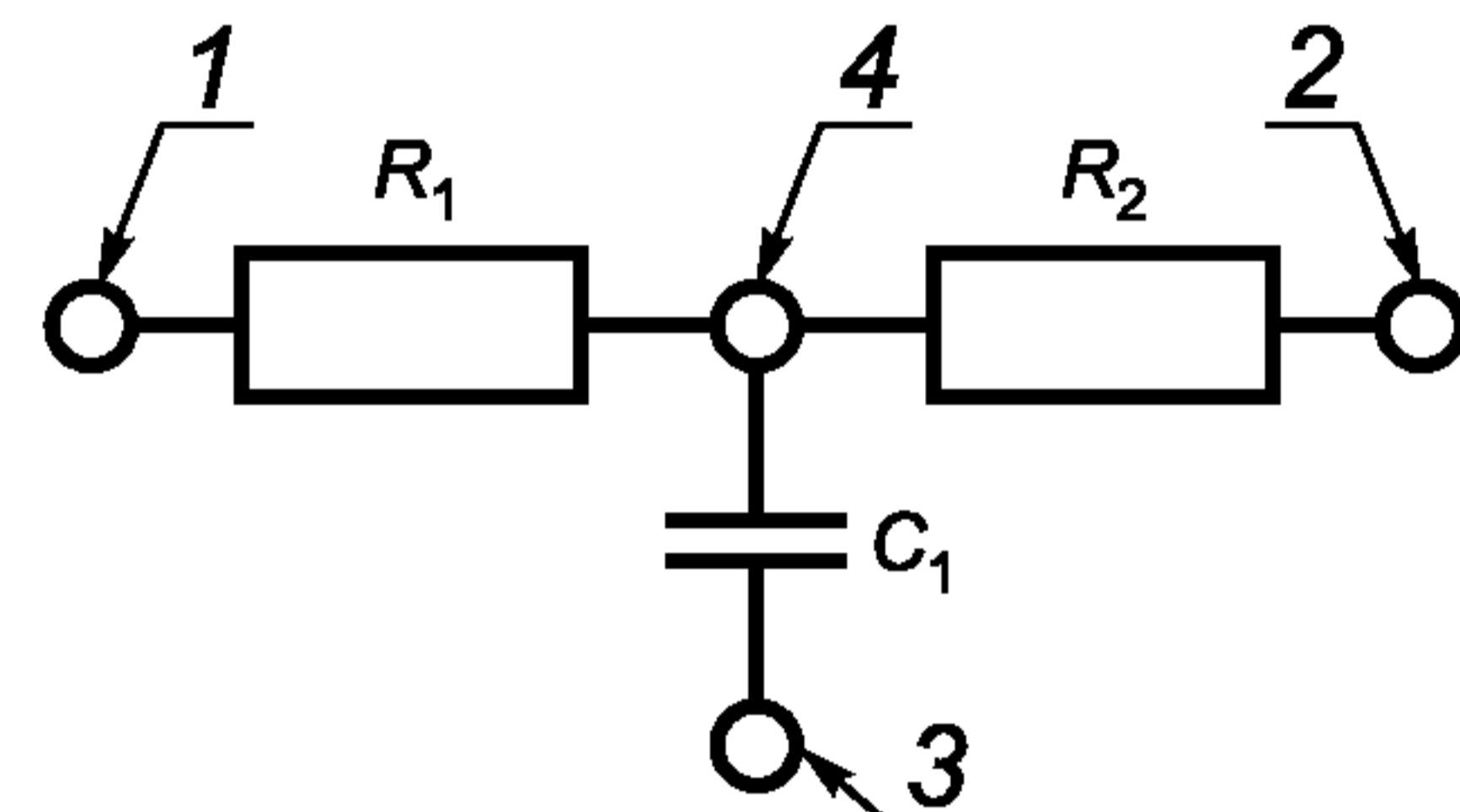
1, 2, 3 и 4 — клеммы для подключения меры;  $R_1$  и  $R_2$  — меры активного сопротивления;  $C_1$  — мера электрической емкости
