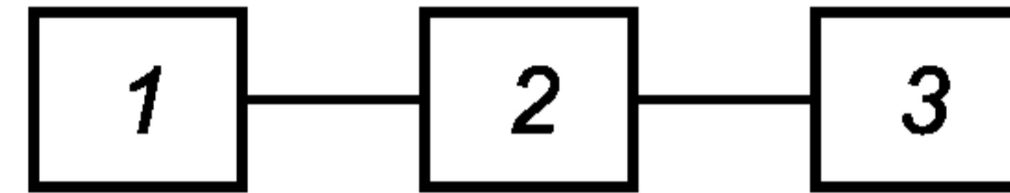
1 — калибратор импульсных напряжений; 2 — коаксиальный измерительный электрический соединитель; 3 — поверяемый вольтметр
