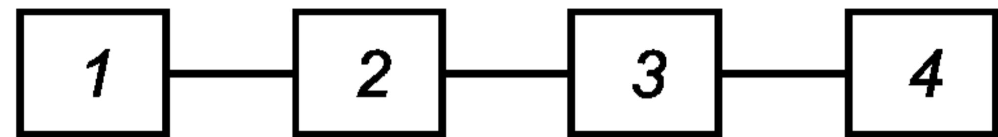
1 — генератор импульсов; 2 — коаксиальная согласованная нагрузка из комплекта генератора; 3 — коаксиальный измерительный электрический соединитель из комплекта поверяемого вольтметра; 4 — поверяемый вольтметр
