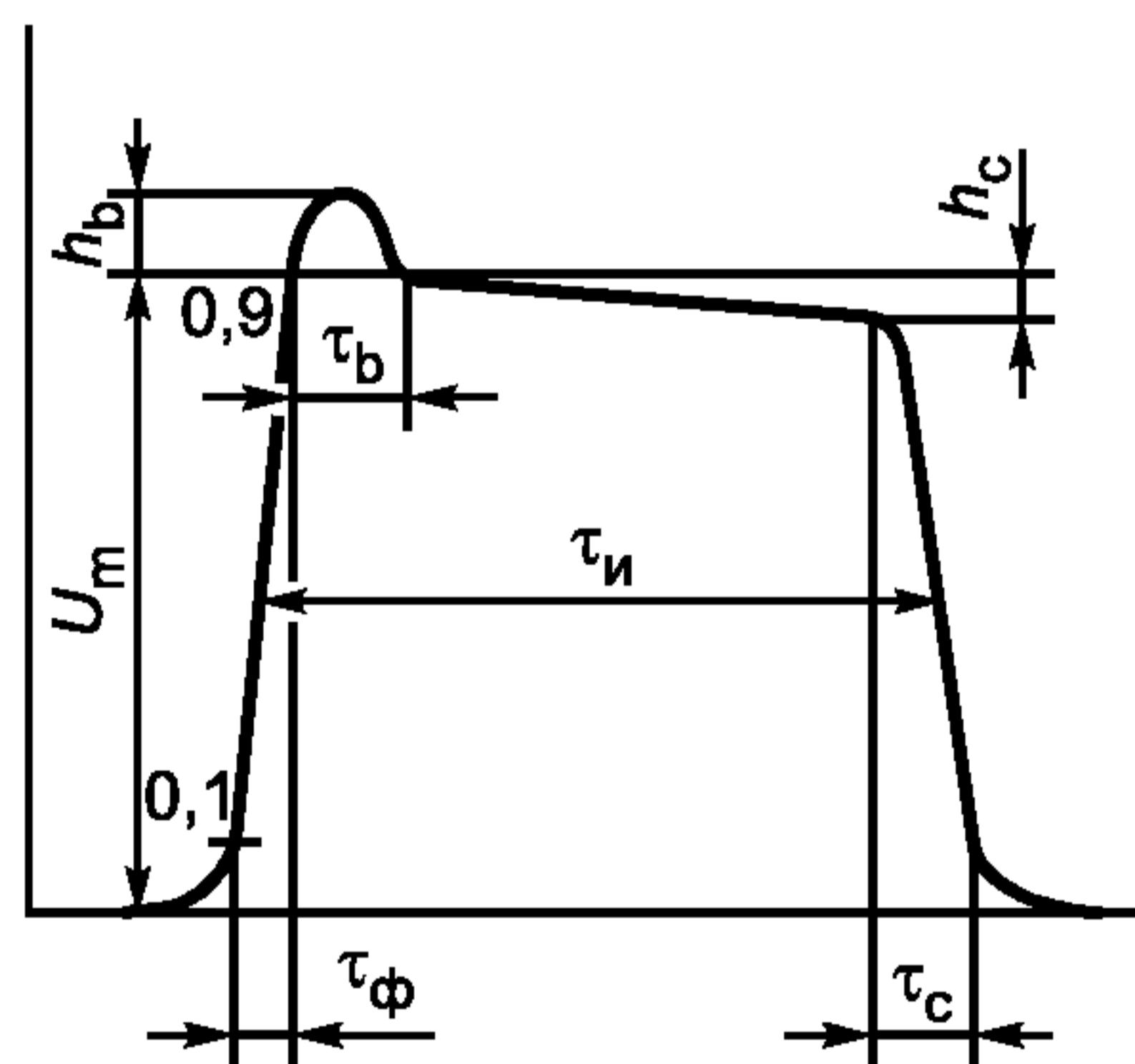
$U_m$  — амплитуда импульса;  $h_b$  — амплитуда выброса;  $h_c$  — глубина спада вершины импульса; 0,1 и 0,9 — уровни отсчета фронта импульса;  $\tau_\phi$  — время нарастания фронта импульса;  $\tau_b$  — длительность выброса;  $\tau_i$  — длительность импульса;  $\tau_c$  — время спада импульса
