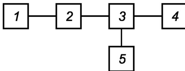
1 — измерительный генератор; 2 — фильтр; 3 — коаксиальный соединитель; 4 — поверяемый вольтметр;
