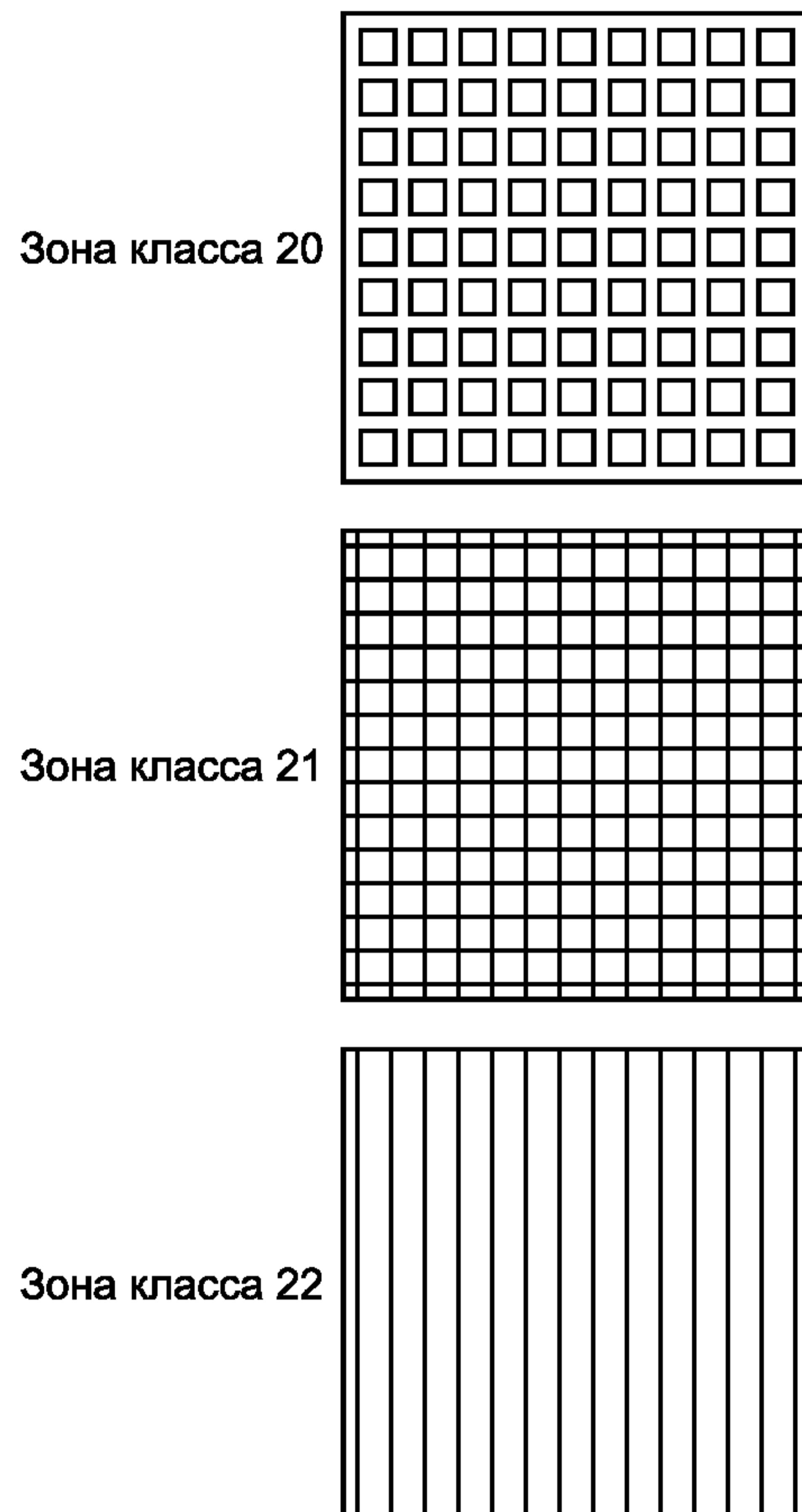
Рисунок 1 — Идентификация зон на чертежах
