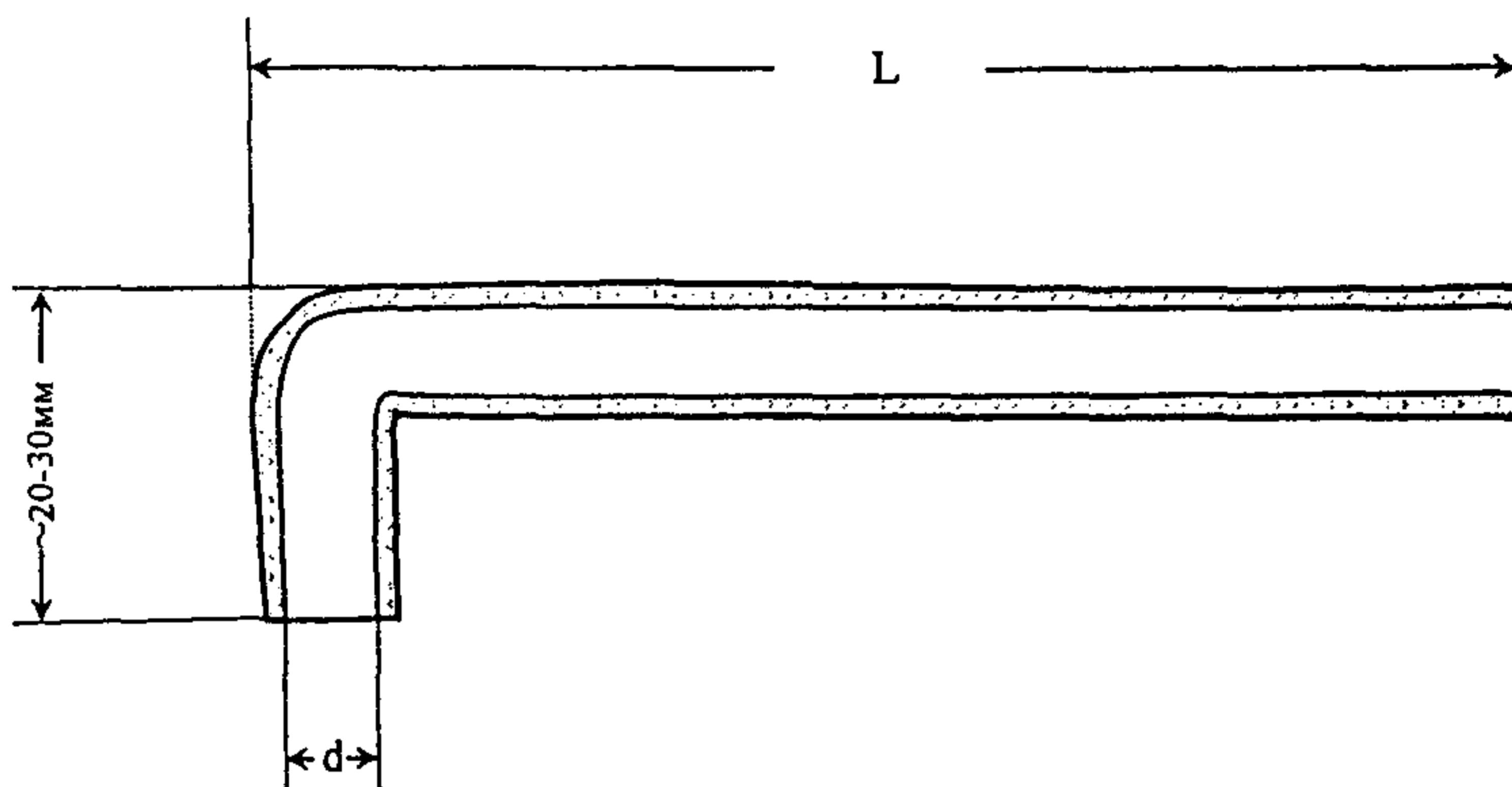
**Рис. 1****Стеклянная газозаборная трубка**
