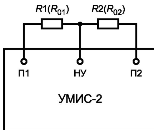
$R_{01}, R_{02}$  — сопротивления меры отношения;  $R1, R2$  — сопротивления делителя;
