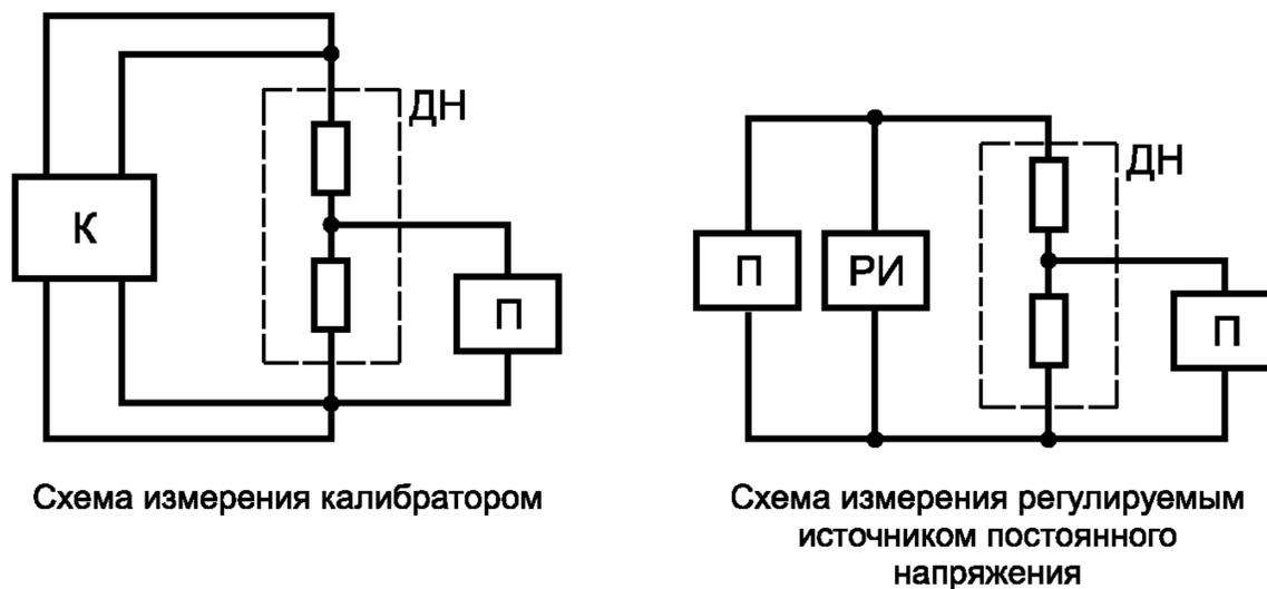
ДН — делитель напряжения; К — эталонная мера постоянного напряжения (калибратор);
