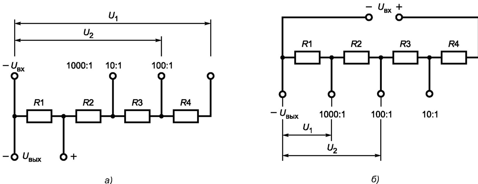
Рисунок 4 — Схема проверки делителя напряжения методом опорного напряжения
