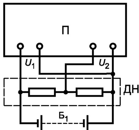
ДН — делитель напряжения; П — потенциометр постоянного тока; Б<sub>1</sub> — источник питания
