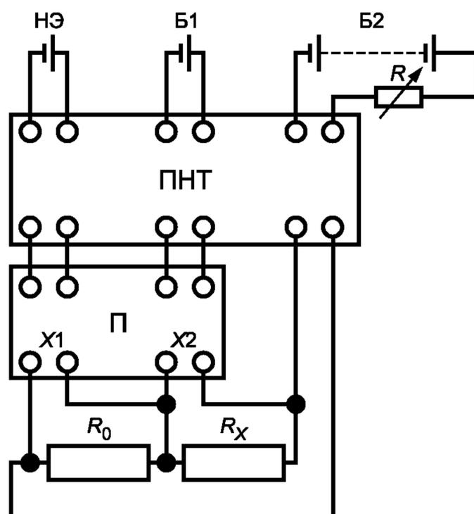
П — потенциометр постоянного тока; ПНТ — переключатель направления тока;  $R_0$  — эталонная мера сопротивления;  $R_x$  — измеряемое сопротивление;  $R$  — регулировочный магазин сопротивлений; НЭ — нормальный элемент; Б1, Б2 — источники питания; X1, X2 — зажимы потенциометра
