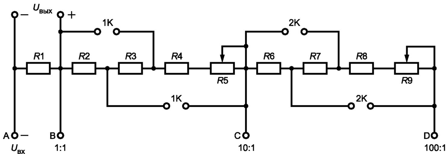
$U_{вх}$  — входное напряжение;  $U_{вых}$  — выходное напряжение; А, В, С, D — клеммы подключения;
