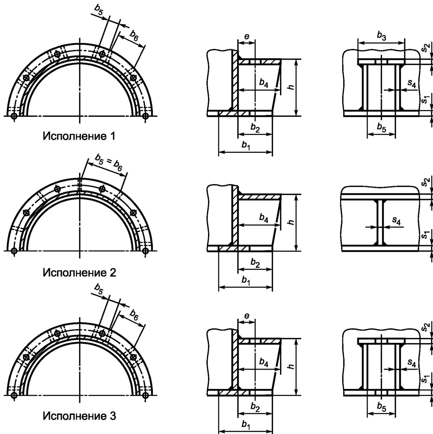
Рисунок 6 — Конструкции опорных узлов
