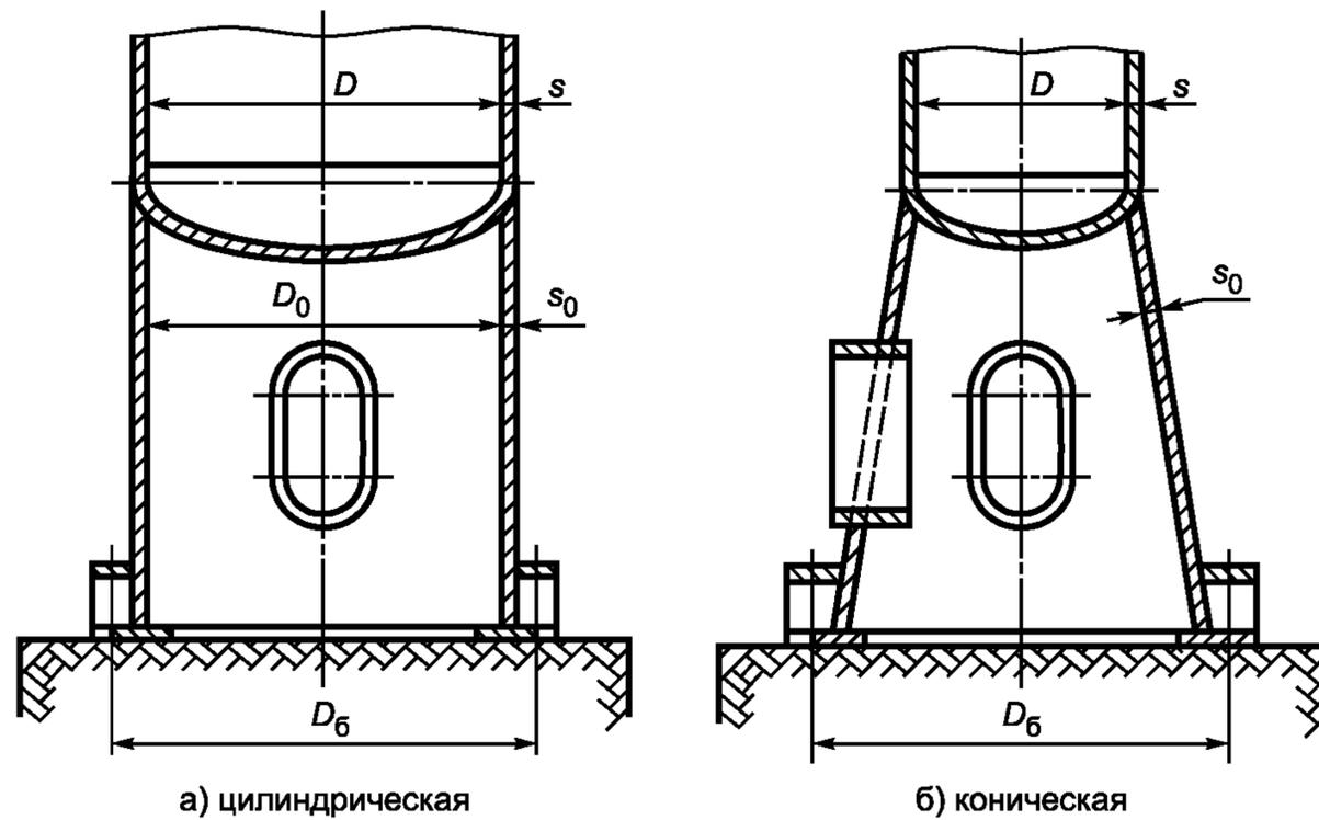
Рисунок 4 — Основные конструкции вертикальных опор аппаратов
