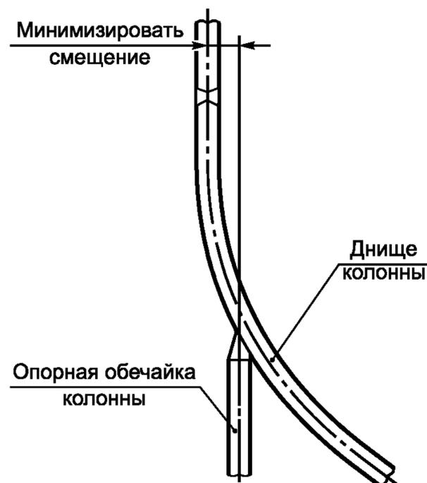
Рисунок 5 — Узел стыковки опорной обечайки и днища аппарата
