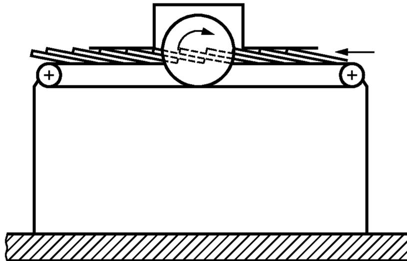
Рисунок 12 — Машина резальная ротационная
