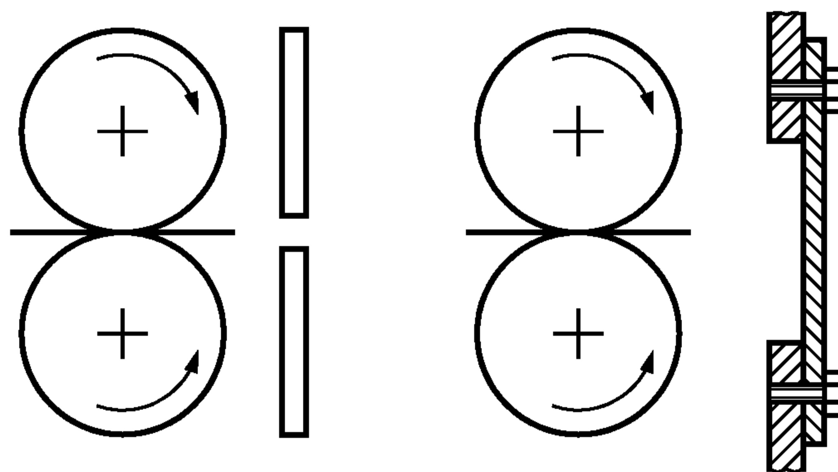
Рисунок 2 — Средства защиты мест затягивания
