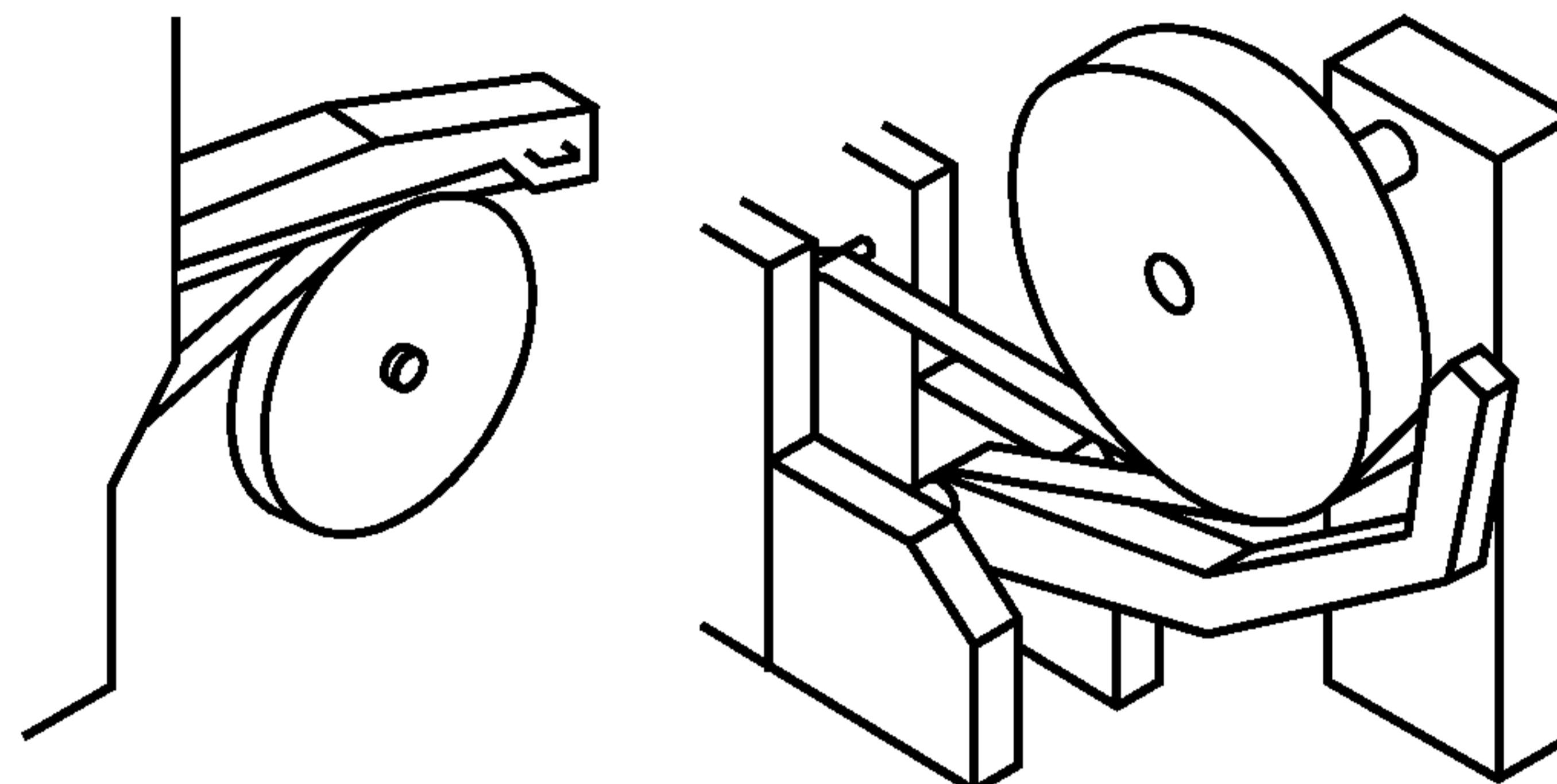
Рисунок 10 — Ременные приводы
