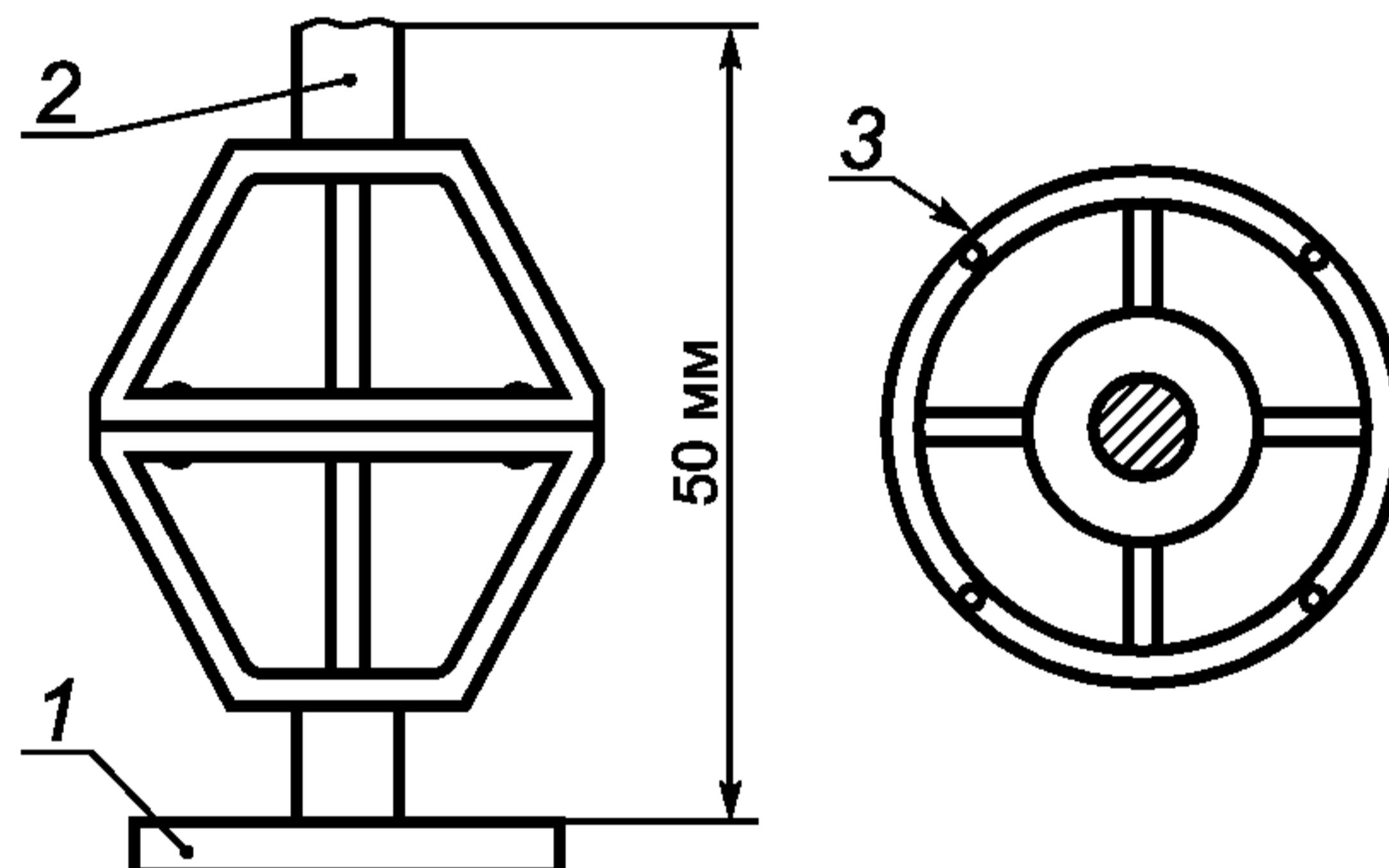
1 — электродвигатель привода; 2 — мешалка; 3 — вид сверху
