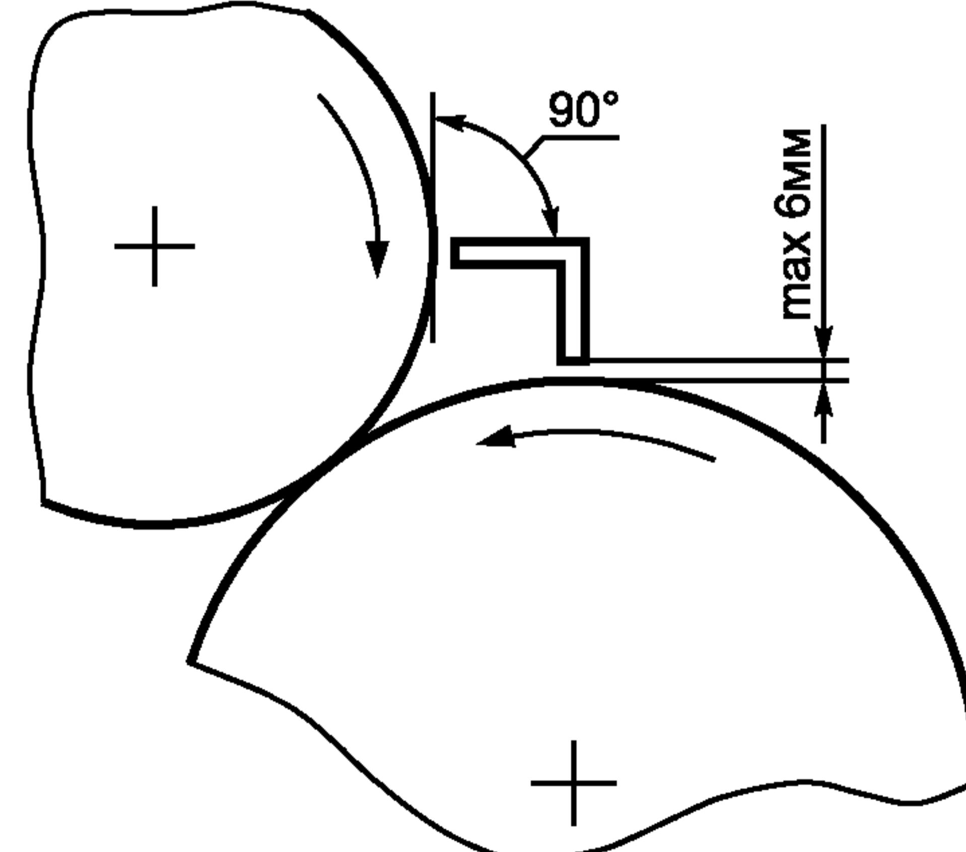
Рисунок 3 — Защита места затягивания с помощью неподвижной планки
