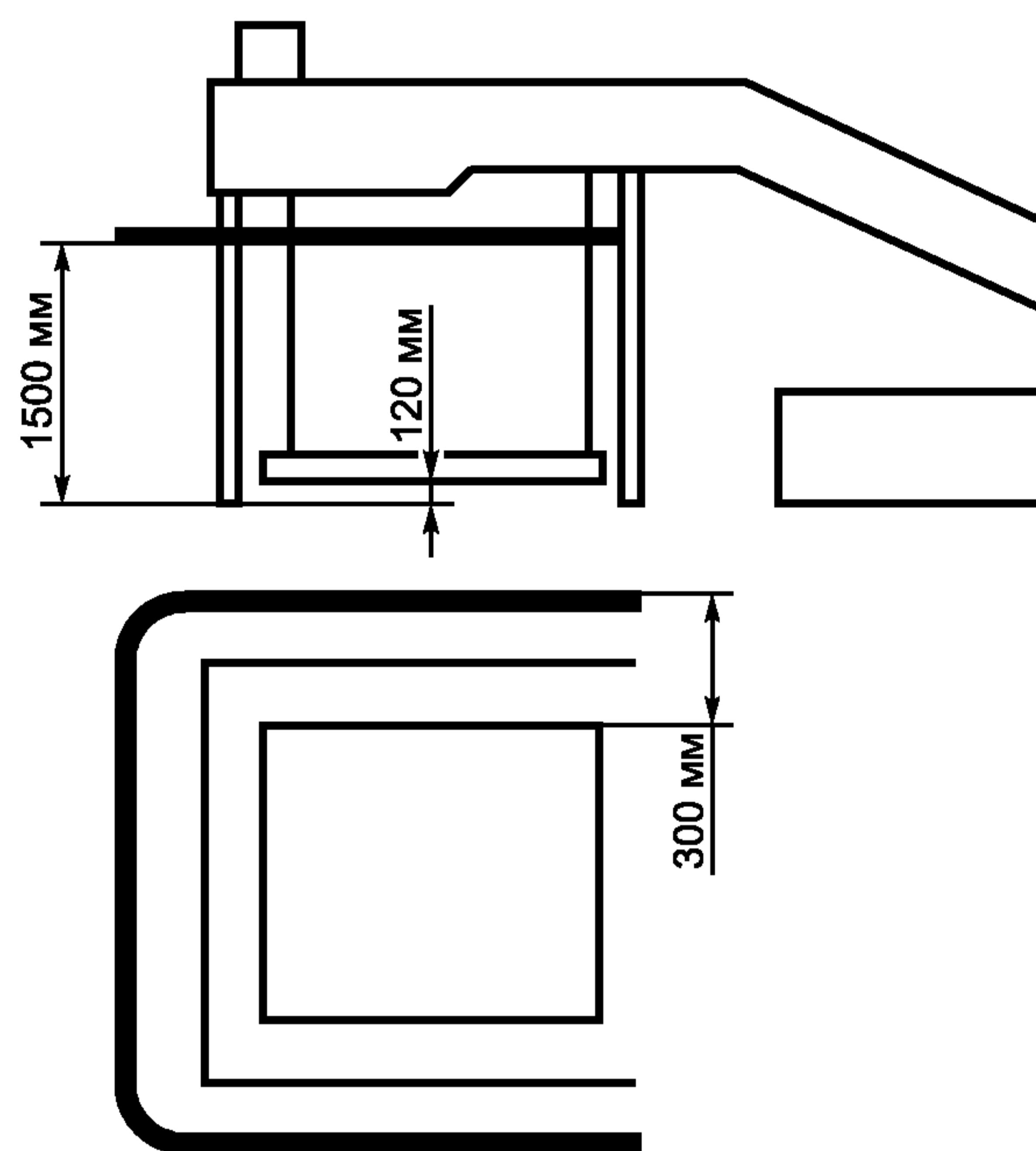
Рисунок 7 — Защита отклоняющимися частями станины машины
