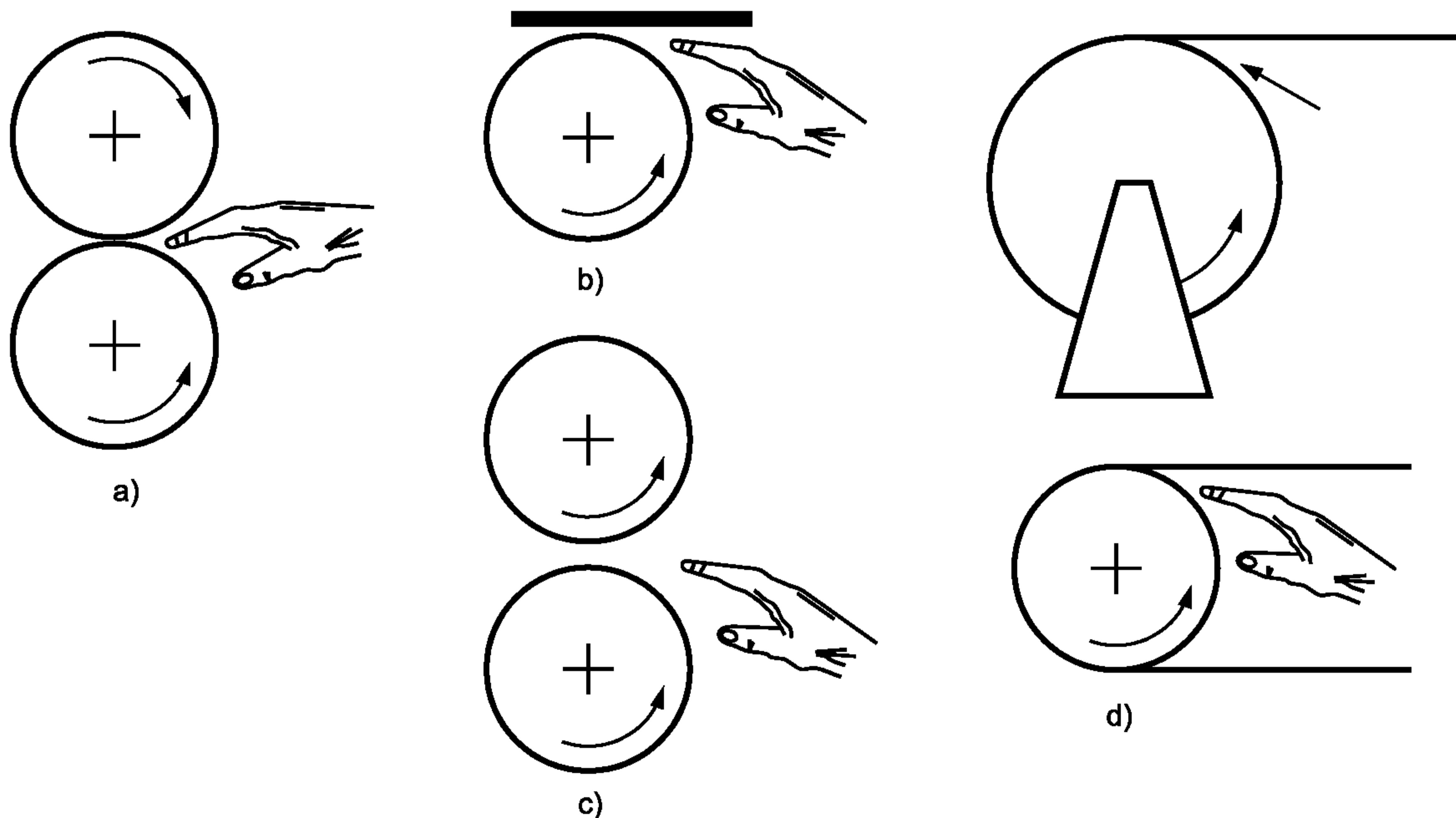
Рисунок 1 — Примеры мест затягивания
