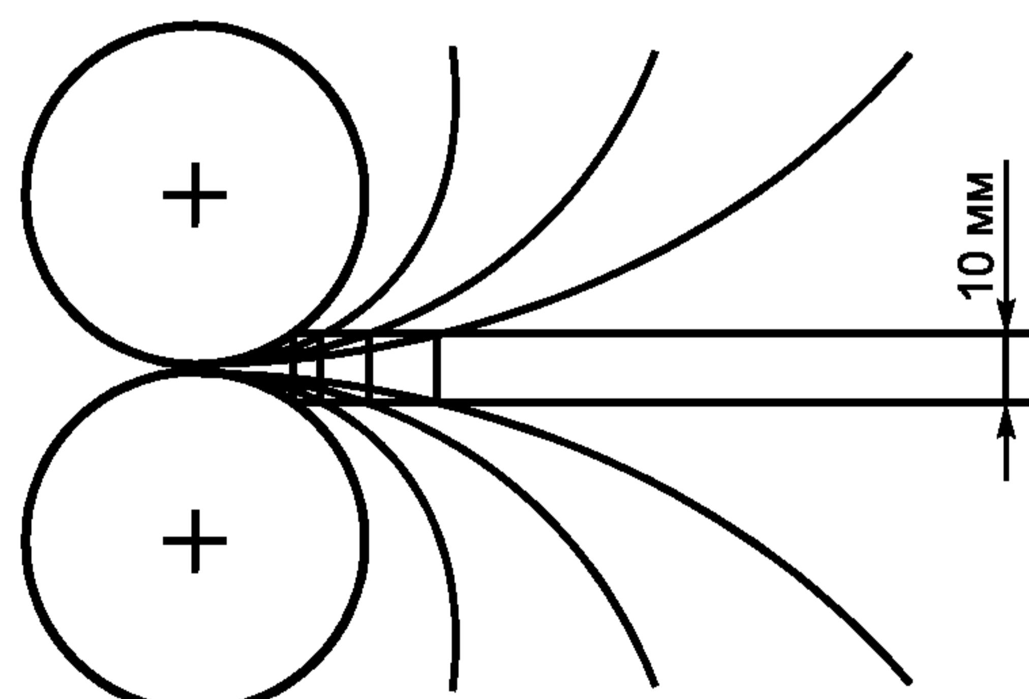
Рисунок 12 — Измерение безопасного расстояния в местах затягивания
