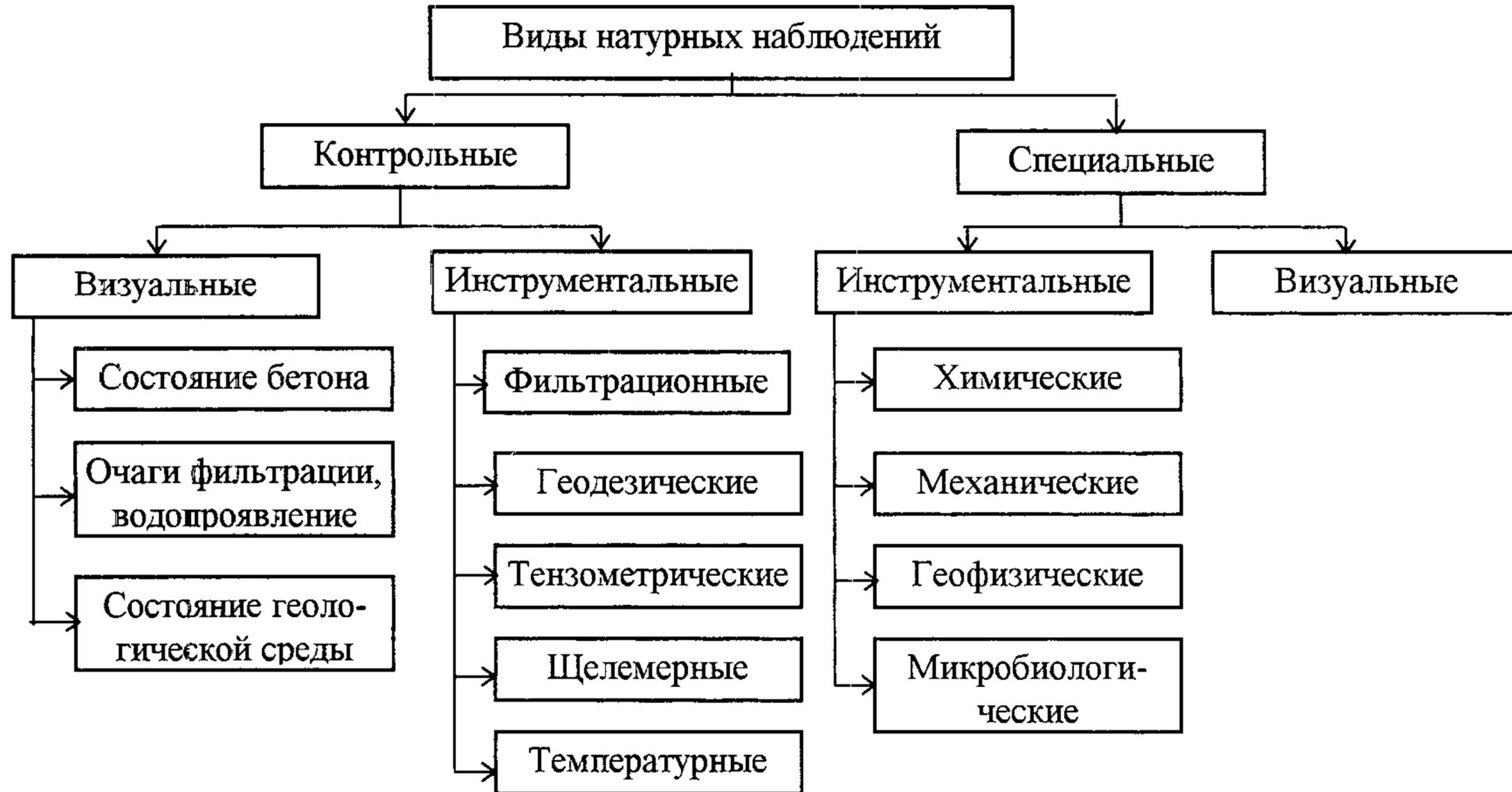
Схема 1. Виды натуральных наблюдений на бетонных плотинах
