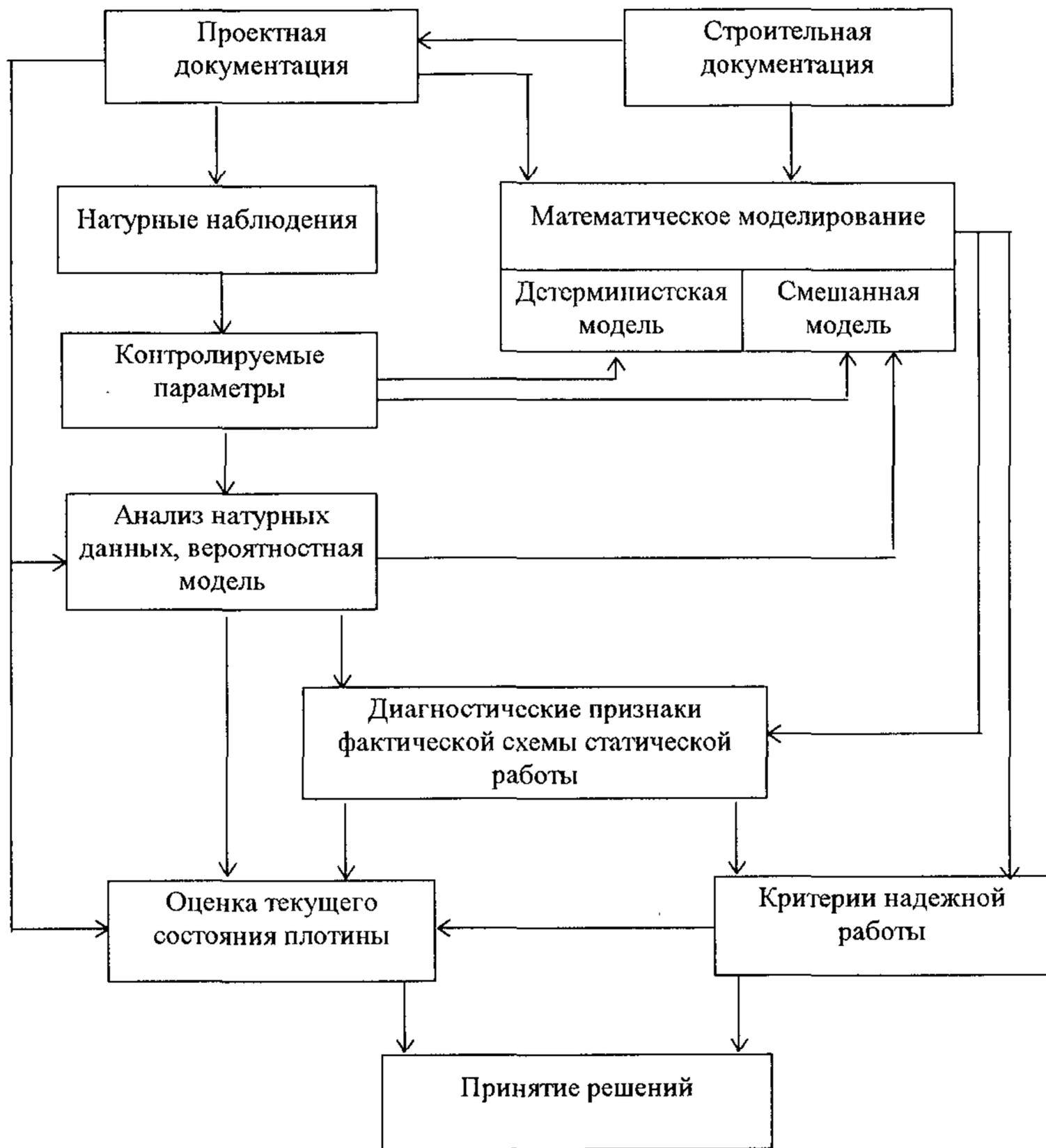
Схема 2. Диагностика надежной работы бетонных плотин
