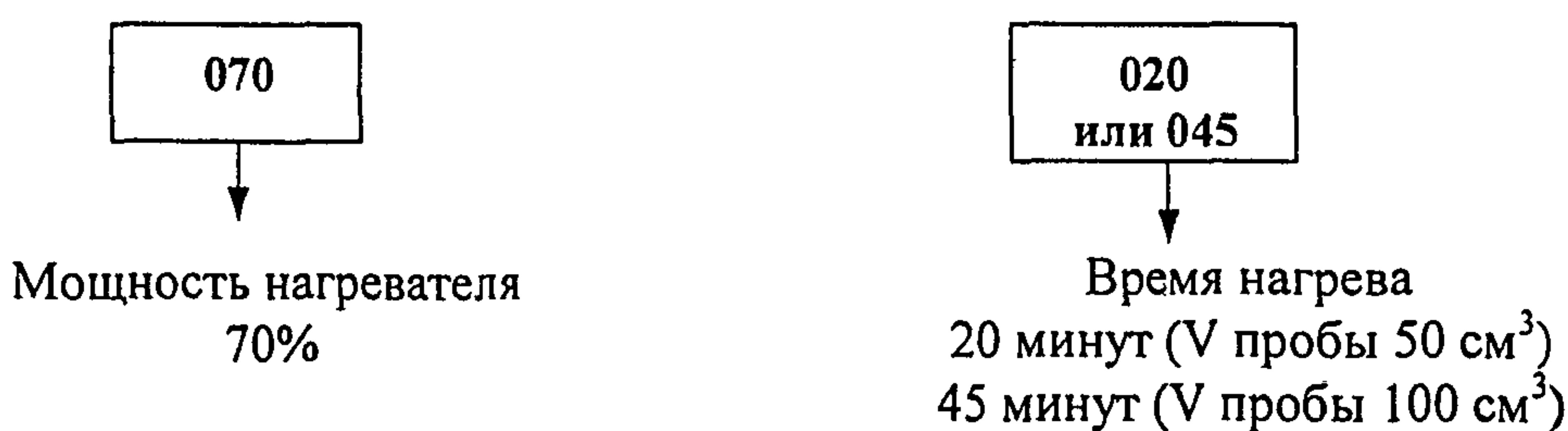
На второй стадии нагревания следует понизить мощность нагревателя до 50 % - 70 %, в зависимости от интенсивности кипения. Для изменения мощности и времени нагревания поступают в соответствии с п.4 (Б).
