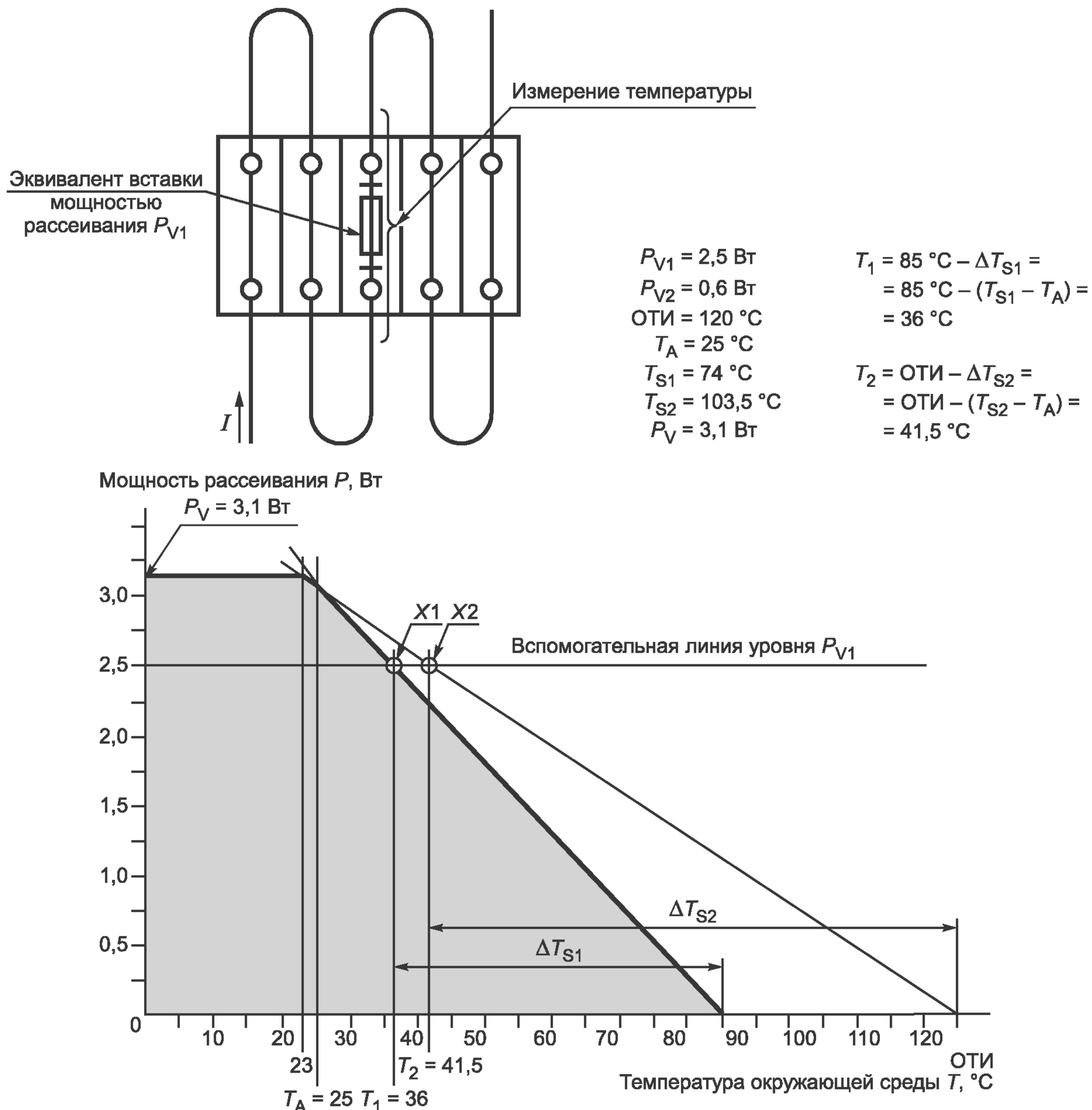
$P_{V1}$  — максимальная мощность рассеивания держателя плавкой вставки в условиях перегрузки;
