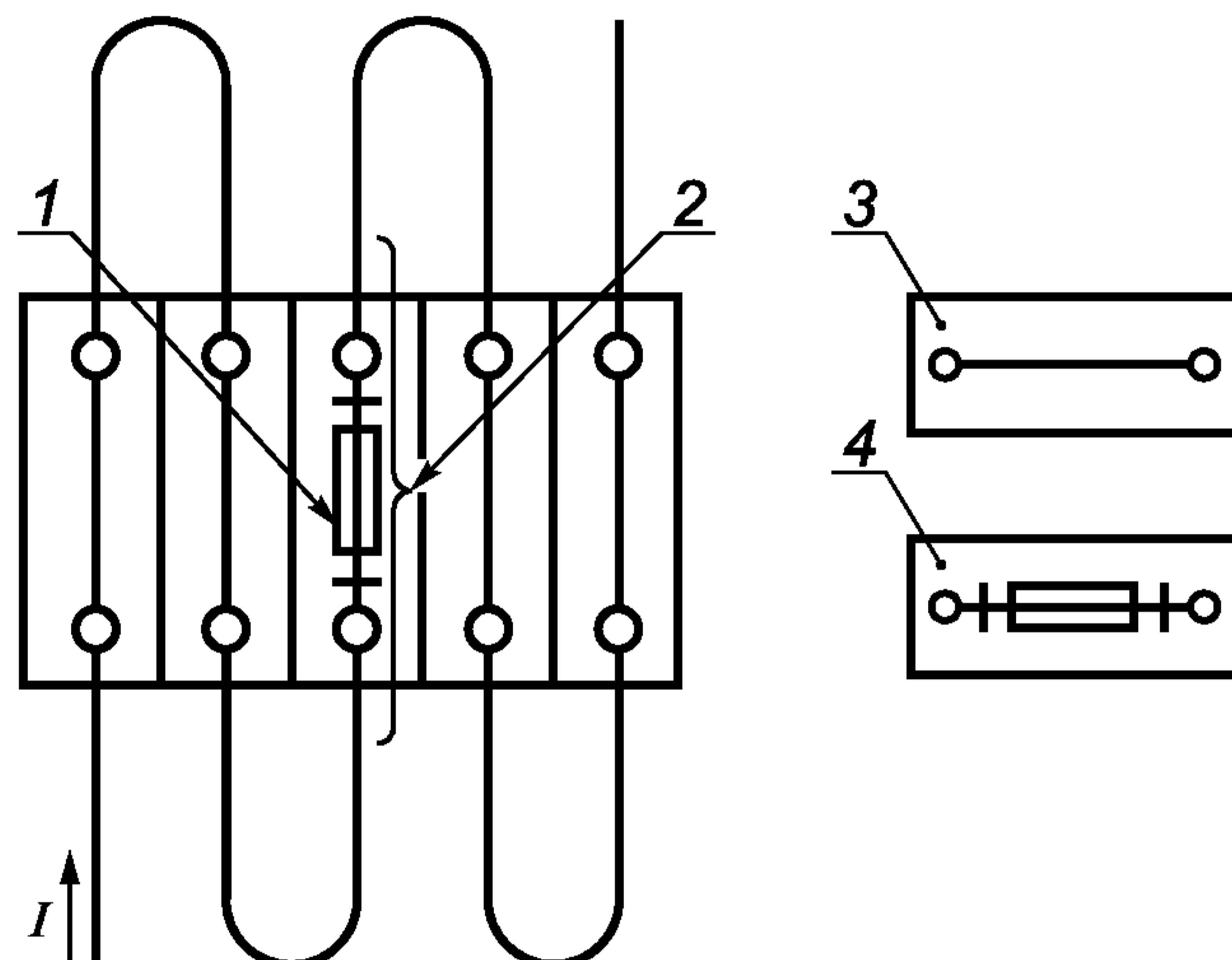
1 — эквивалент плавкой вставки; 2 — место измерения температуры; 3 — закороченная на проход колодка;
