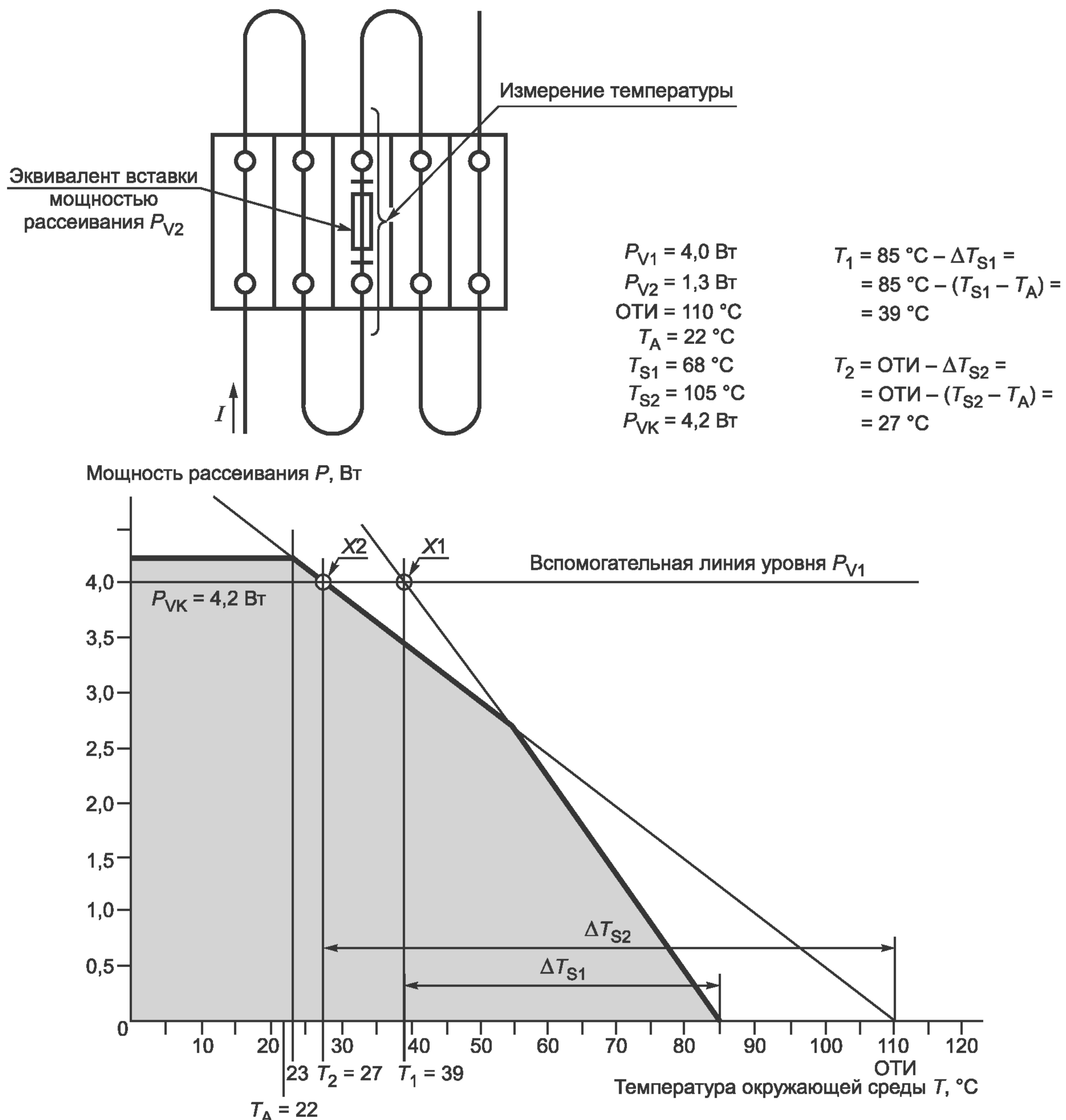
$P_{V1}$  — максимальная мощность рассеивания держателя плавкой вставки в условиях перегрузки;
