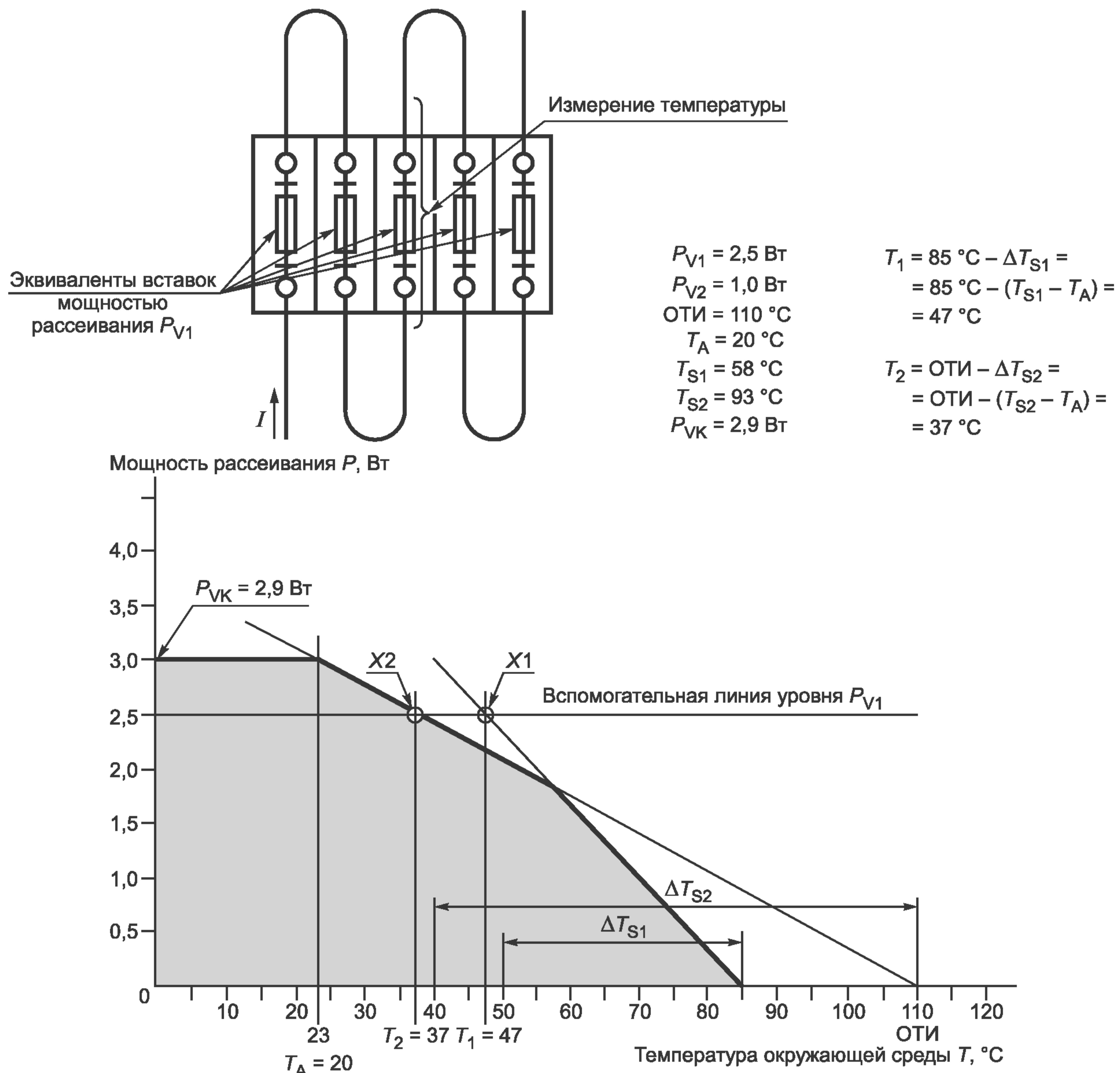
$P_{V1}$  — максимальная мощность рассеивания держателя плавкой вставки в условиях перегрузки;
