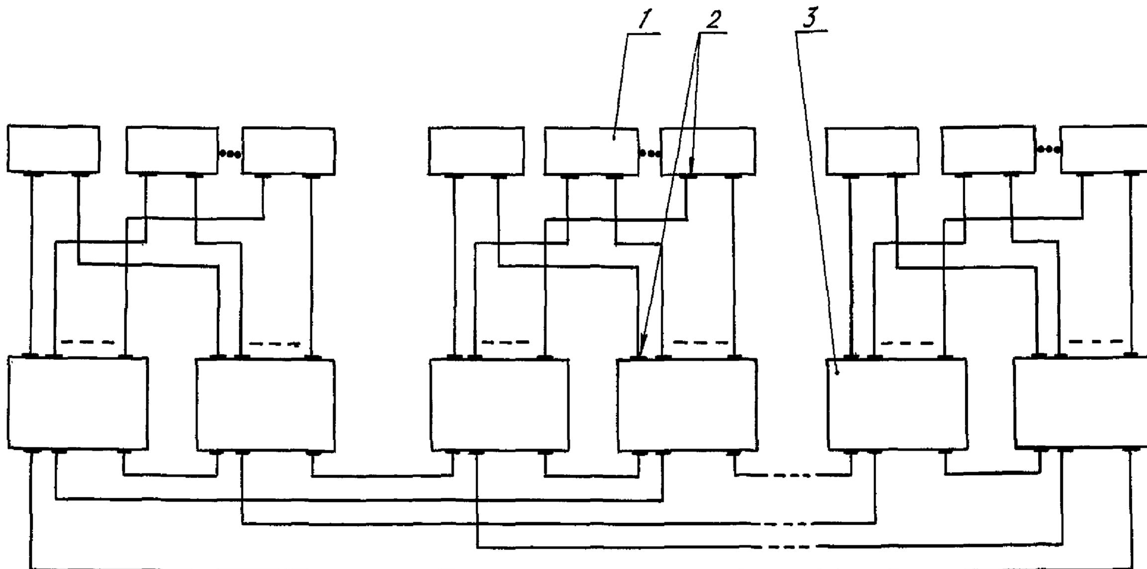
1 - приемно-передающий оптоэлектронный модуль; 2 - оптический соединитель; 3 - звездообразный оптический разветвитель проходного типа
