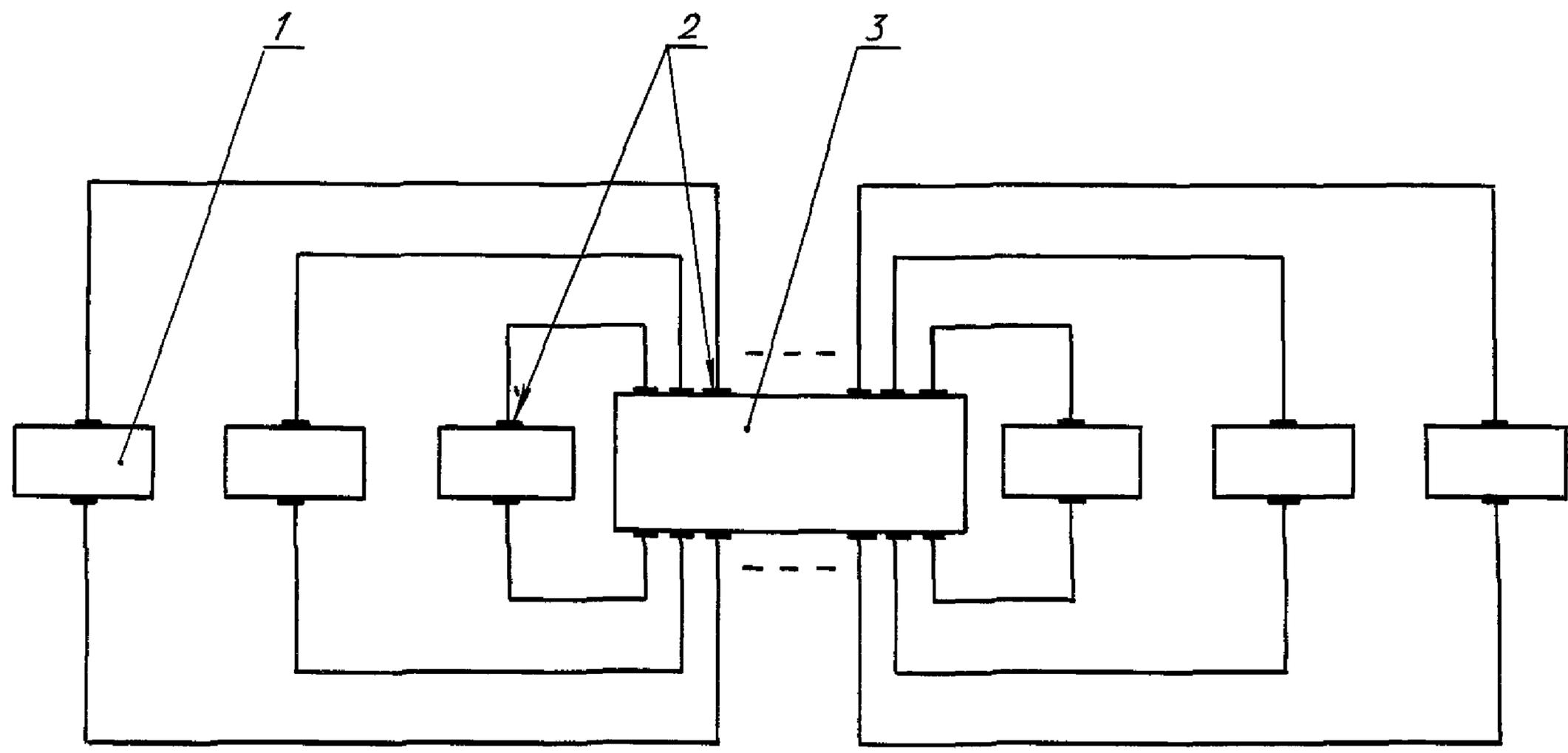
1 - приемно-передающий оптоэлектронный модуль; 2 - оптический соединитель; 3 - звездообразный оптический разветвитель проходного типа
