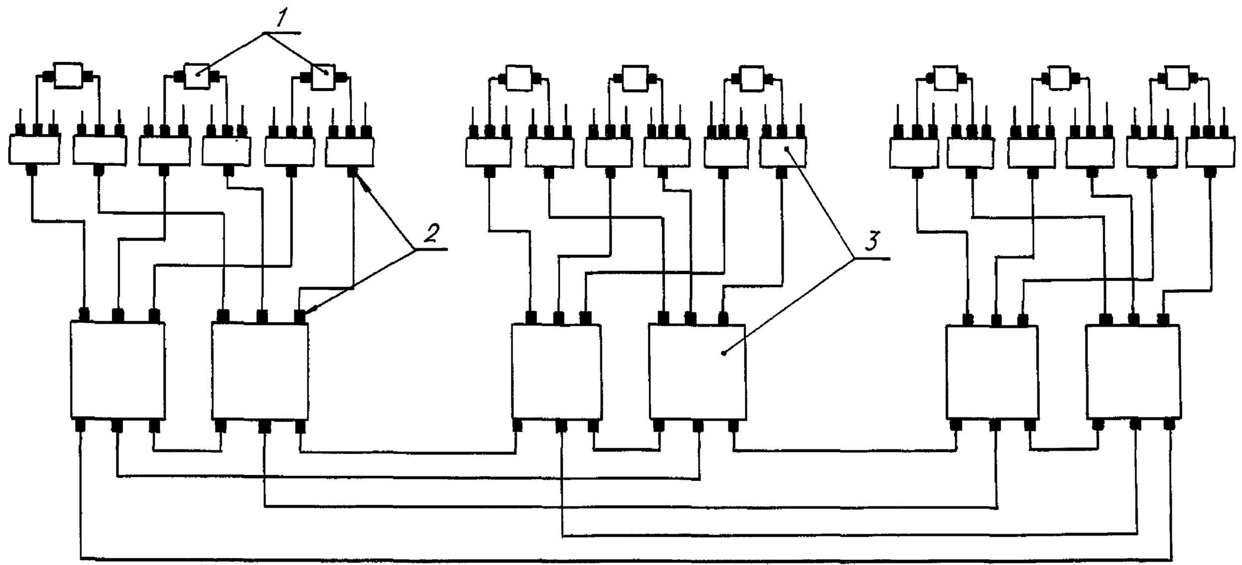
1 - приемо-передающий оптоэлектронный модуль; 2 - оптический соединитель; 3 - малоканальный оптический разветвитель
