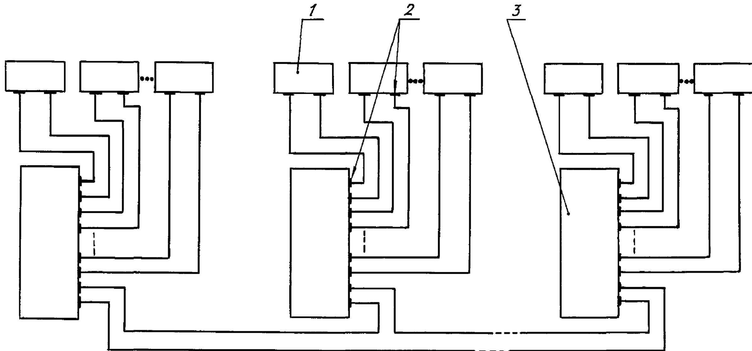
1 - приемо-передающий оптоэлектронный модуль; 2 - оптический соединитель; 3 - звездо-образный оптический разветвитель отражательного типа
