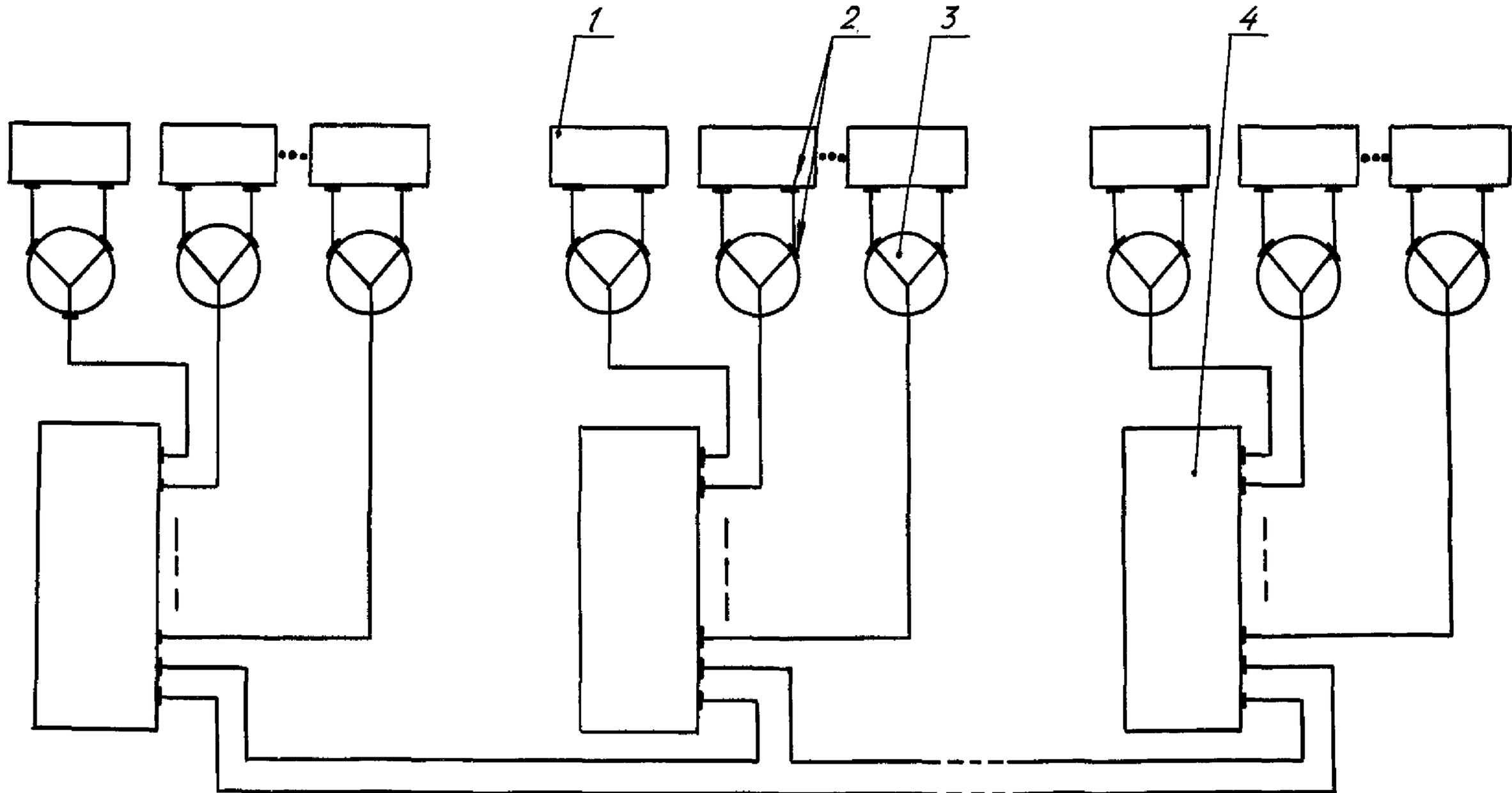
1 - приемно-передающий оптоэлектронный модуль; 2 - оптический соединитель; 3 - Y-образный оптический разветвитель; 4 - звездообразный оптический разветвитель отражательного типа
