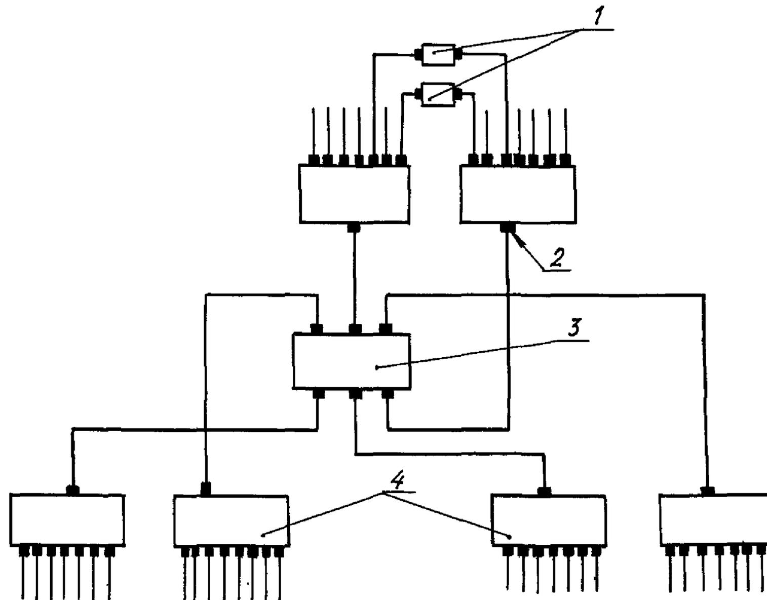
1 - приемо-передающий оптоэлектронный модуль; 2 - оптический соединитель; 3 - малоканальный оптический разветвитель; 4 - многоканальный оптический разветвитель
