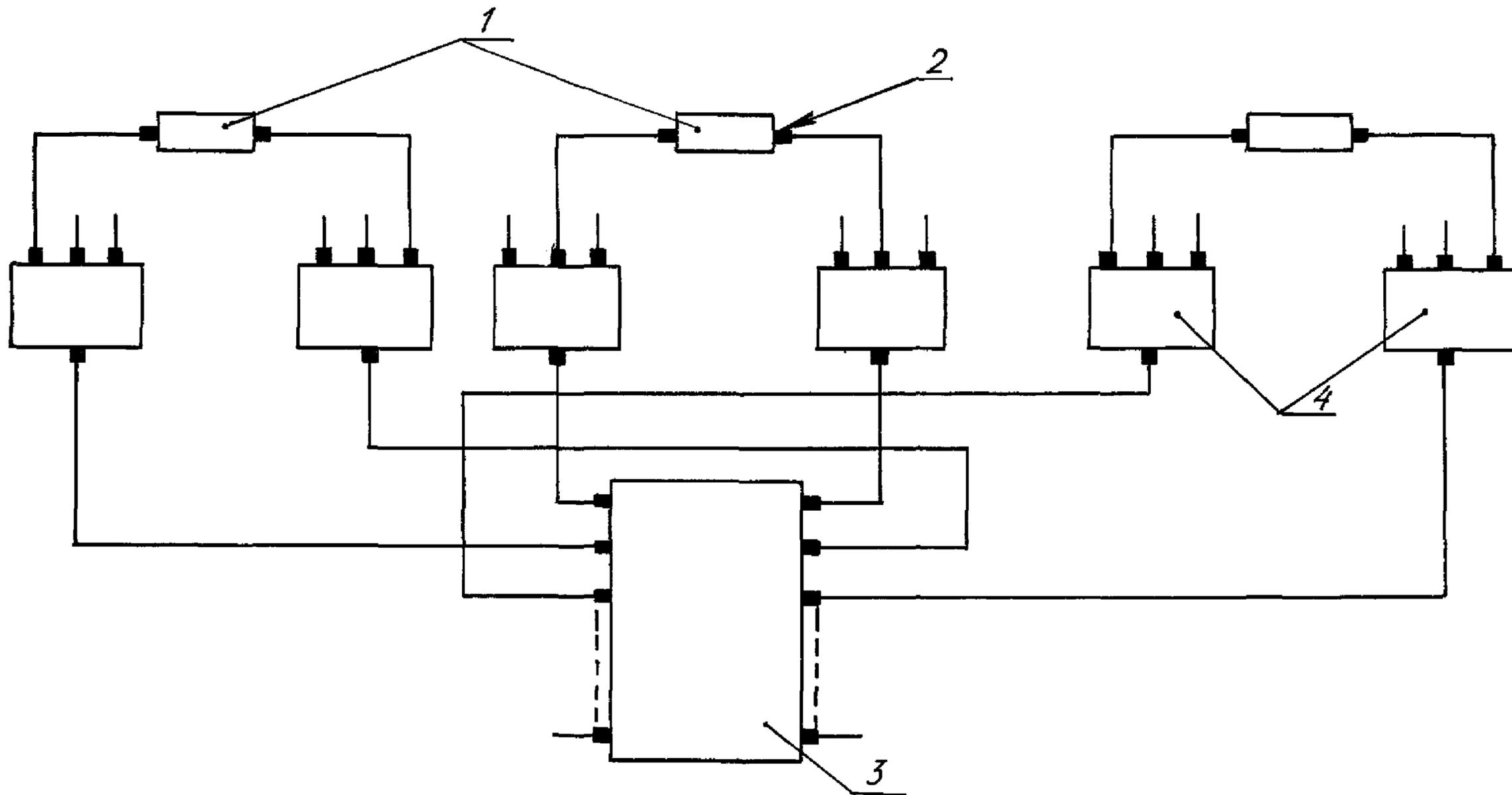
1 - приемо-передающий оптоэлектронный модуль; 2 - оптический соединитель; 3 - многоканальный оптический разветвитель;
