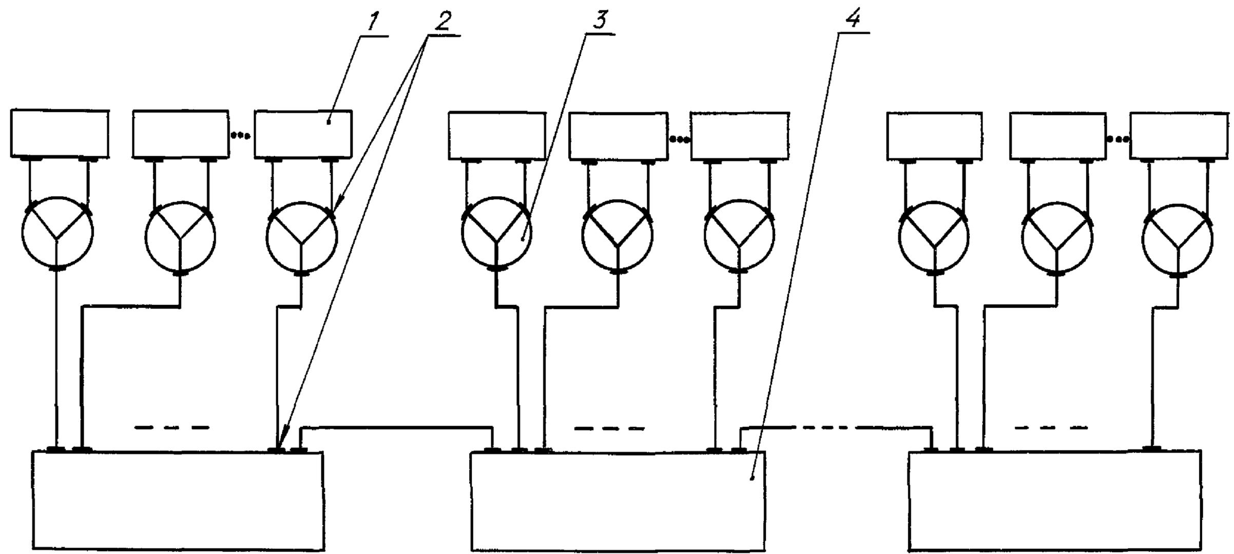
1 - приемно-передающий оптоэлектронный модуль; 2 - оптический соединитель; 3 - У-образный оптический разветвитель; 4 - звездообразный оптический разветвитель отражательного типа
