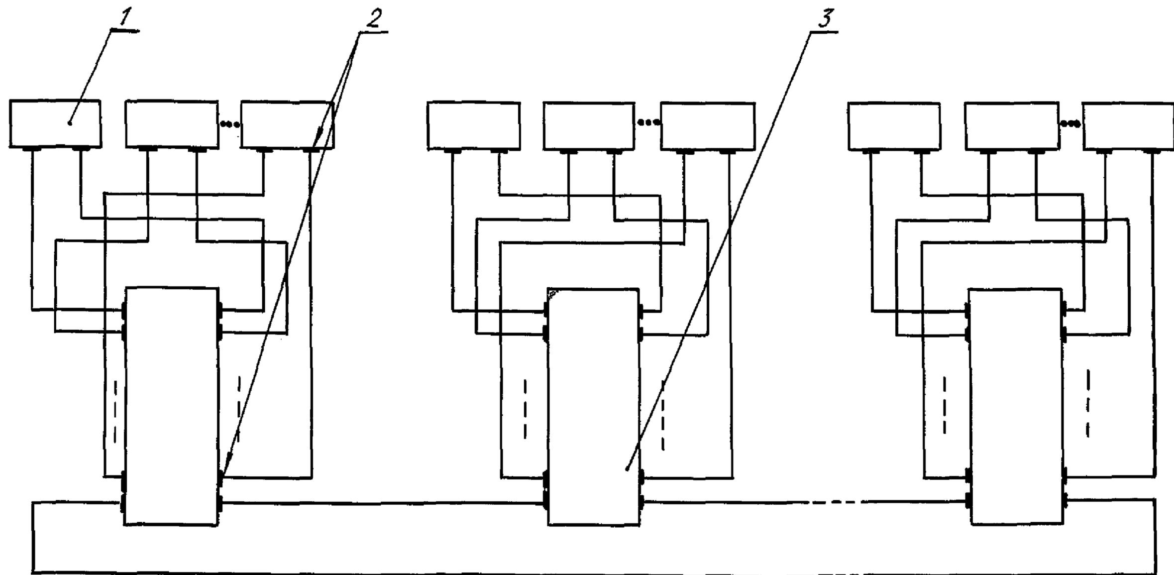
1 - приемо-передающий оптоэлектронный модуль; 2 - оптический соединитель; 3 - звездообразный оптический разветвитель проходного типа
