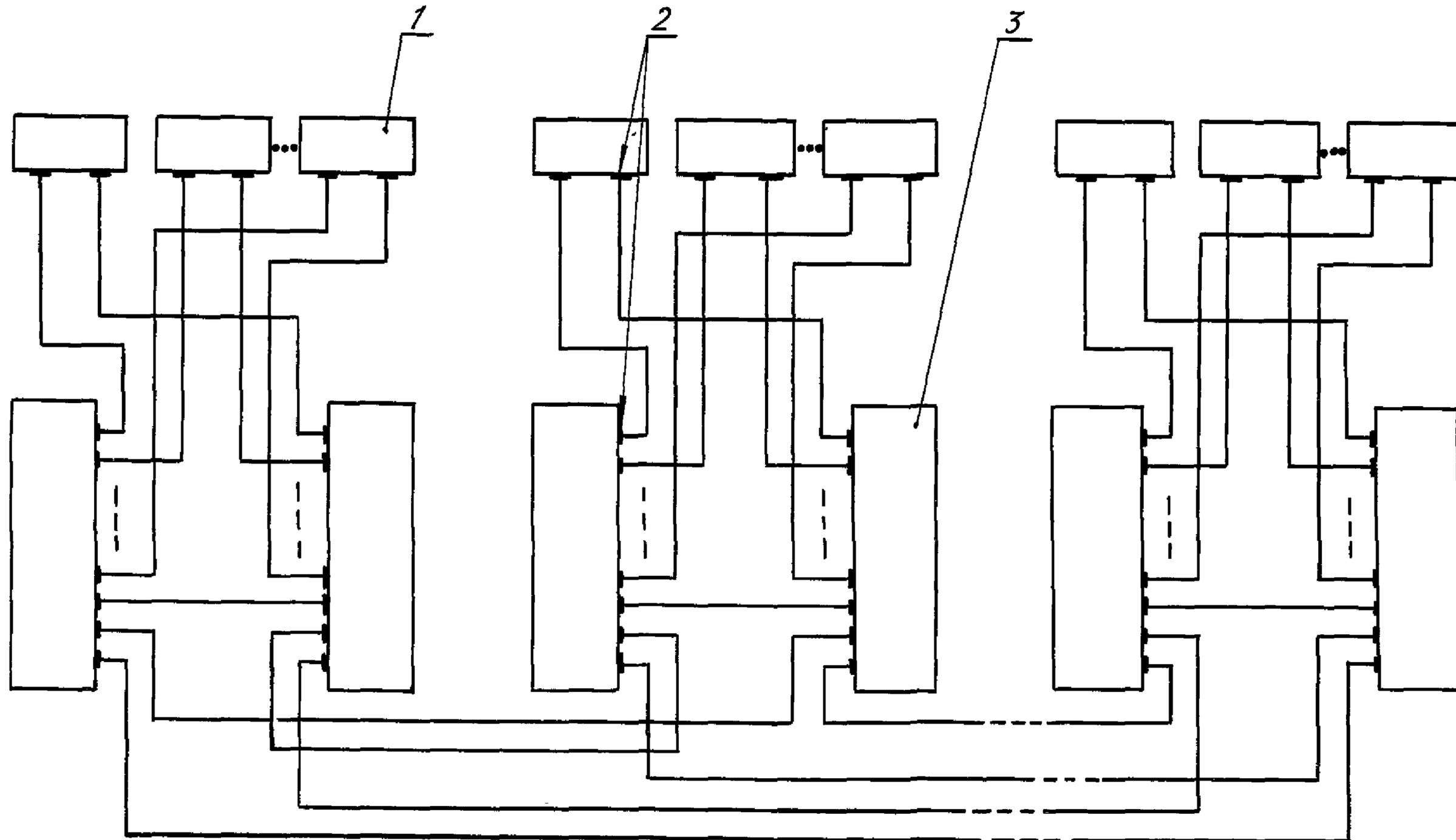
1 - приемно-передающий оптоэлектронный модуль; 2 - оптический соединитель; 3 - звездообразный оптический разветвитель отражательного типа
