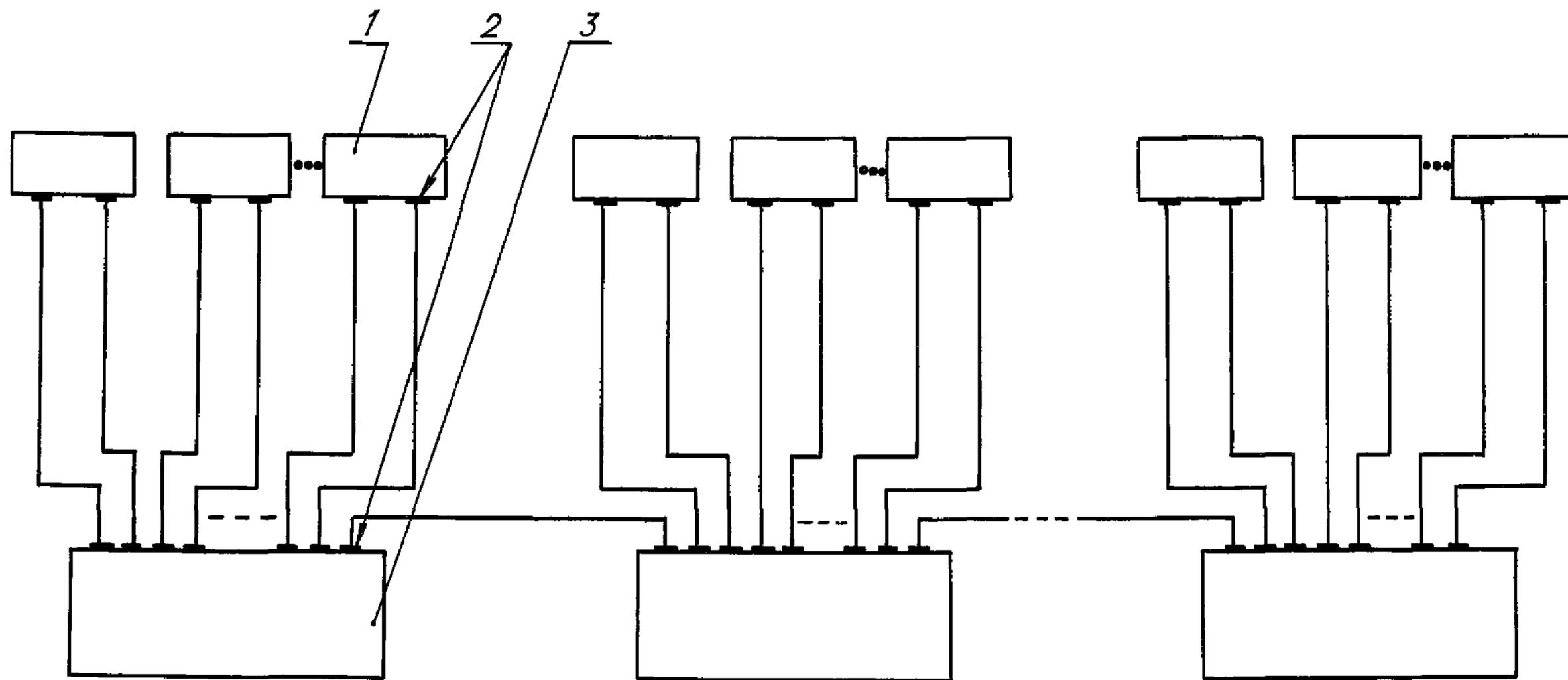
1 - приемо-передающий оптоэлектронный модуль; 2 - оптический соединитель; 3 - звездообразный оптический разветвитель отражательного типа
