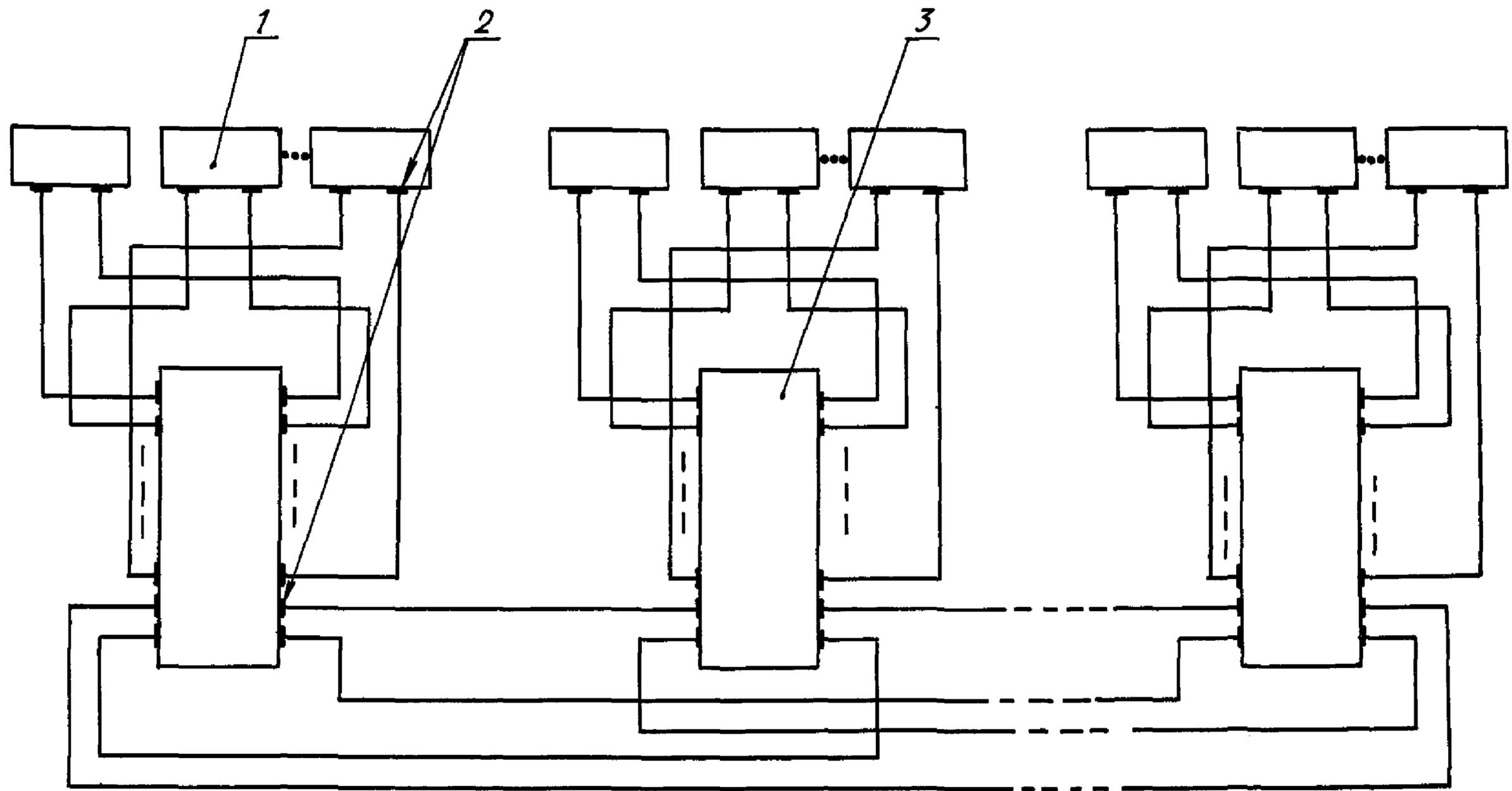
1 - приемо-передающий оптоэлектронный модуль; 2 - оптический соединитель; 3 - звездообразный оптический разветвитель проходного типа
