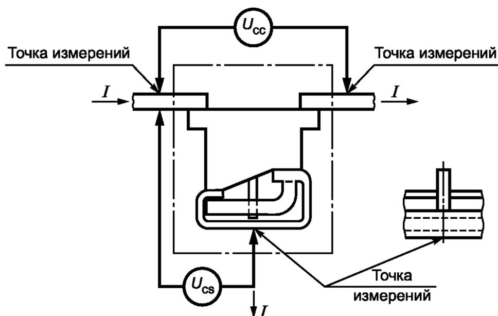
Рисунок 2 — Схема измерений падения напряжения
