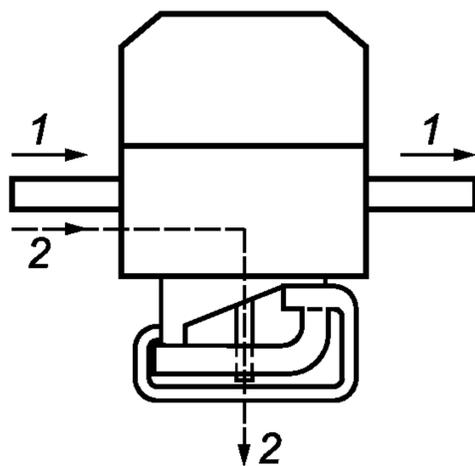
Рисунок 5 — Схема испытания на тепловой кратковременно выдерживаемый ток
