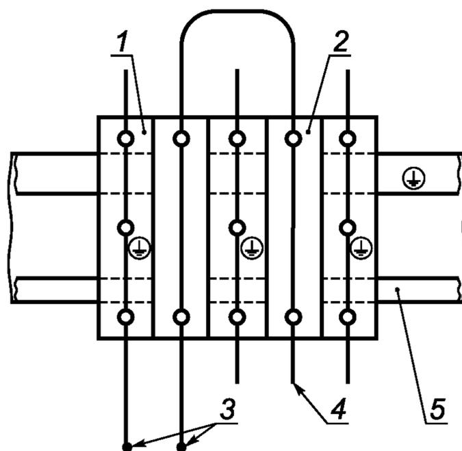
1 — клеммная колодка защитных проводников; 2 — клеммная колодка по *ГОСТ Р 50030.7.1*; 3 — испытательное напряжение;
