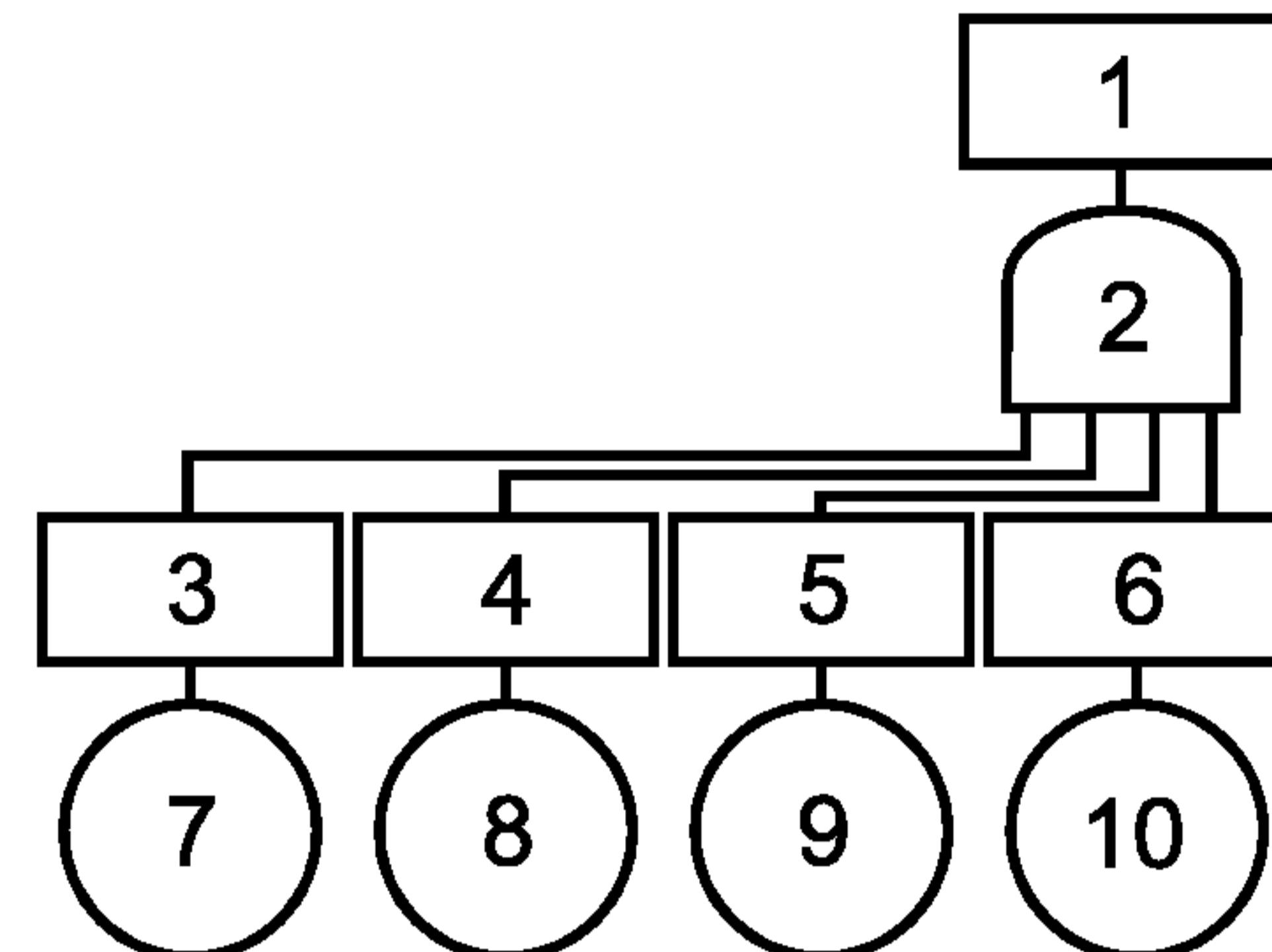
Рисунок 3 — Представление параллельной системы в виде ДН
