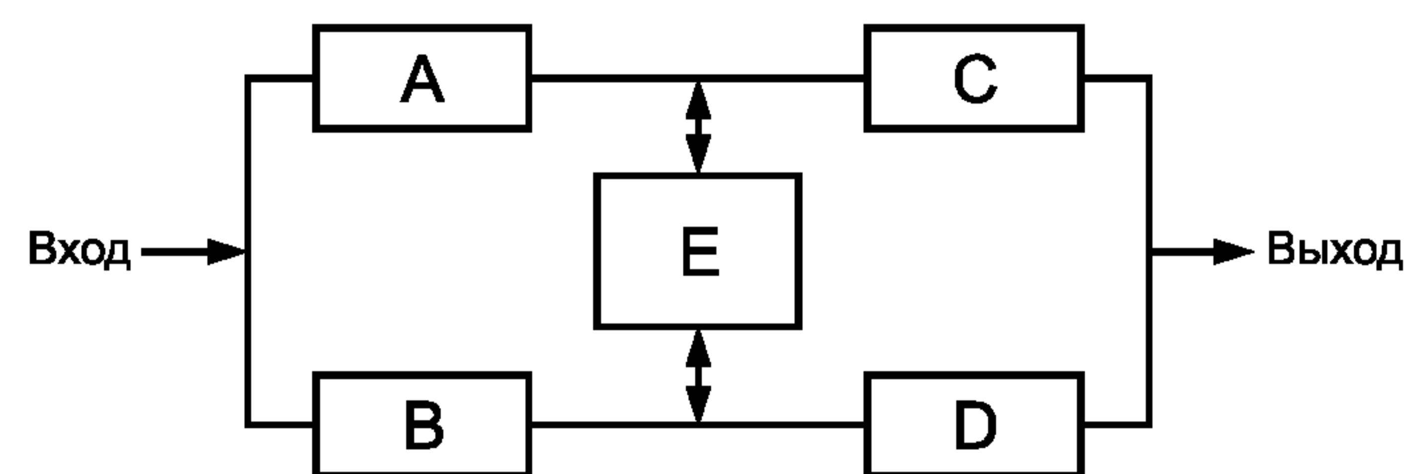
Рисунок 8 — Пример мостовой схемы, анализируемой с помощью ДН
