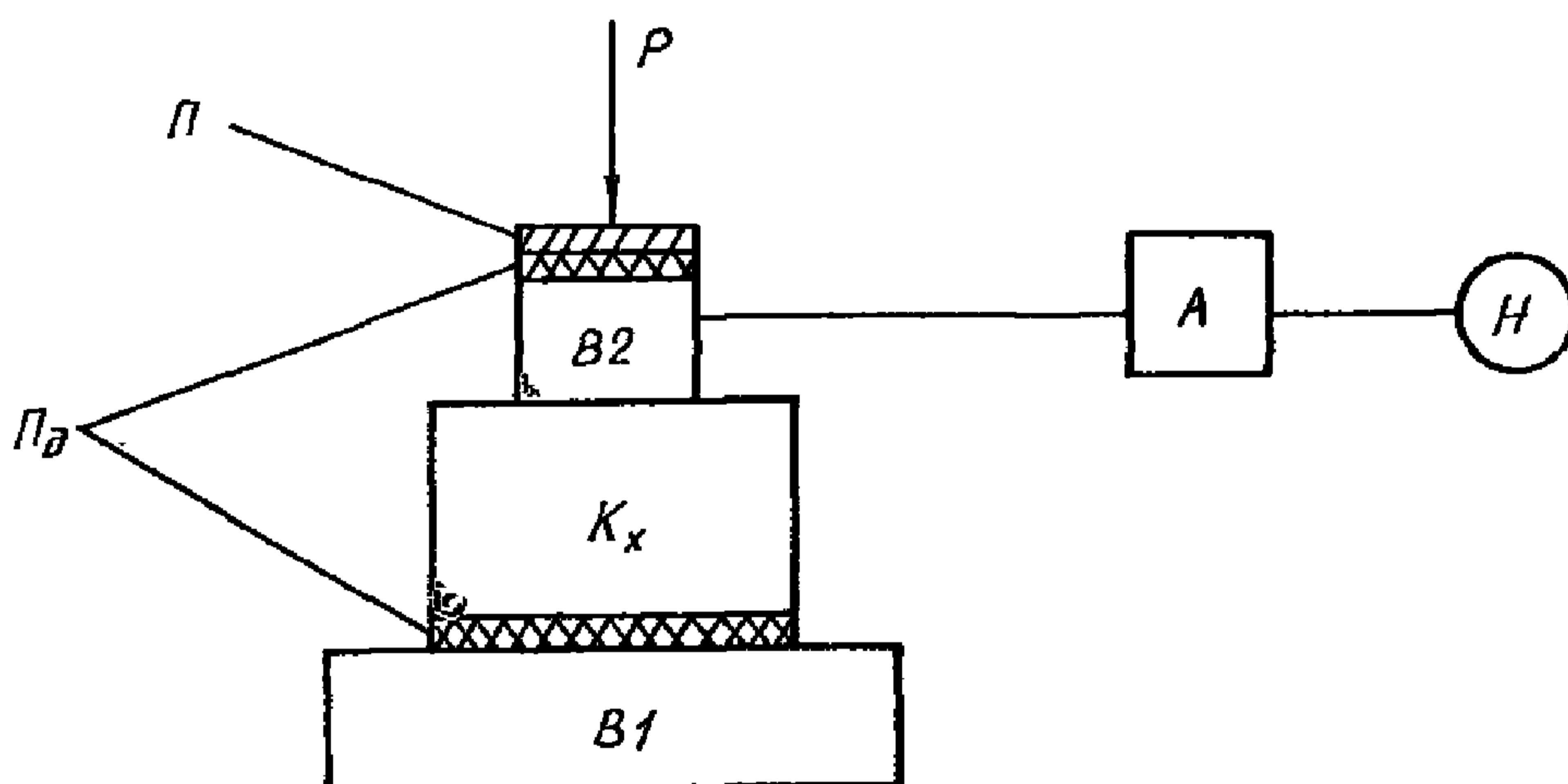
$K_x$  – исследуемый аппарат;  $B_1$  – вибростенд;  $B_2$  – измерительный преобразователь ускорения;  $\Pi_d$  – демпфирующие прокладки;  $\Pi$  – прижим;  $A$  – согласующее устройство;  $H$  – осциллограф;
