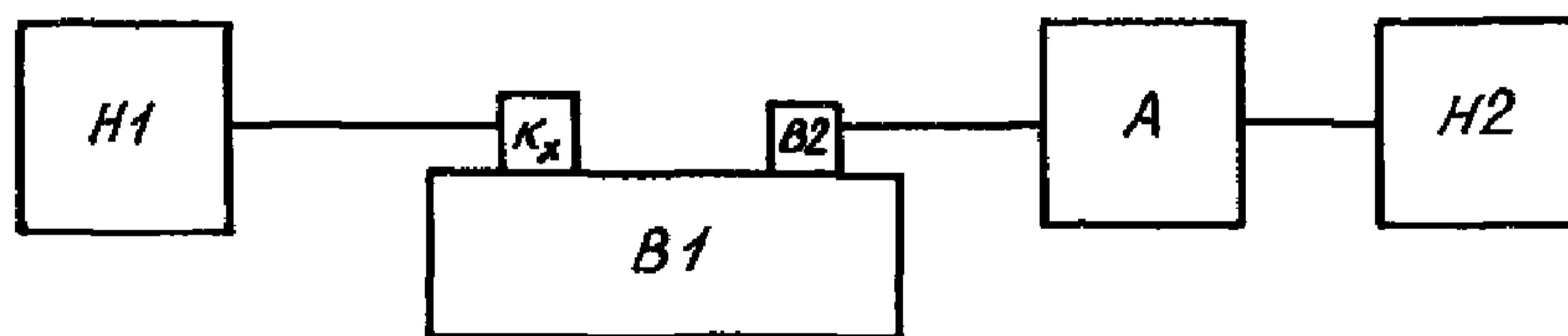
$A$  – предварительный усилитель;  $B1$  – электродинамический ударный стенд (например, типа 12 МУЭ – 20/1960-1);
