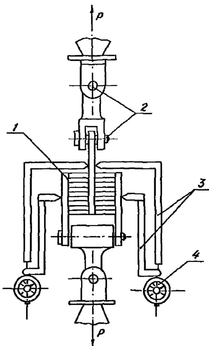
1 – образец; 2 – шарнир; 3 – устройство для измерения перемещений; 4 – индикатор
