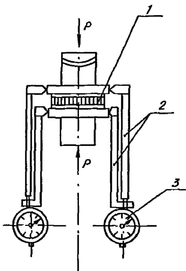
1 - образец; 2 - устройство для измерения перемещений; 3 - индикатор
