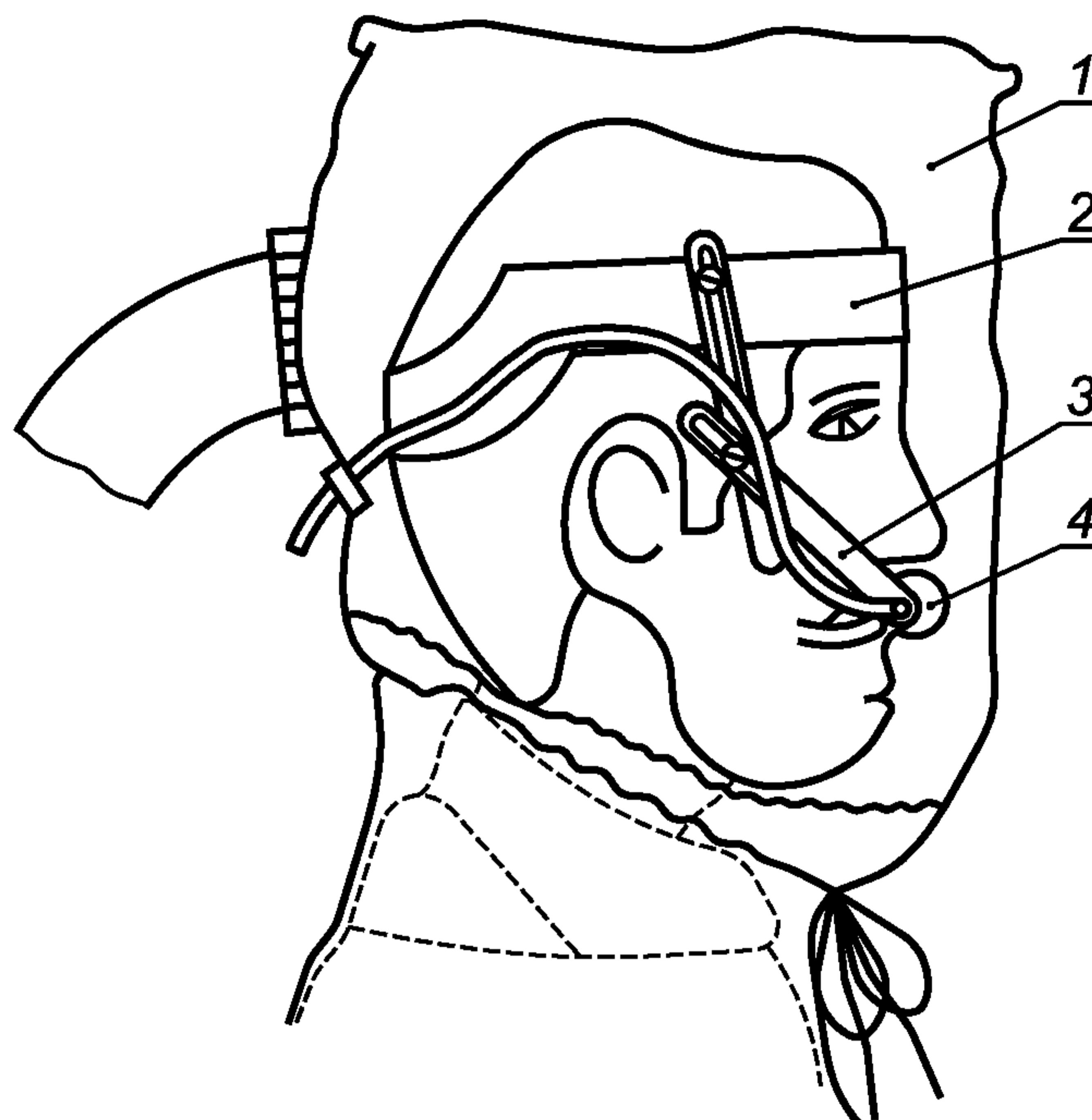
1 — испытуемый капюшон; 2 — оголовье; 3 — регулируемый пластмассовый кронштейн; 4 — пробоотборник
