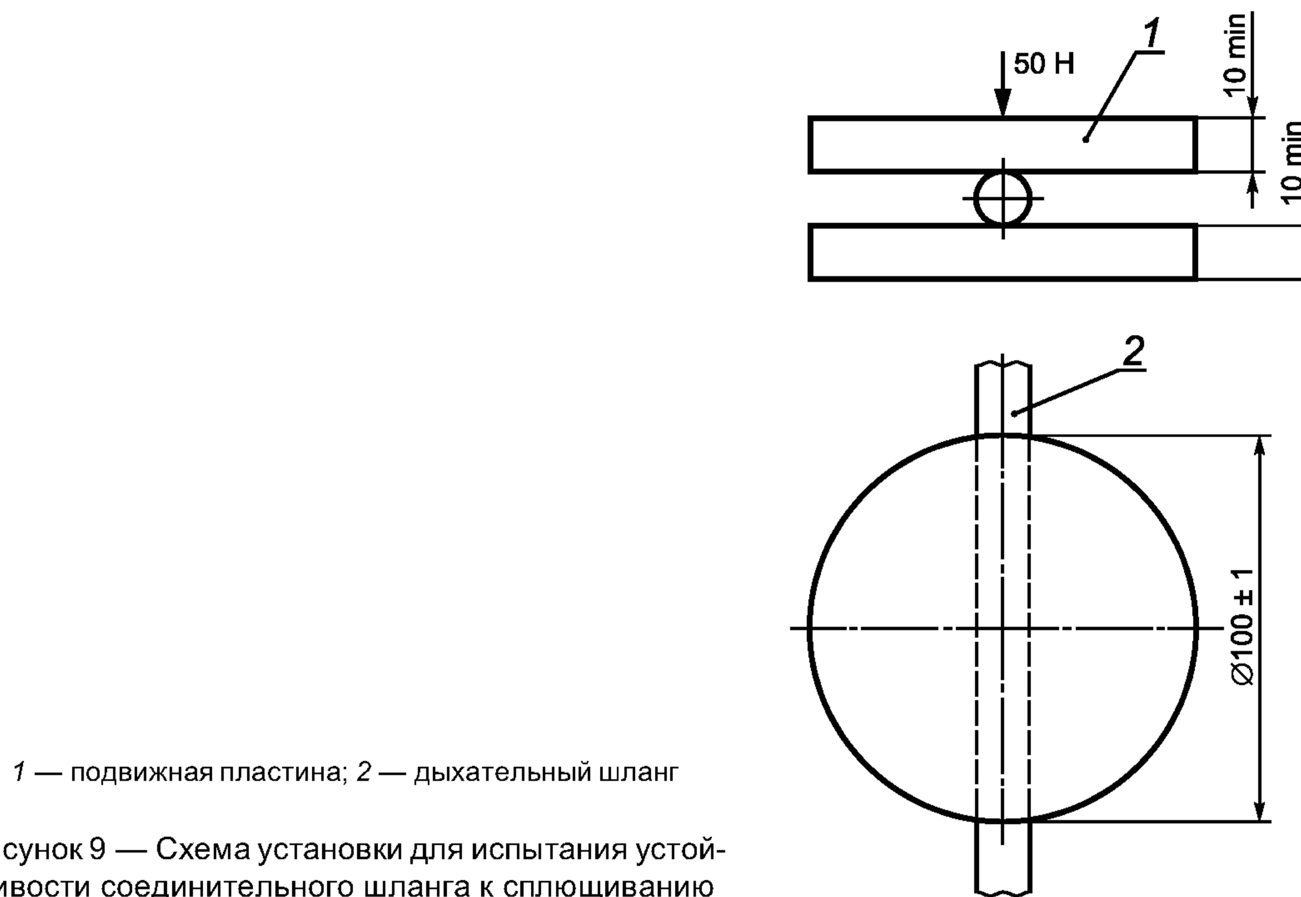
Рисунок 9 — Схема установки для испытания устойчивости соединительного шланга к сплющиванию
