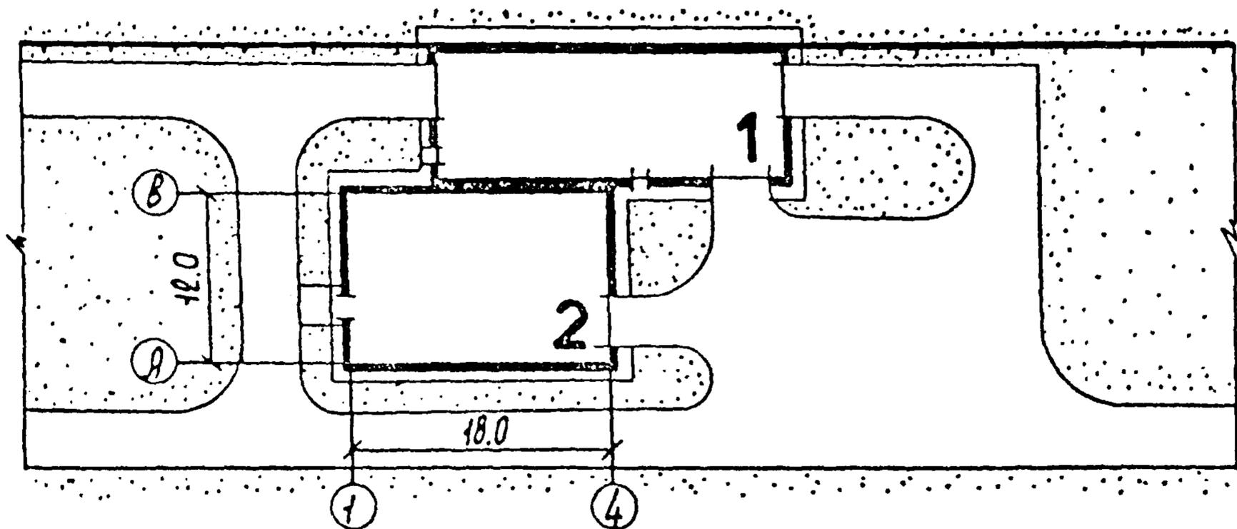
Вариант отдельного здания очистных сооружений
