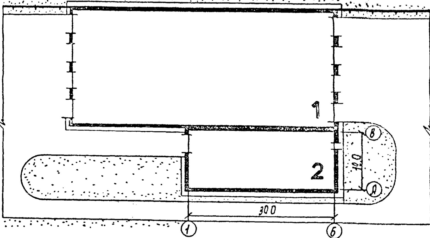
Вариант отдельного здания очистных сооружений
