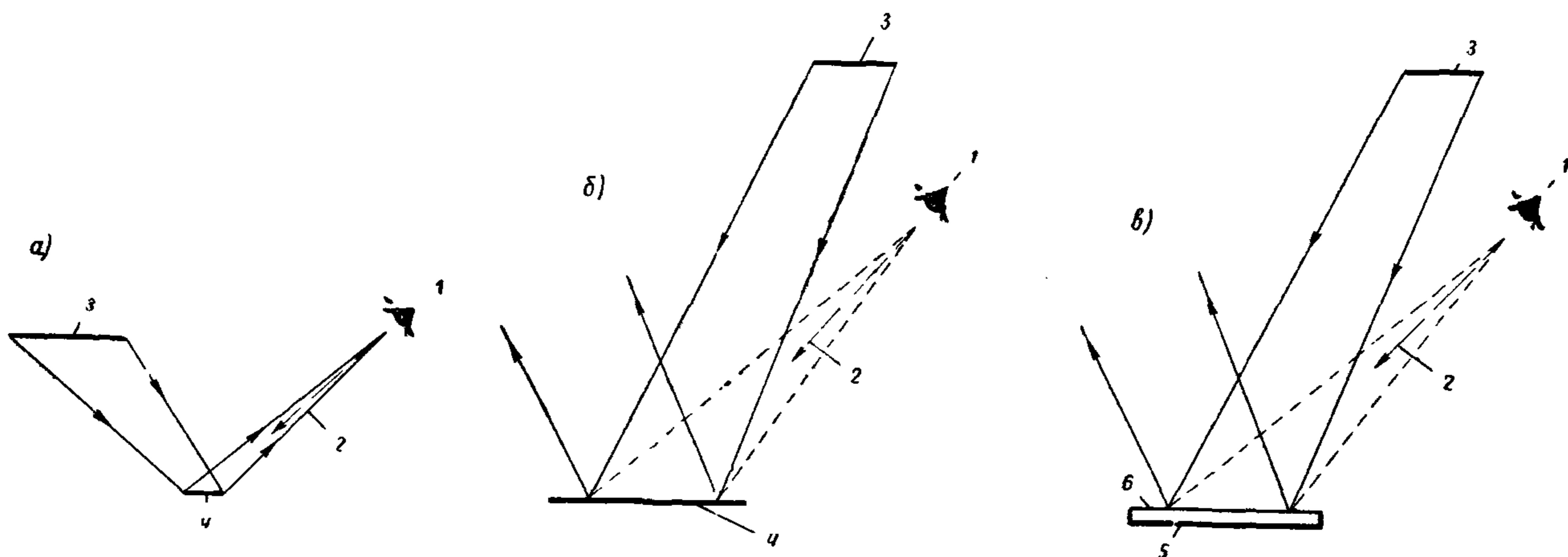
Рис. 1. Схемы расположения светильника, рабочей поверхности и работающего
