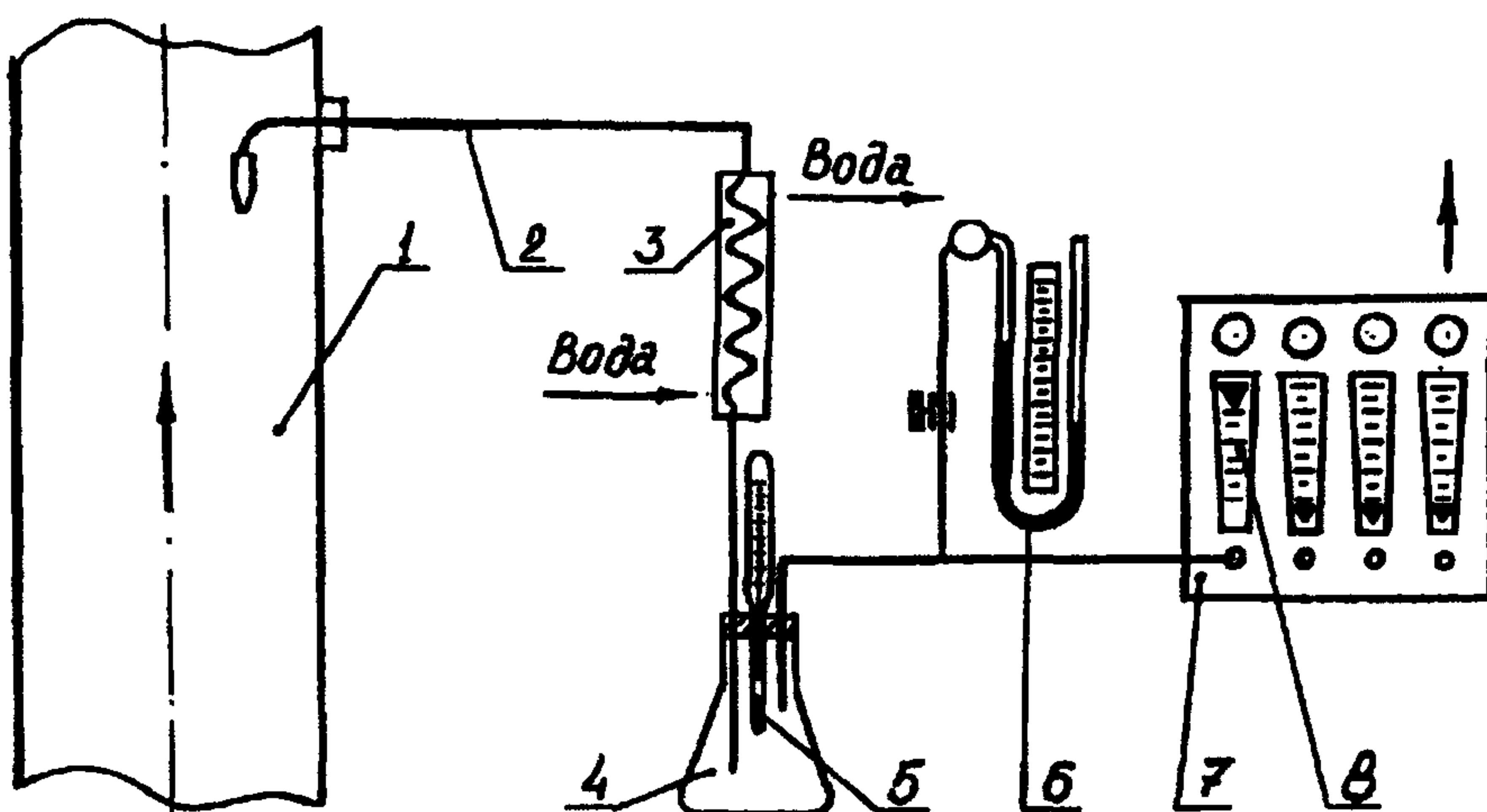
Рис. 1.6.1. Схема измерения влажности газа конденсационным методом.
