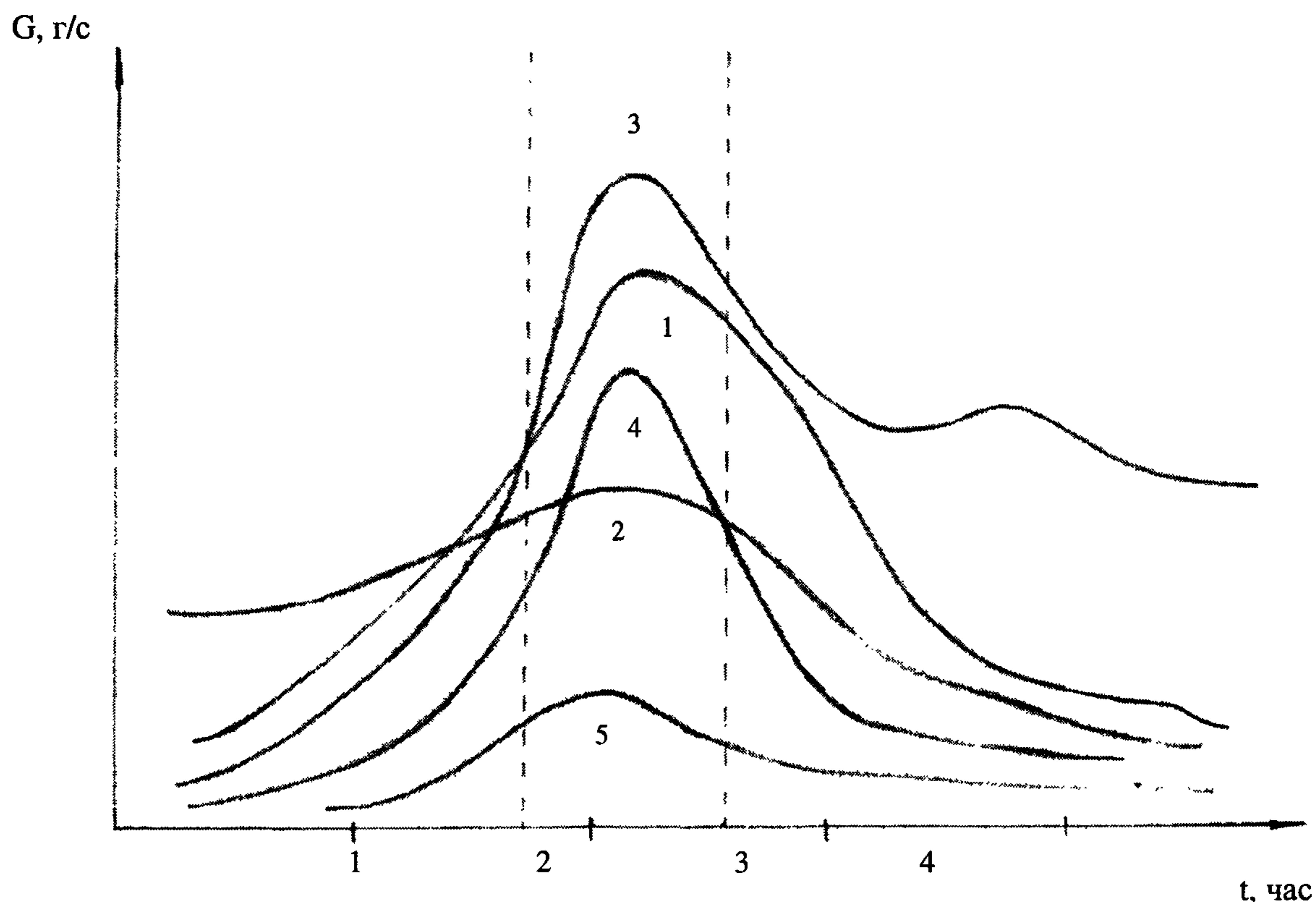
Рис. 3.2.2. График нестационарности выбросов пыли (1), оксидов азота (2), диоксида серы (3), летучих фторидов (4) и оксида углерода (5) при плавке металла в электропечи.
