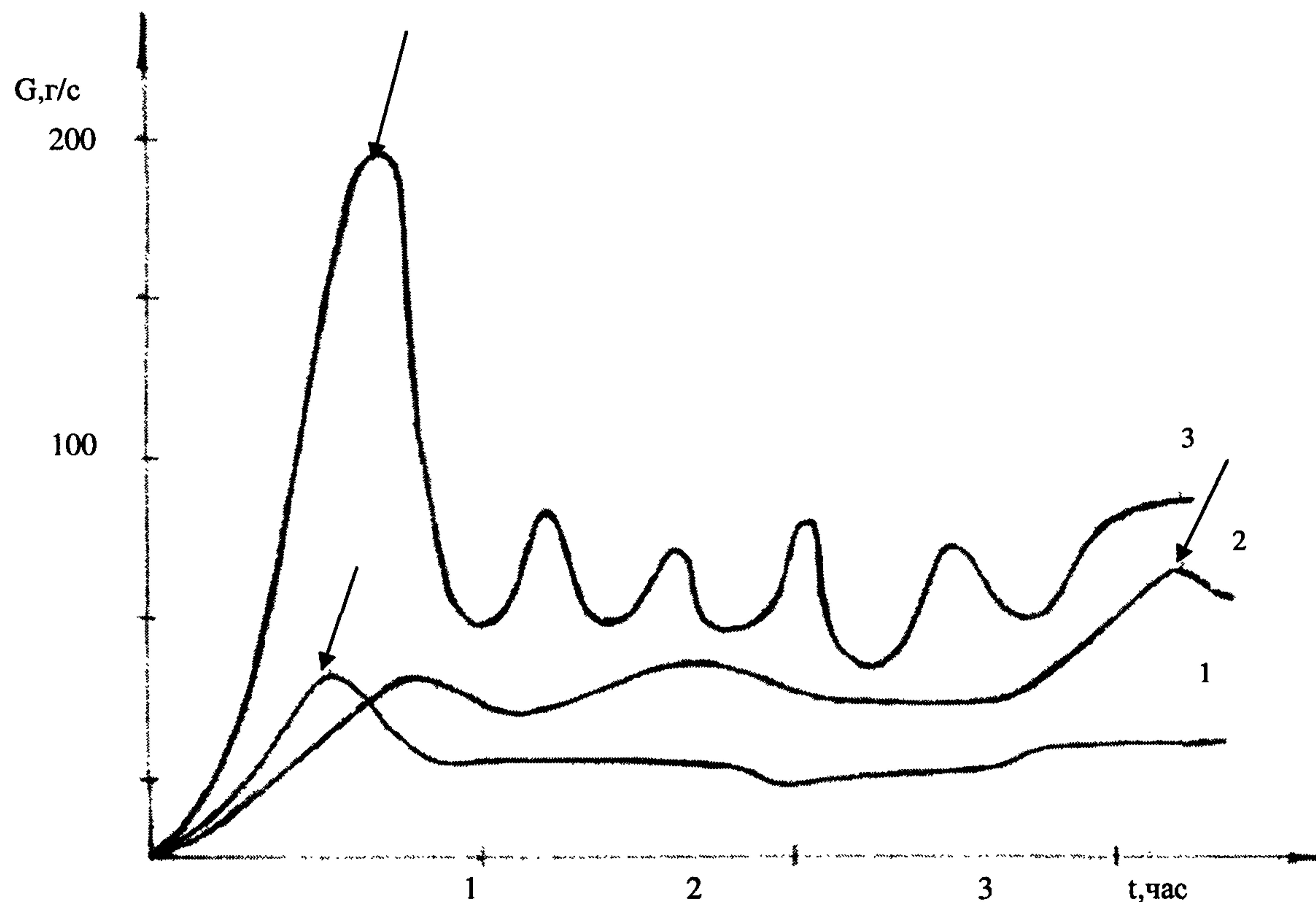
Рис. 3.2.1. График нестационарности выбросов оксидов углерода (1), азота (2) и серы (3) в цикле производства ферросплавов
