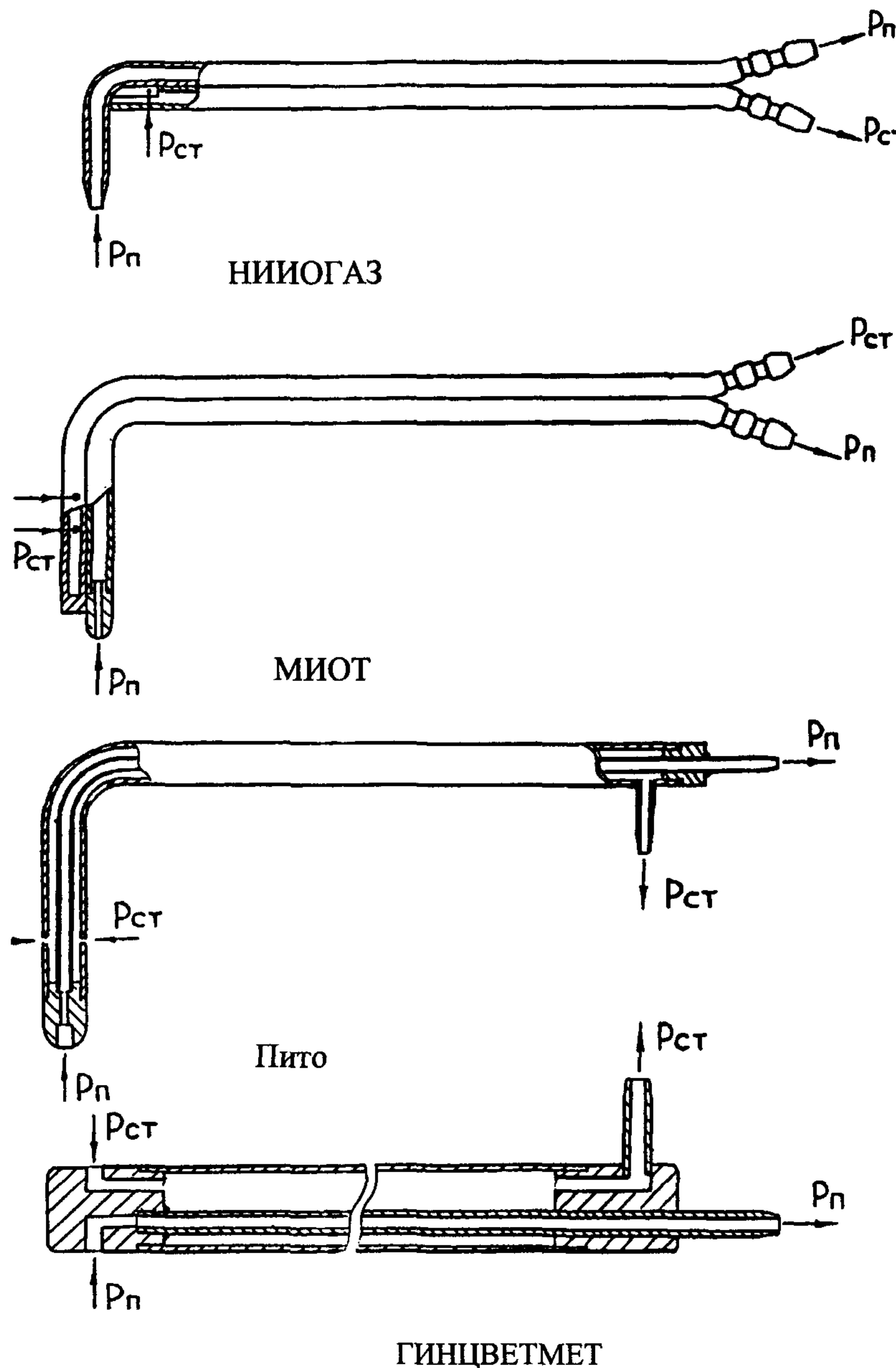
Рис.1.4.2. Основные конструкции пневмометрических трубок.
