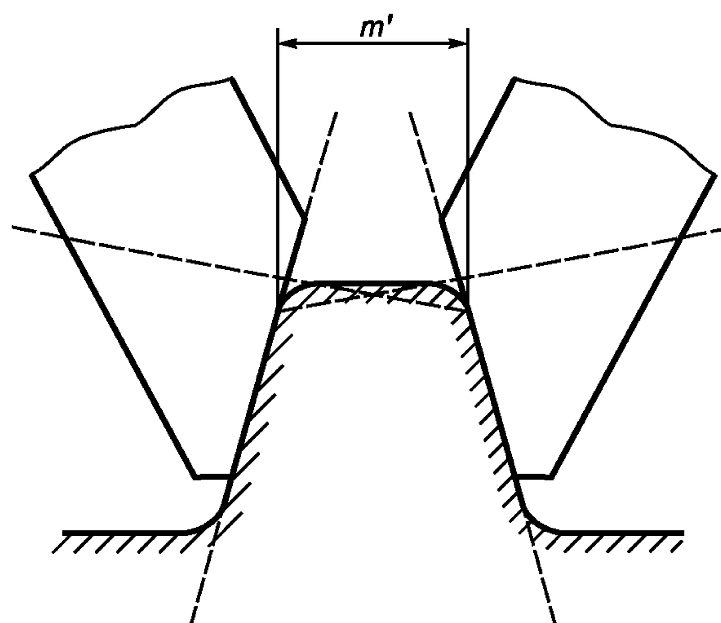
Рисунок 9 — Определение ширины выступов калибров-пробок
