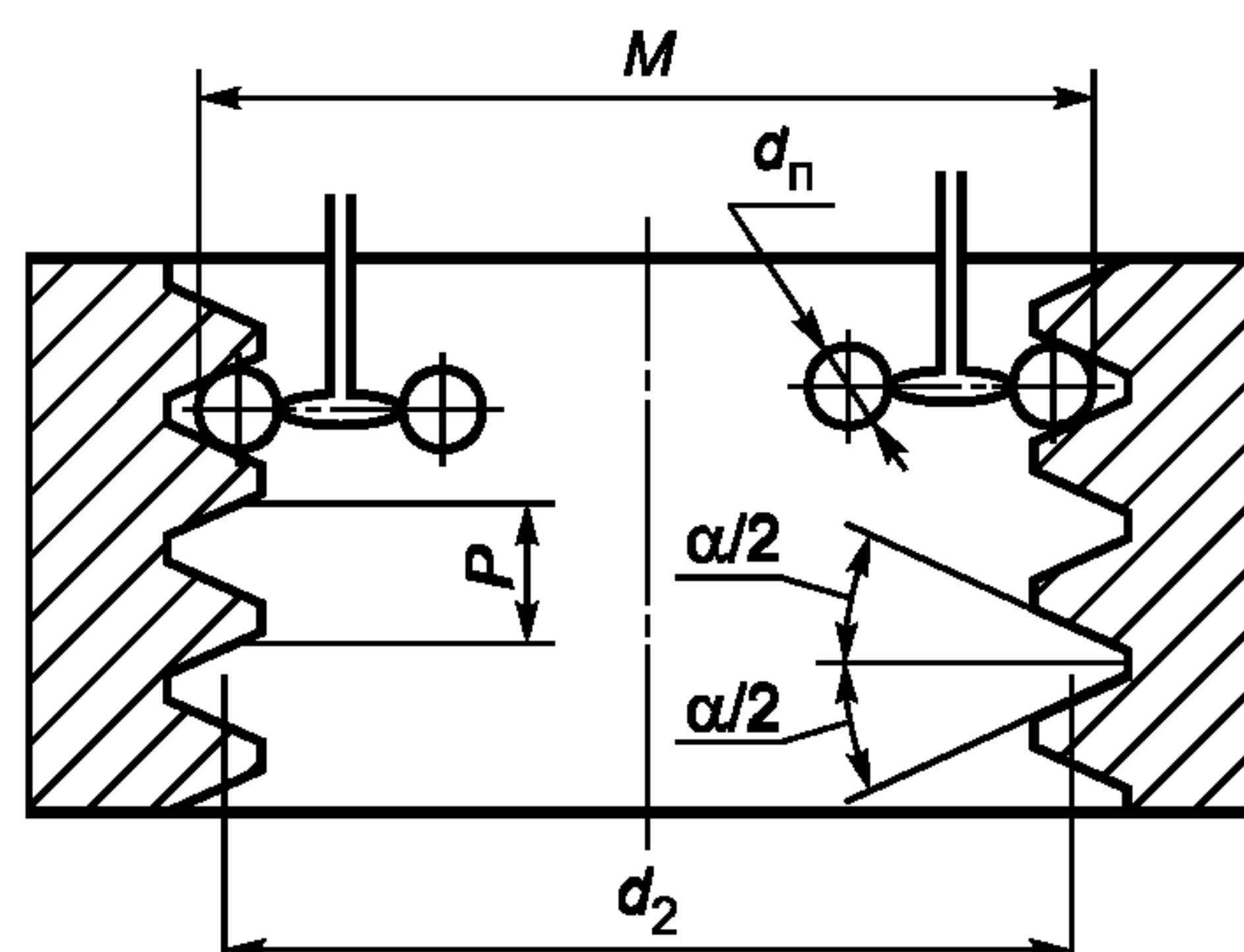
Рисунок 10 — Измерение среднего диаметра калибра-кольца
