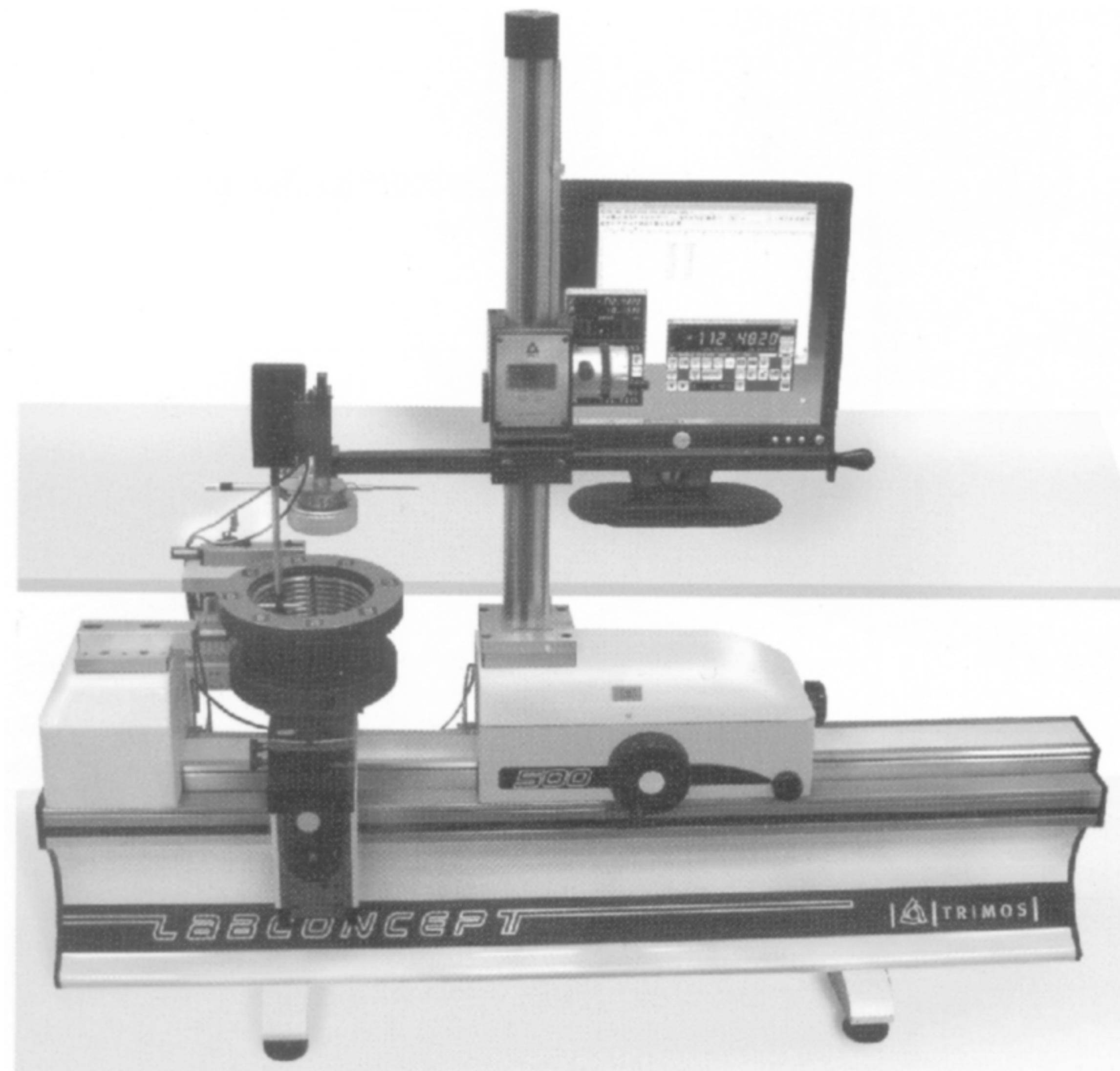
Рисунок Д.1 — Горизонтальный длинометр LabConcept 500
