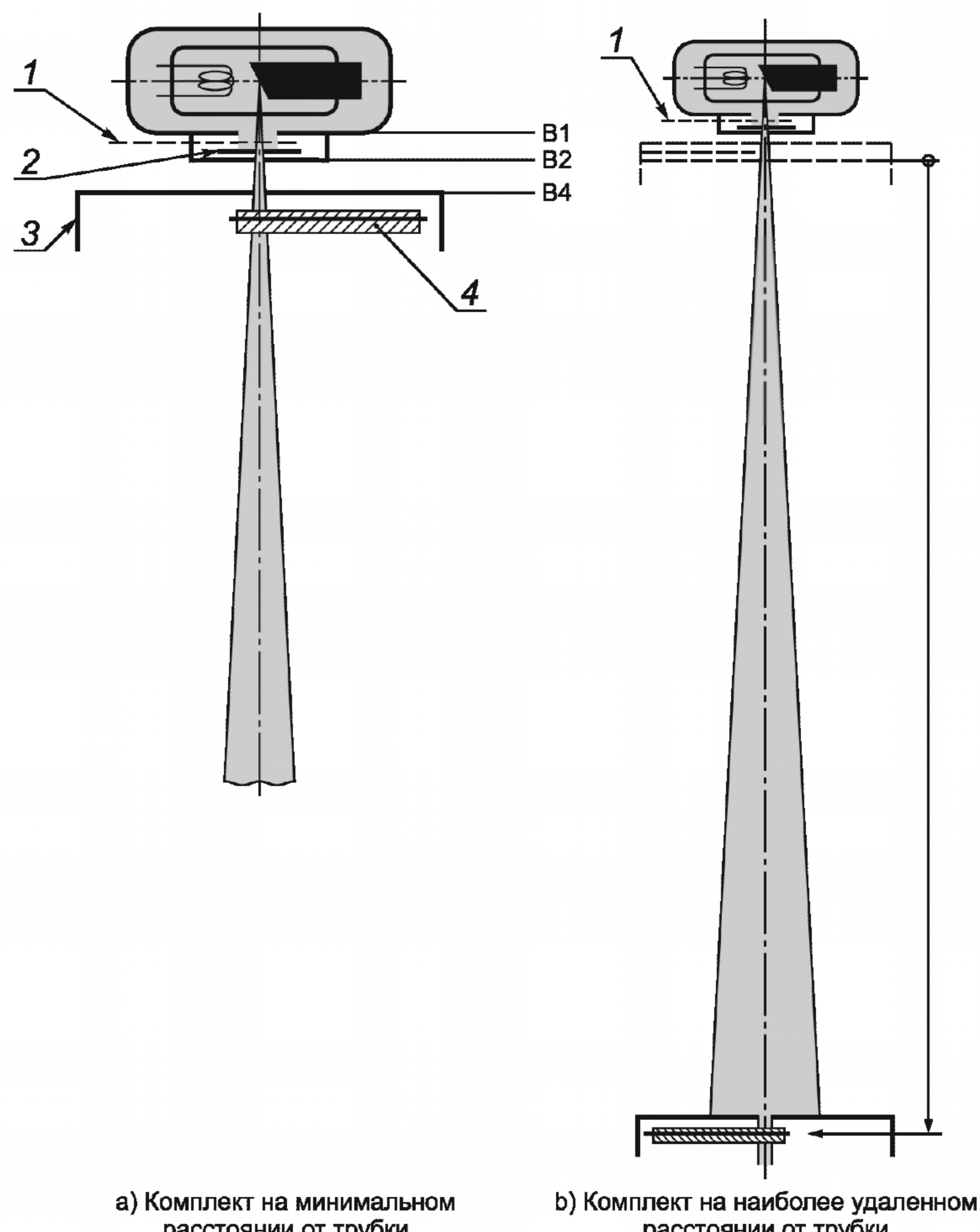
B1, B2, B4 — диафрагмы пучка излучения; 1 — врачающийся прерыватель; 2 — дополнительный фильтр;
