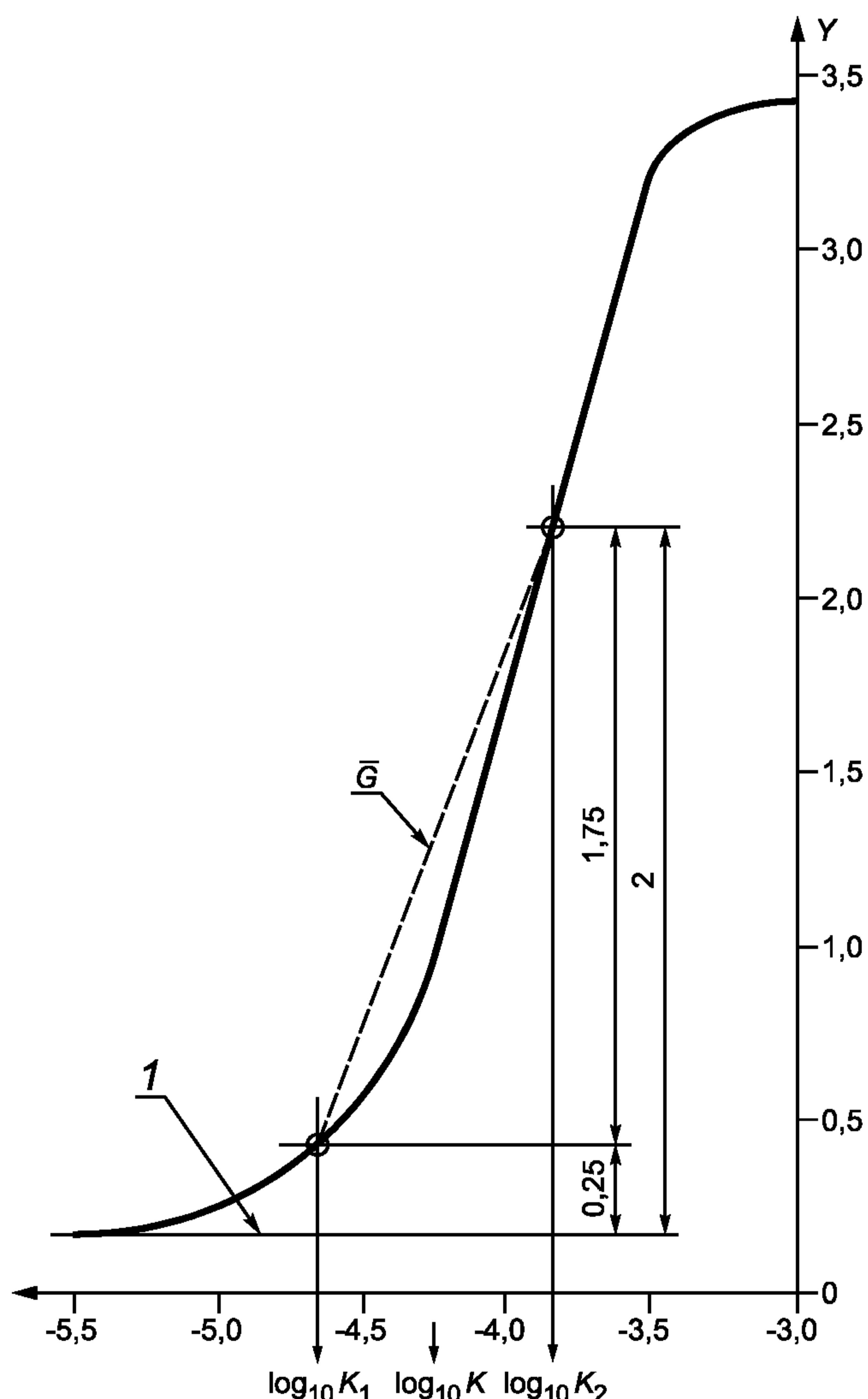
Y — оптическая диффузная плотность; 1 — плотность образца обработанной неэкспонированной пленки;  $\bar{G}$  — средний градиент
