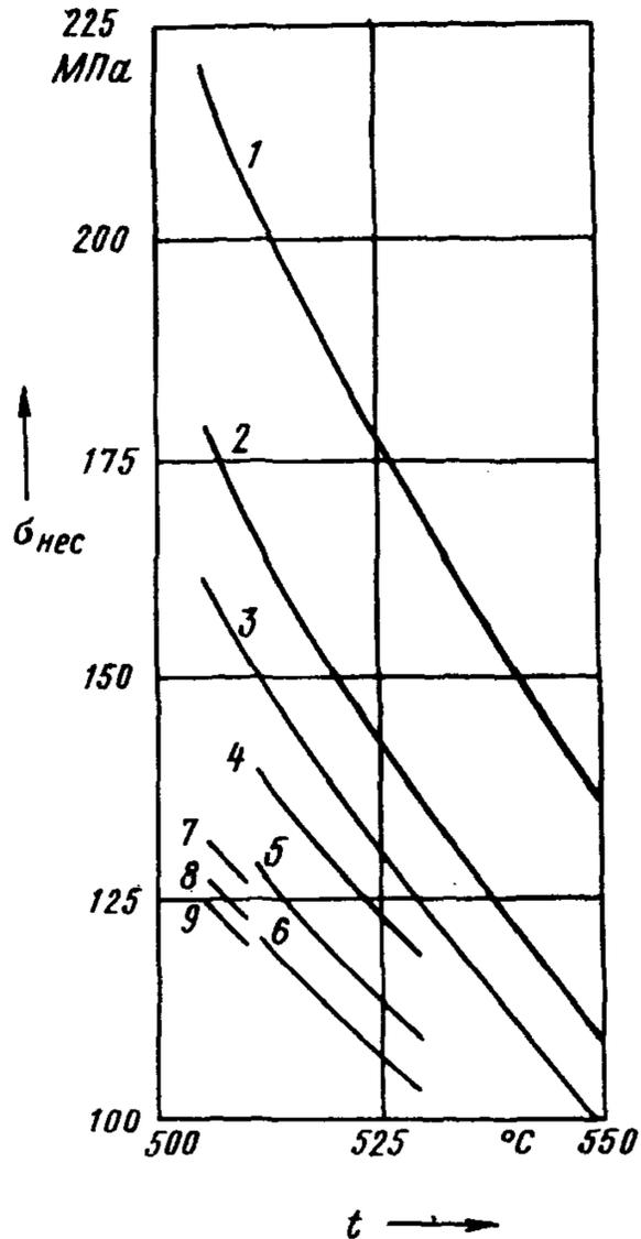
1 — профиль № 1701 (СП-104),  $r_1/d=0,046$ ;  $\sigma_{н.р} \approx 100$  МПа;  $\theta_p=150$  тыс. ч; 2 — то же,  $\theta_p=175$  тыс. ч; 3 — то же,  $\theta_p=200$  тыс. ч; 4 — профиль № 1702 (СП-125),  $r_1/d=0,032$ ;  $\theta_p=100$  тыс. ч; 5 — то же,  $\theta_p=150$  тыс. ч; 6 — то же,  $\theta_p=200$  тыс. ч; 7 — профиль № 1802 (СП-304),  $r_1/d=0,029$ ;  $\theta_p=100$  тыс. ч; 8 — то же,  $\theta_p=150$  тыс. ч; 9 — то же,  $\theta_p=200$  тыс. ч
