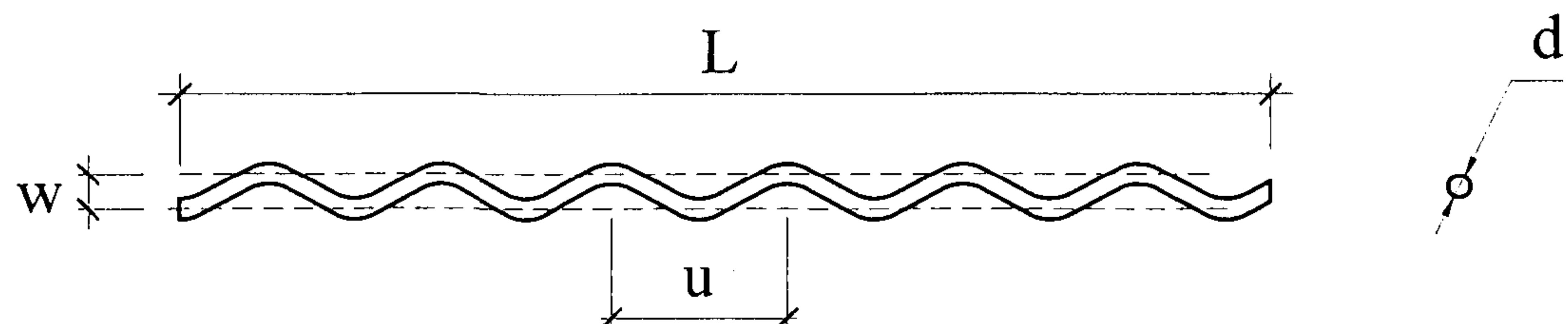
Рис.2 Форма и размеры фибры типа «ФВ»
