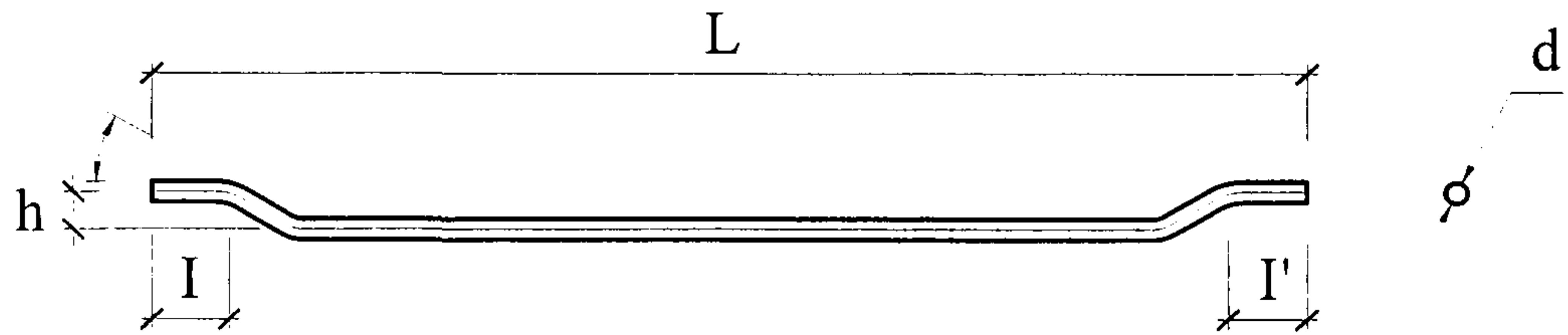
Рис.1 Форма и размеры фибры типа «ФЛА»
