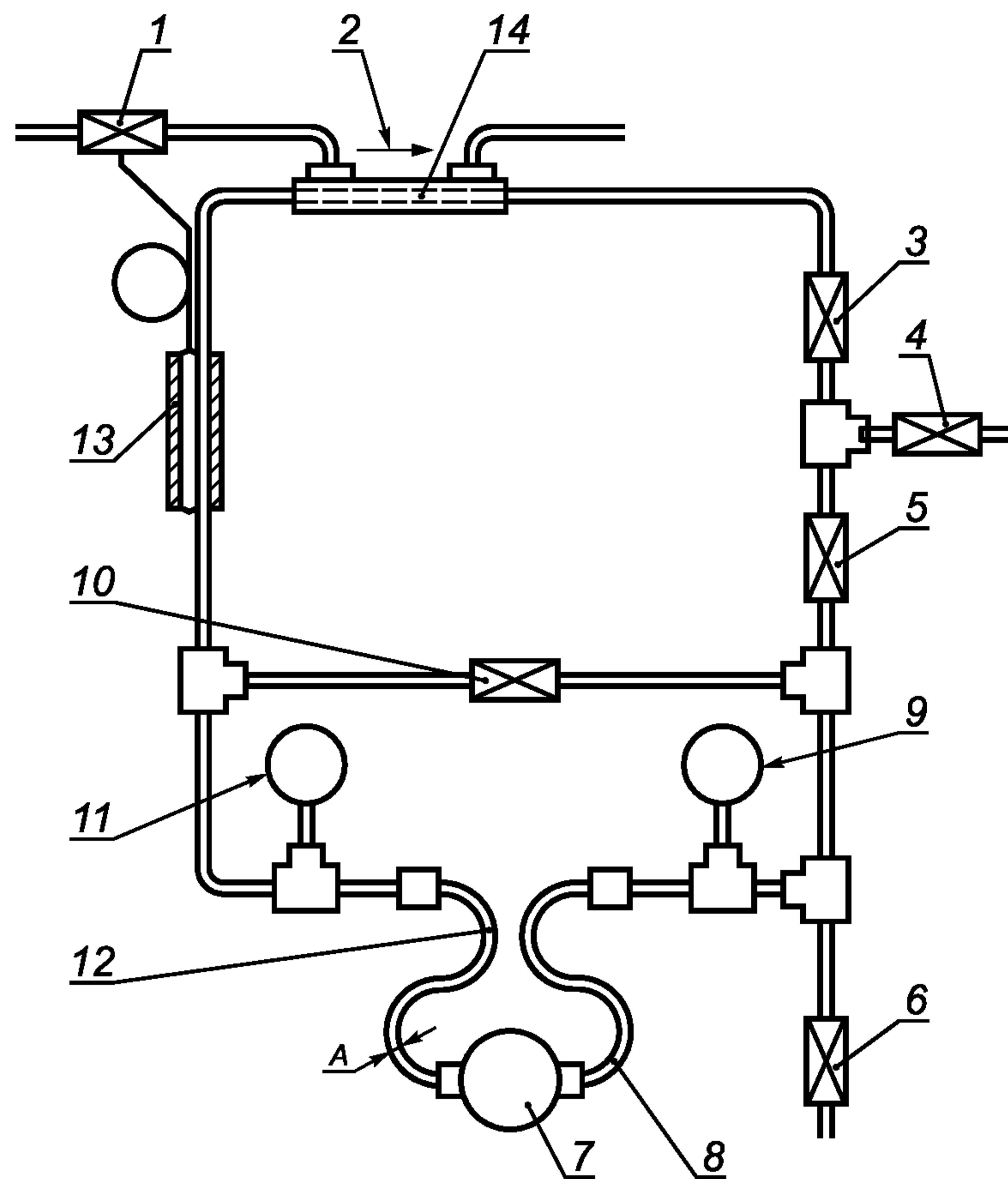
1 — терморегулирующий водяной клапан; 2 — охлаждающая вода; 3 — устройство управления всасыванием; 4 — выпускной клапан; 5 — устройство управления давлением нагнетания; 6 — выпускной клапан; 7 — мотор-компрессор; 8 — линия давления нагнетания; 9 — нагнетание; 10 — клапан для выравнивания давления; 11 — всасывание; 12 — линия всасывания; 13 — датчик терморегулятора; 14 — теплообменник
