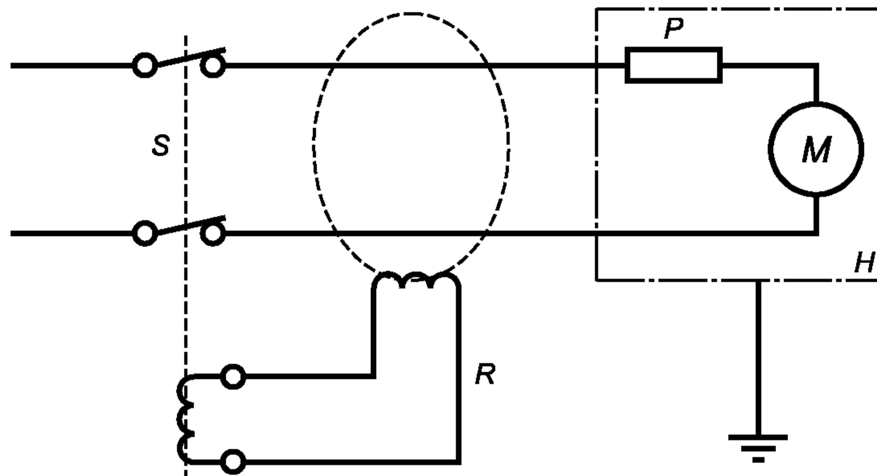
*M — мотор-компрессор; S — источник питания; H — кожух; R — устройство защитного отключения, которое срабатывает при переменном токе или переменном токе с постоянной составляющей,  $\max I_{\Delta n} = 30 \text{ мА}$  среднеквадратическое значение или постоянный ток  $\max I_{\Delta n} = 30 \text{ мА}$ ; P — система защиты мотор-компрессора (внешняя или внутренняя)*
