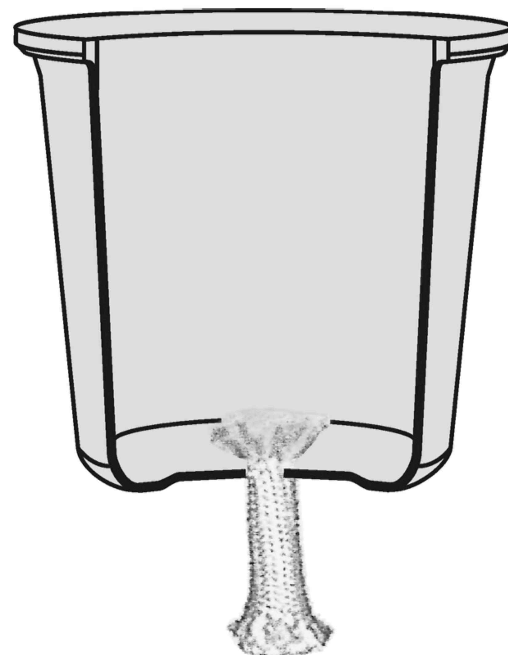
Рисунок 1 — Пример испытательного сосуда с фитилем из стекловолокна
