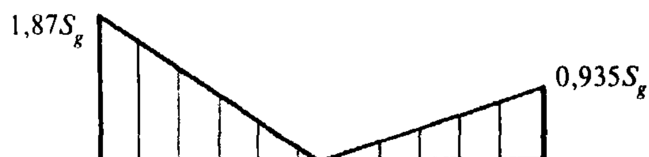
Рис. 5.4. Неравномерное (по треугольнику) распределение снега на покрытии
