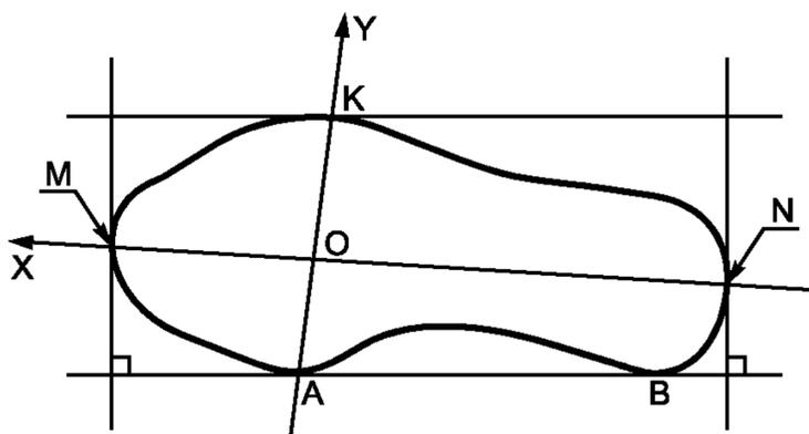
Рисунок 2 — Расположение оси Y
