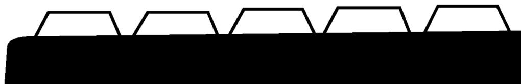
Рисунок 2 — Клавиатура с плоским профилем
