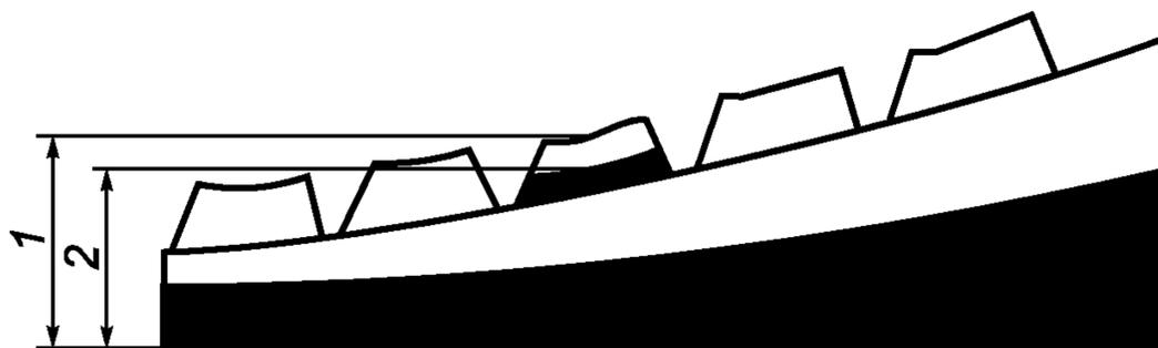
1 — высота ненажатой клавиши; 2 — высота полностью нажатой клавиши
