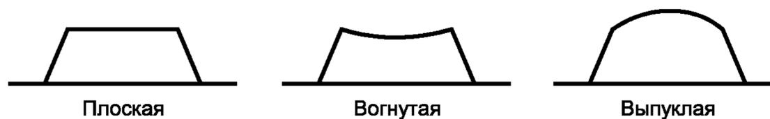
Рисунок 16 — Плоская, вогнутая и выпуклая поверхности клавиш
