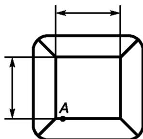
Рисунок 12 — Измерение площади рабочей поверхности клавиши
