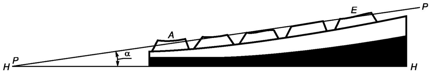
Рисунок 10 — Измерение наклона клавиатуры
