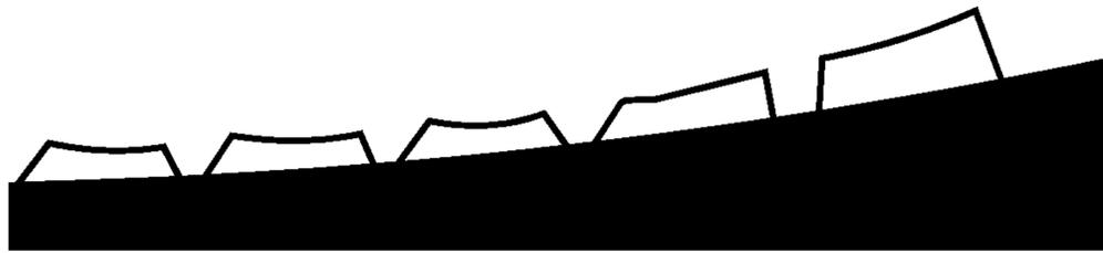
Рисунок 1 — Клавиатура с вогнутым профилем
