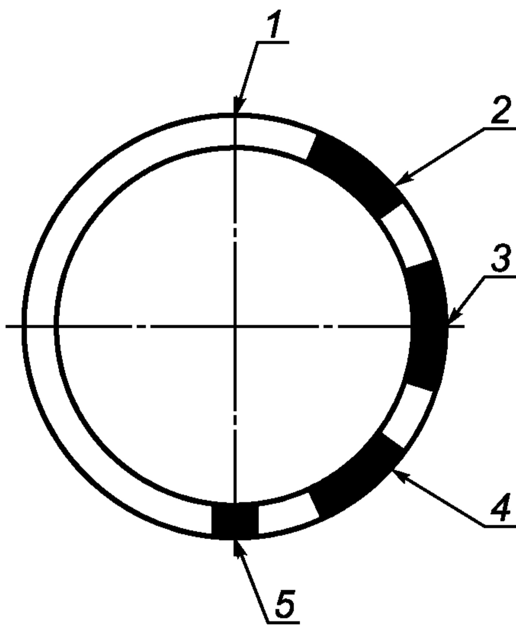
1 — верх неподвижной трубы; 2 — область для вырезки одного образца для испытаний на растяжение и образцов для испытаний на изгиб и на излом; 3 — область для вырезки образцов для ударных испытаний и дополнительных образцов, если предписано; 4 — область для вырезки дополнительных образцов, если предписано; 5 — область для вырезки одного образца для макроскопических исследований и одного образца для измерений твердости
