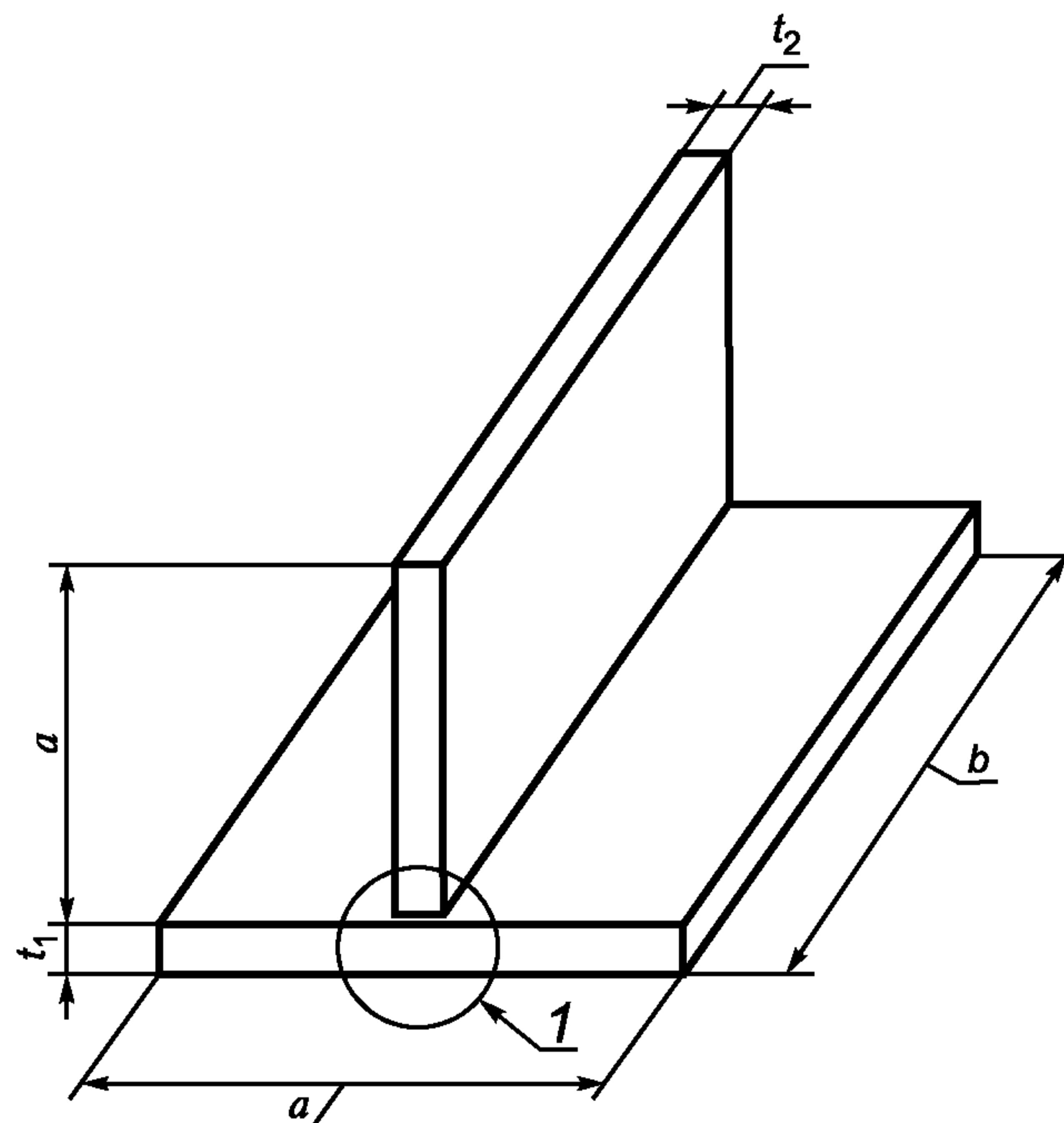
1 — сварной шов с одной или с обеих сторон. Подготовка и сборка соединения, как описано в рWPS;
