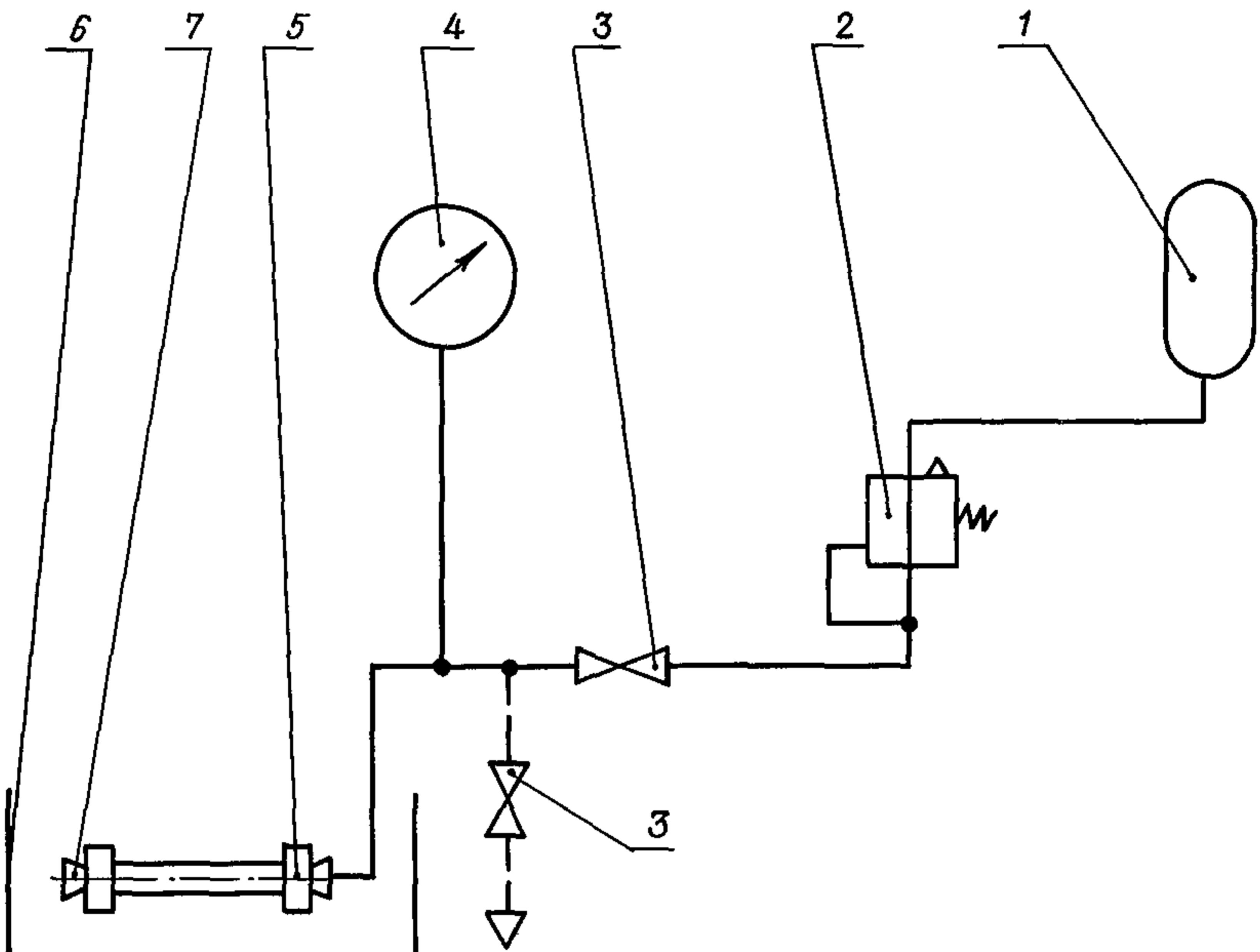
1 - баллон по ГОСТ 9731-79; 2 - регулятор давления; 3 - вентиль; 4 - манометр, класс точности 1,5; 5 - рукав по ОСТ 1 11836-74 или ОСТ 1 14300-83;
