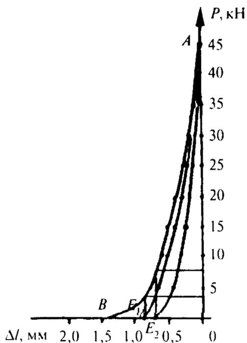
Рисунок Б.3 — Экспериментальные результаты разгрузки образцов с различной прочностью цементующего раствора:  $AE_1$  и  $AE_2$  — составов 6:1 и 3:1 (песок : цемент);  $AB$  — с незатвердевшим («сырым») раствором
