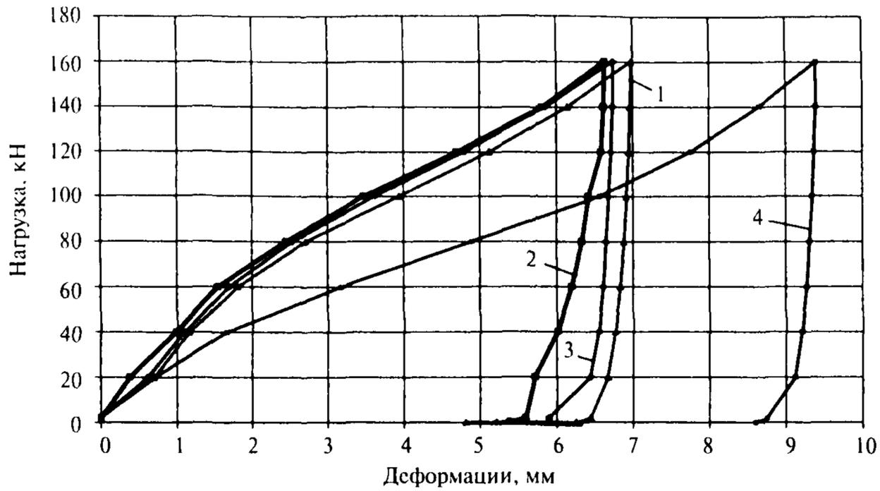
**Рисунок 3.3 — Графики деформаций при нагрузке и разгрузке песка в условиях компрессии:**
