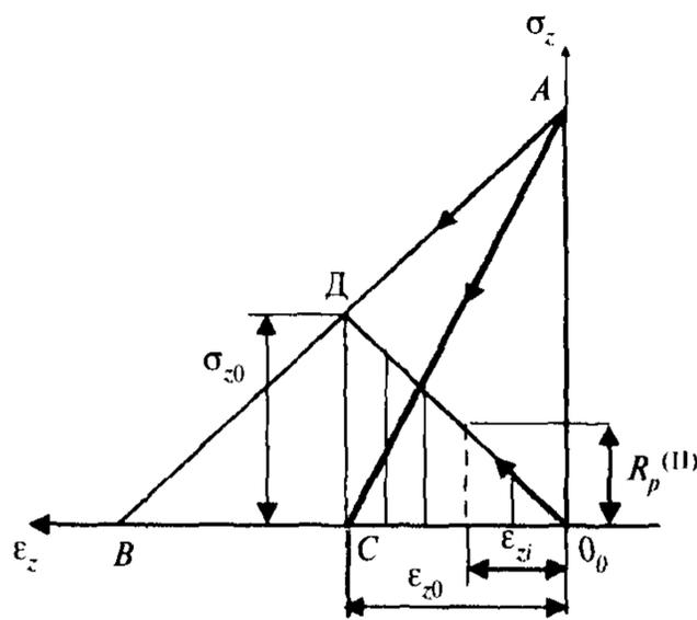
Рисунок Б.10 — Изменение НДС породы с генетическими напряжениями при разгрузке
