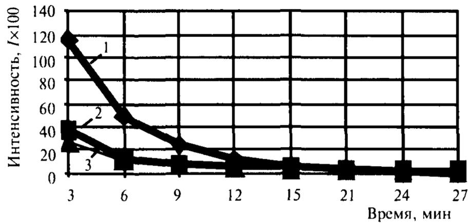
**Рисунок 3.5 — Затухание сигналов АЭ после разгрузки для несвязных сред различных фракций, мм:**
