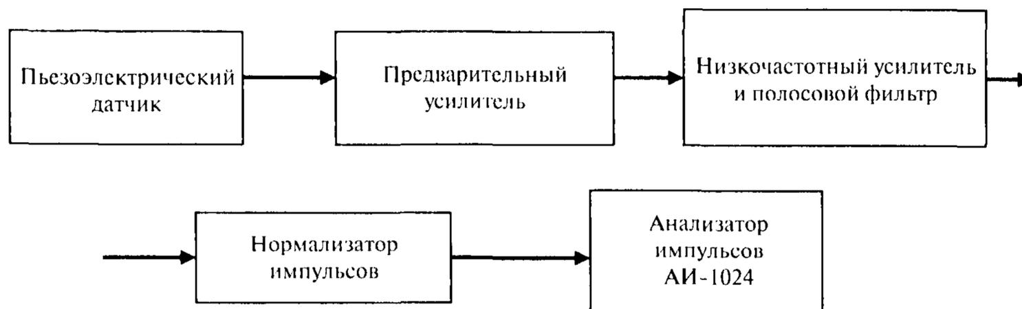
Рисунок 3.2 — Блок-схема измерительного комплекса сигналов акустической эмиссии
