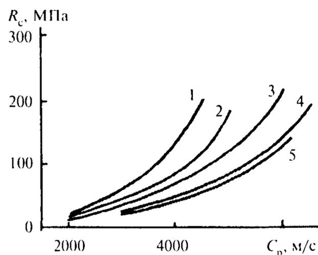
Рисунок 3.1 — Графики связи величин прочности на сжатие ( $R_c$ ) и скорости распространения продольных упругих волн для пород:
