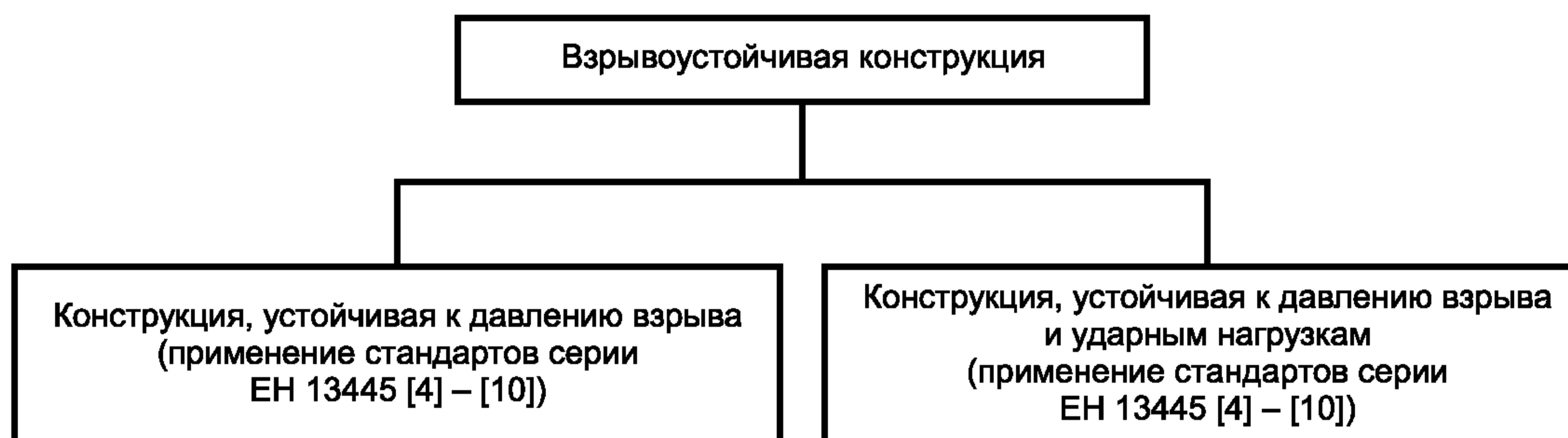
Рисунок 1 — Схема взрывоустойчивой конструкции
