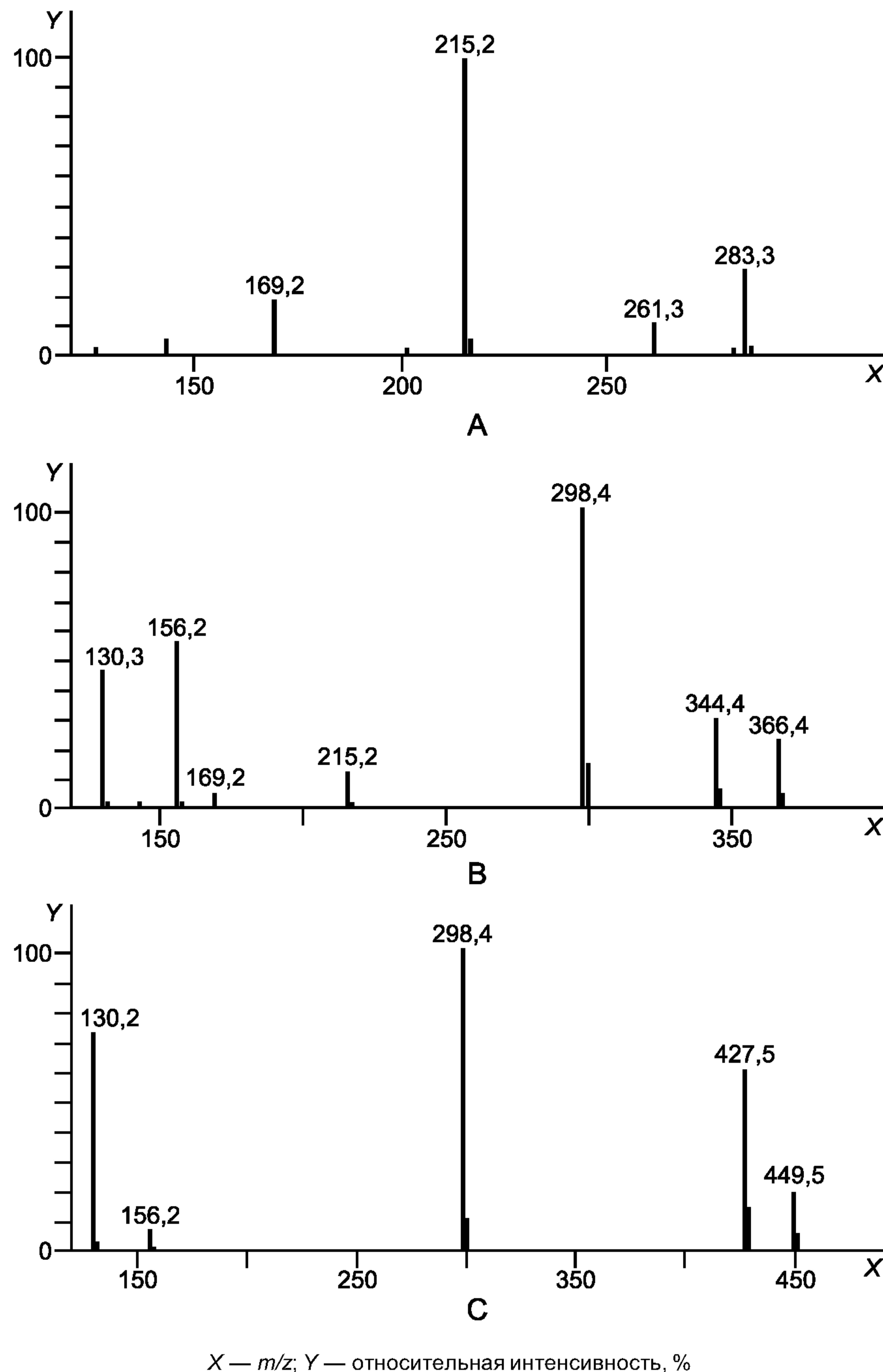
Рисунок В.4 — Масс-спектры с указанием относительной интенсивности для ЭТ-производного НАД (А), ЭТ-ДБА-производного НАІ (В) и ДБА-производного HDI (С), полученные методом жидкостной хроматографии с использованием масс-спектрометрического детектора с электроспреем
