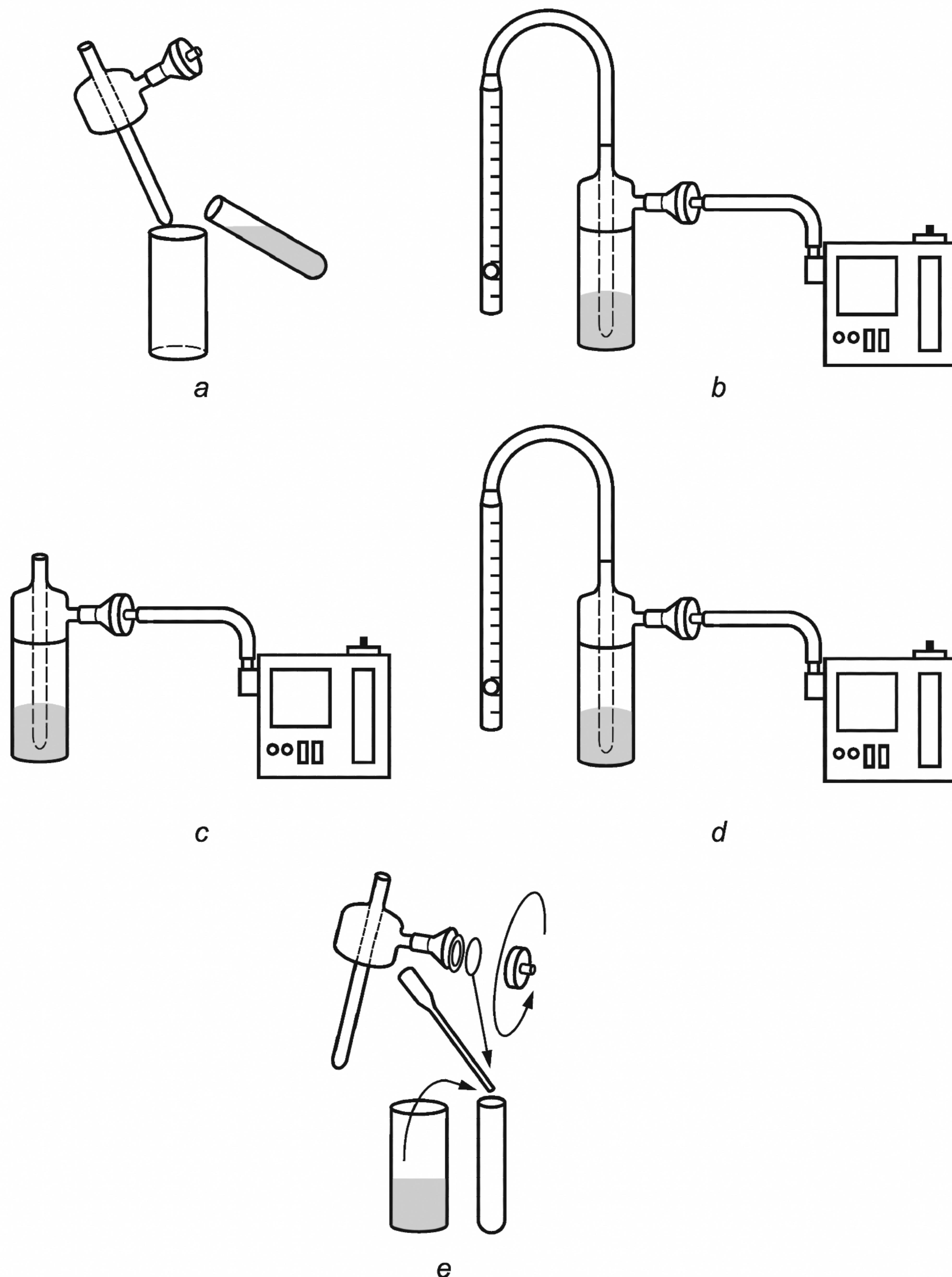
**а** — раствор для импинжера переносят в импинжерную склянку; **б** — измеряют расход и калибруют насос для отбора проб на расход 1 л/мин; **в** — отбор пробы воздуха; **г** — измеряют расход; **д** — переносят раствор пробы из импинжера в пробирку. Фильтр переносят в эту же пробирку или в другую пробирку с раствором для экстракции
