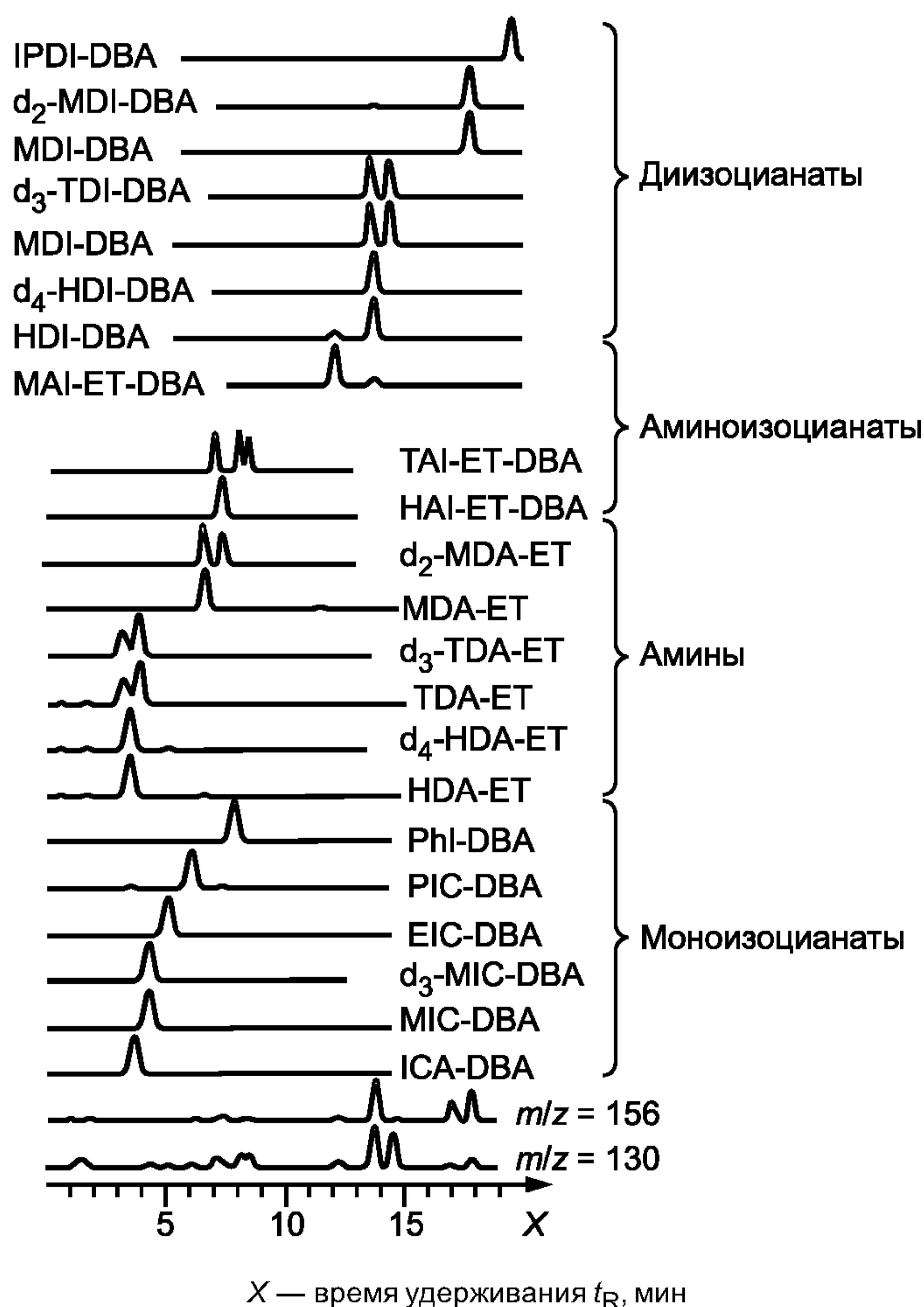
**П р и м е ч а н и е** — Был выбран режим регистрации ионов для 22 различных молекулярных ионов  $[M\dot{H}]^+$  и ионов с отношениями массы к заряду  $m/z = 130$  и  $156$  а. е. м. соответственно. Высота пиков условно принята за 100 % (в произвольном масштабе).
