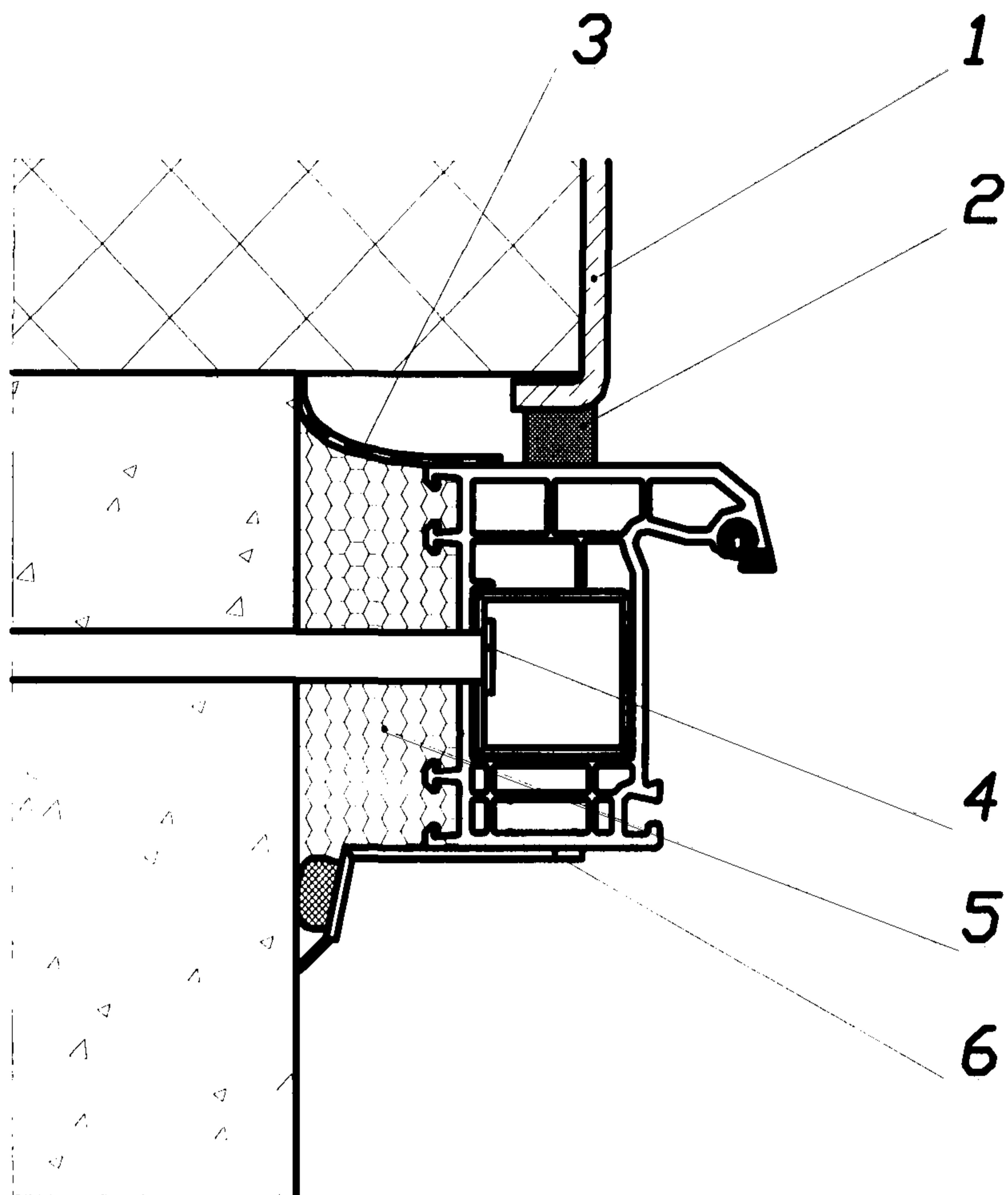
1 – элемент отделки наружного оконного откоса; 2 – изоляционная саморасширяющаяся паропроницаемая лента (ПСУЛ); 3 – водоизоляционная паропроницаемая лента; 4 – рамный дюбель; 5 – пенный утеплитель; 6 – нашельник из ПВХ в комбинации с пароизоляционным вкладышем
