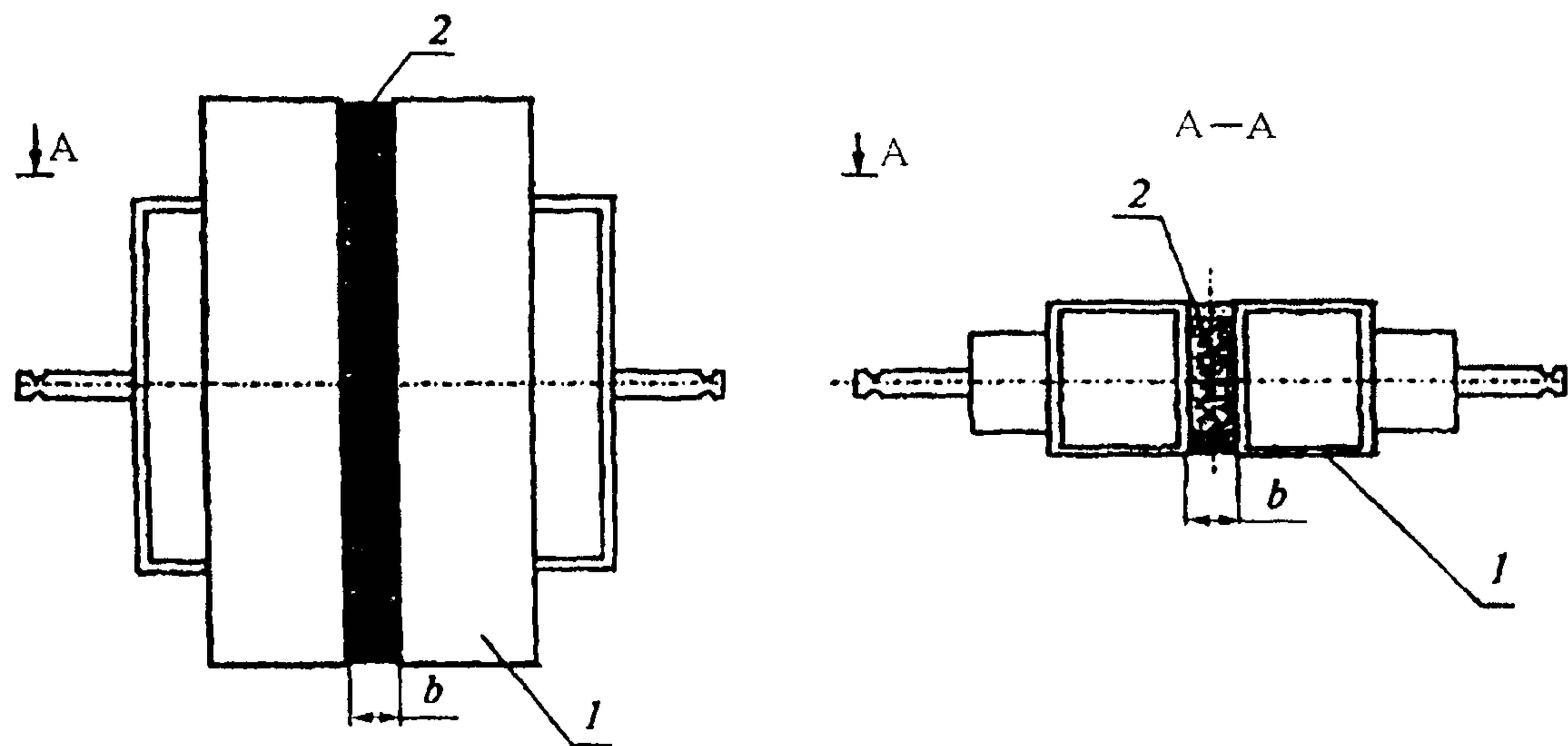
$b$  – толщина шва; 1 – обойма из алюминия или нержавеющей стали толщиной 3 мм;
