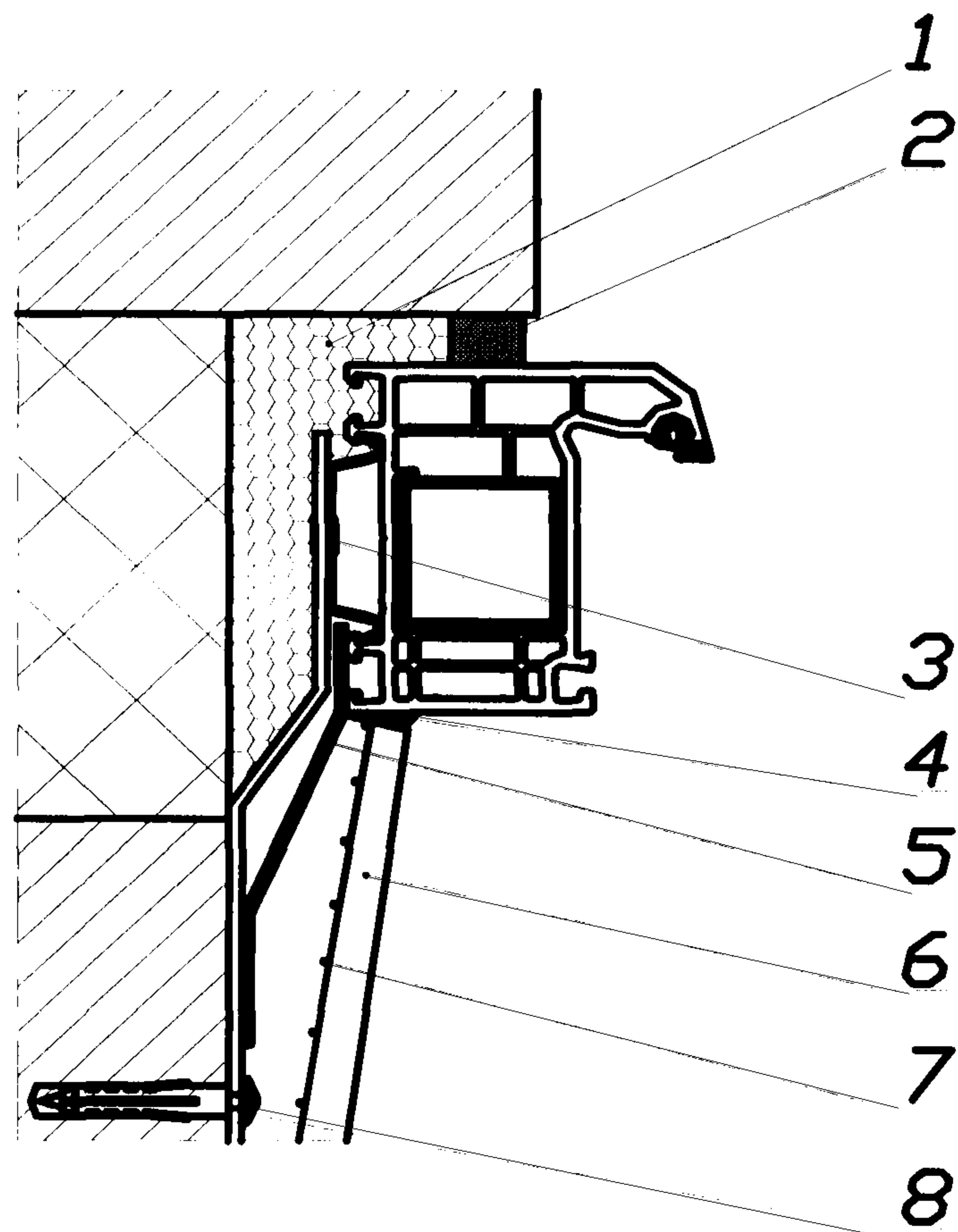
1 – пенный утеплитель; 2 – изоляционная саморасширяющаяся паропроницаемая лента (ПСУЛ); 3 – гибкая анкерная пластина; 4 – герметик; 5 – пароизоляционная лента; 6 – штукатурный слой внутреннего откоса (с фаской для слоя герметика); 7 – армирующая сетка; 8 – дюбель со стопорным шурупом
