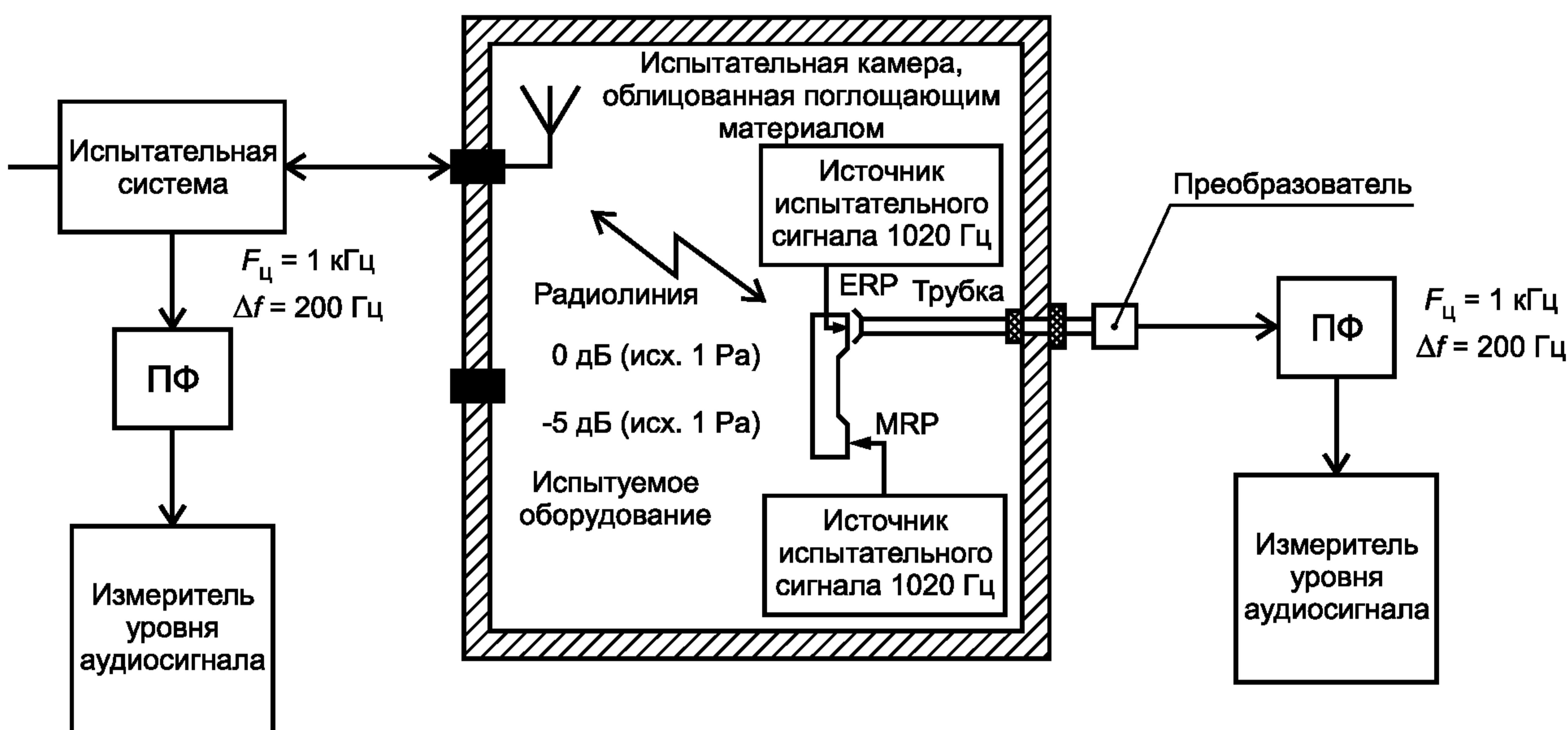
ПФ — полосовой фильтр;  $F_{\text{ц}}$  — центральная частота полосы пропускания фильтра;  $\Delta f$  — полоса пропускания фильтра;
