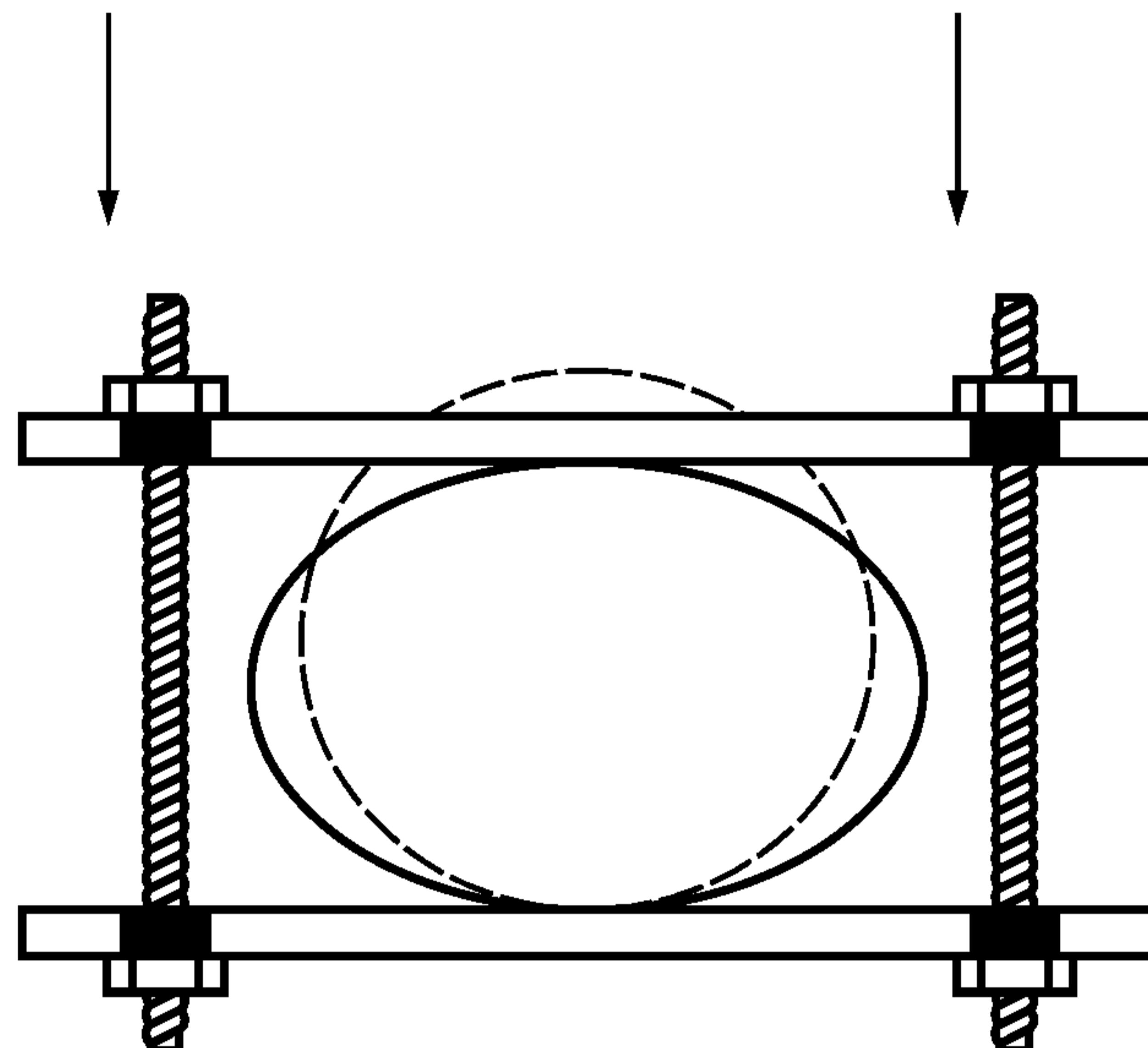
Рисунок 13 — Схема приложения нагрузки
