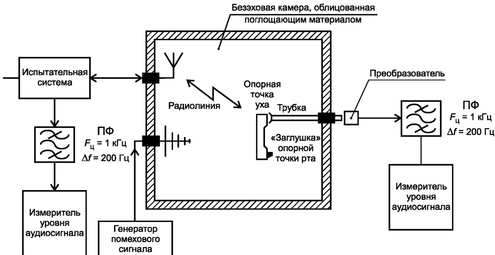
ПФ — полосовой фильтр;  $F_{ц}$  — центральная частота полосы пропускания фильтра;  $\Delta f$  — полоса пропускания фильтра
