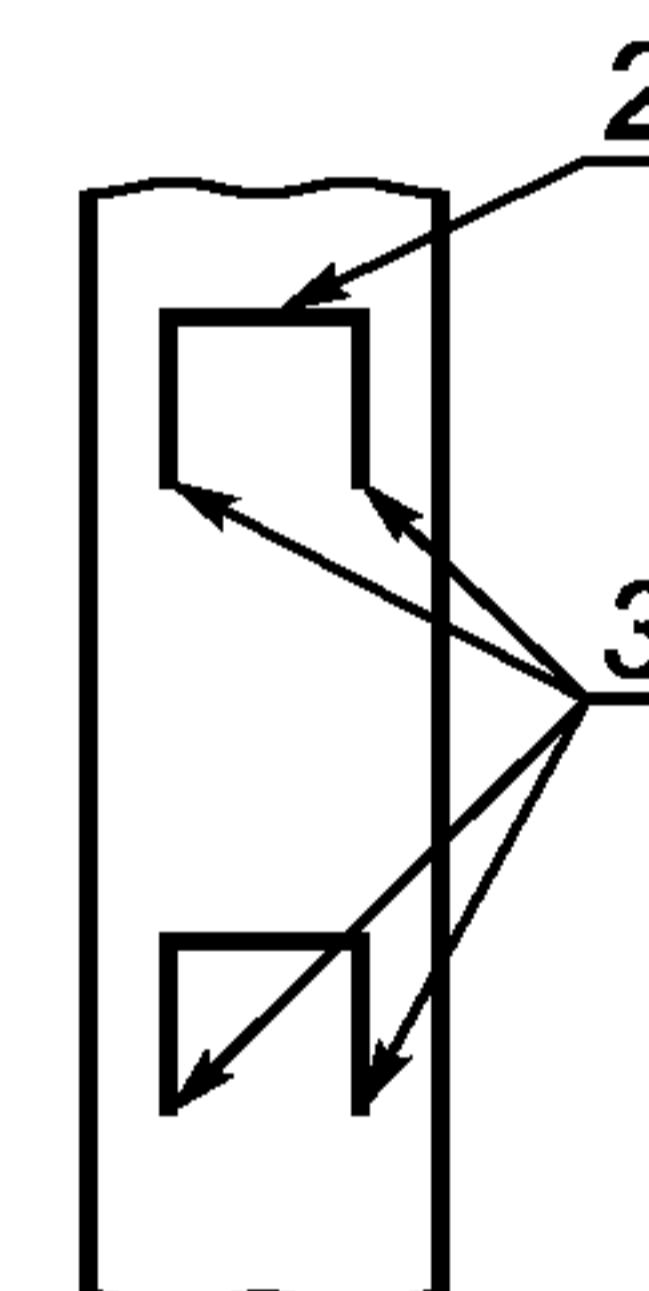
Рисунок 6д — Схема расположения ступеней П-образного профиля
