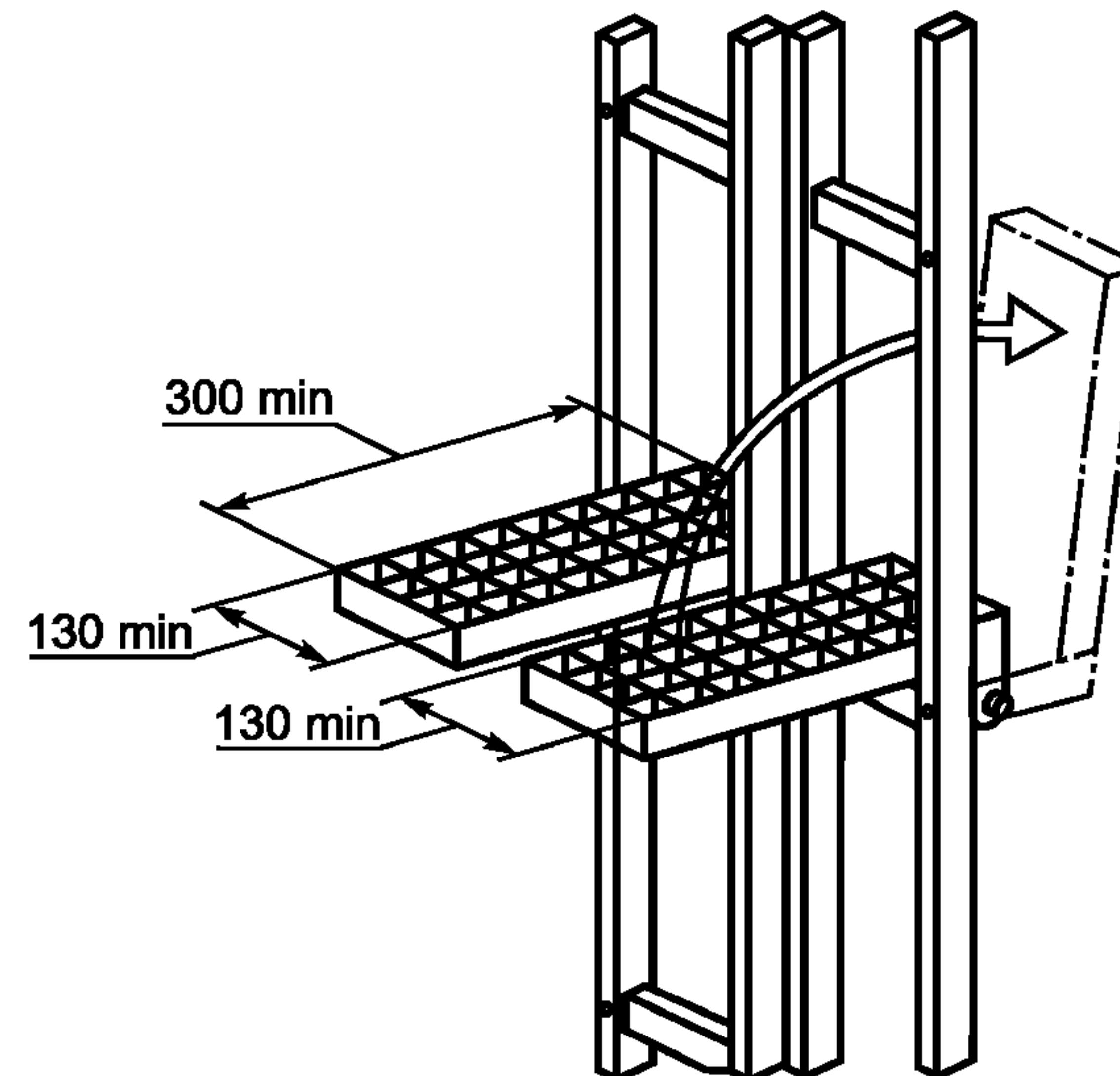
Рисунок 11 — Пример поворотной площадки для отдыха (две части)
