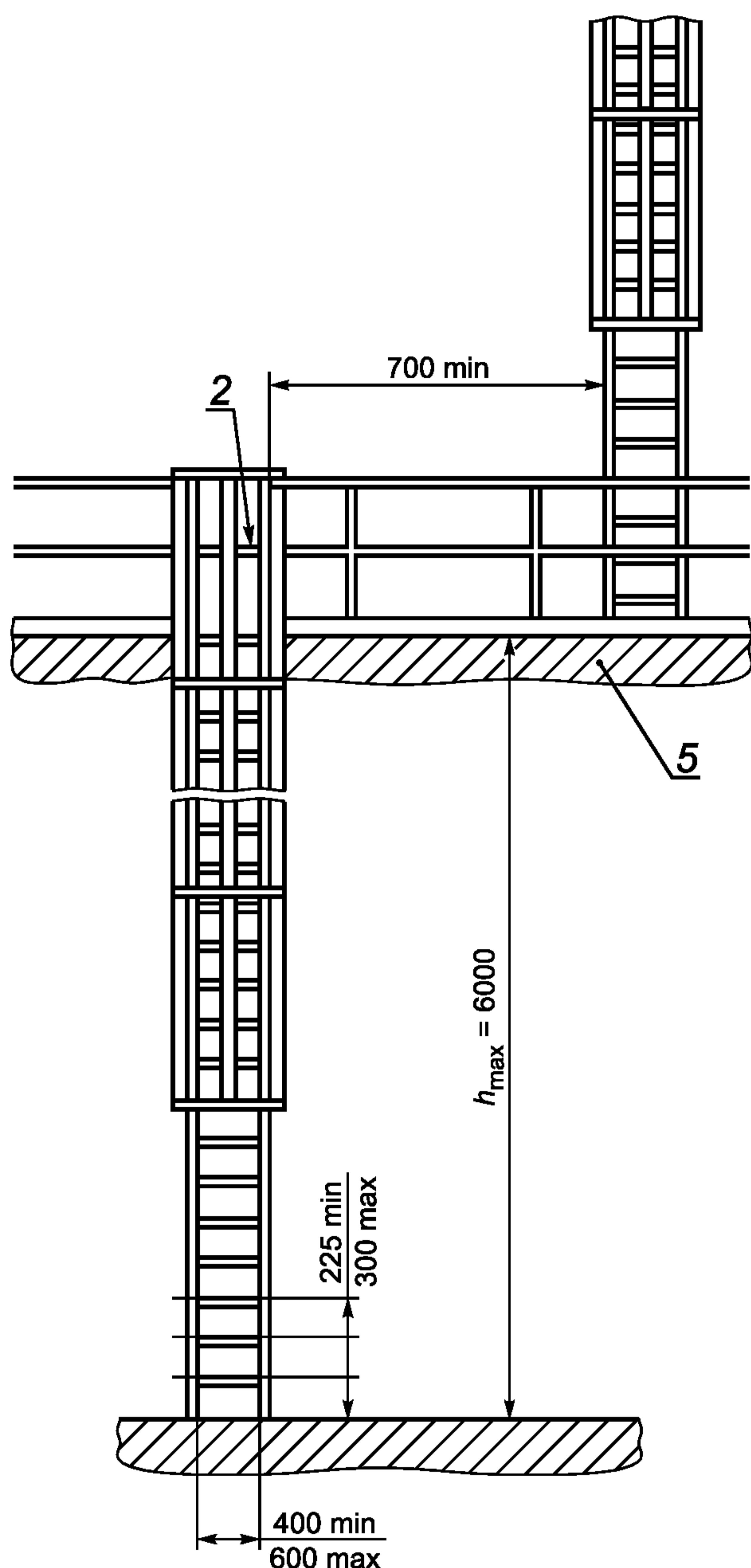
Рисунок 4б — Вид спереди лестницы с защитным ограждением
