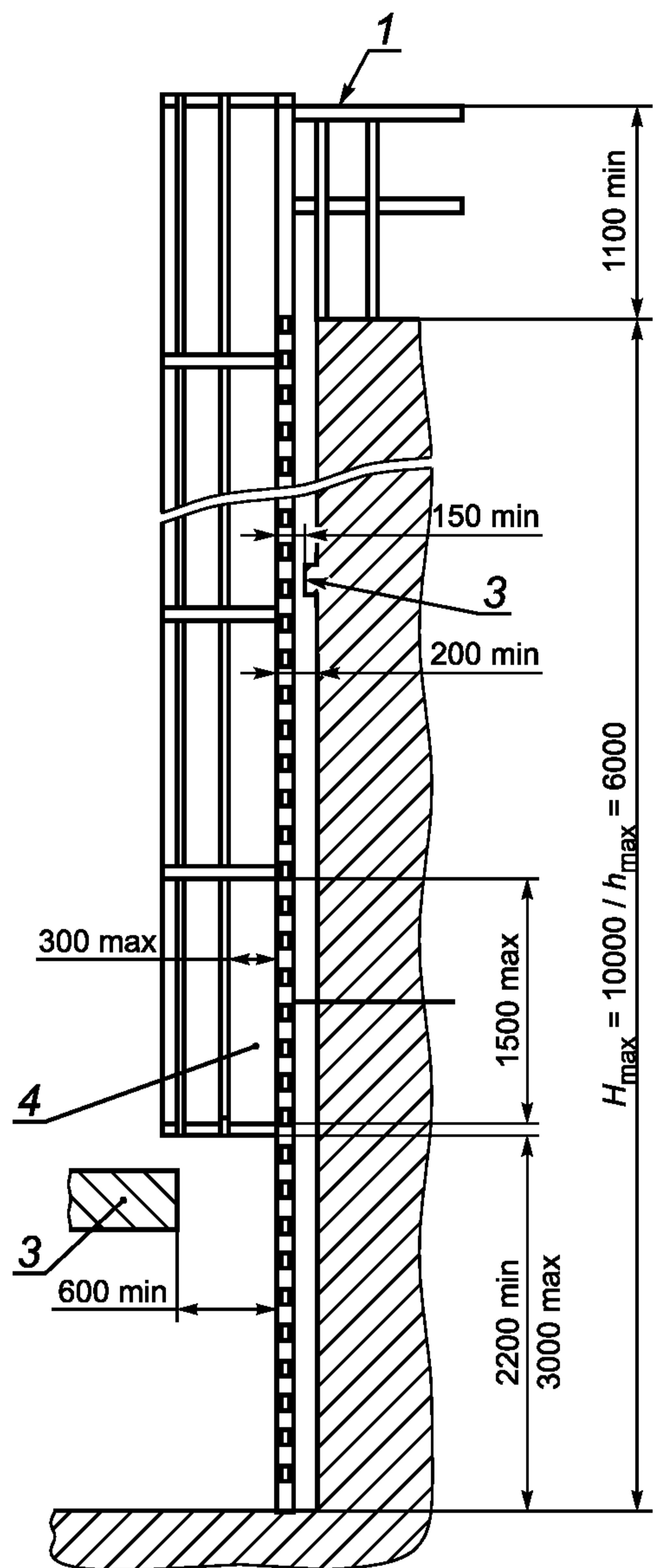
Рисунок 4а — Вид сбоку лестницы с защитным ограждением
