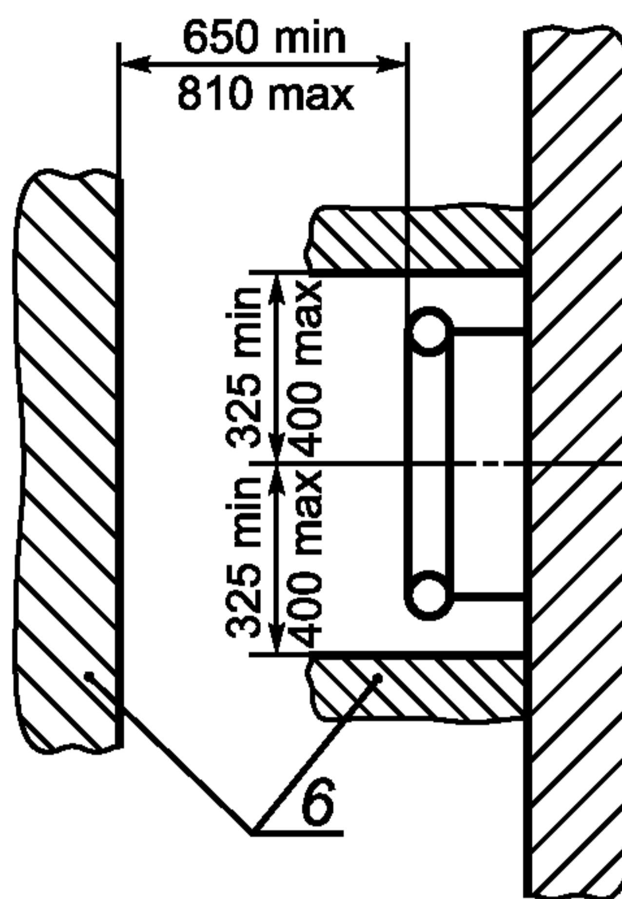
Рисунок 4d — Вид сверху лестницы без защитного ограждения
