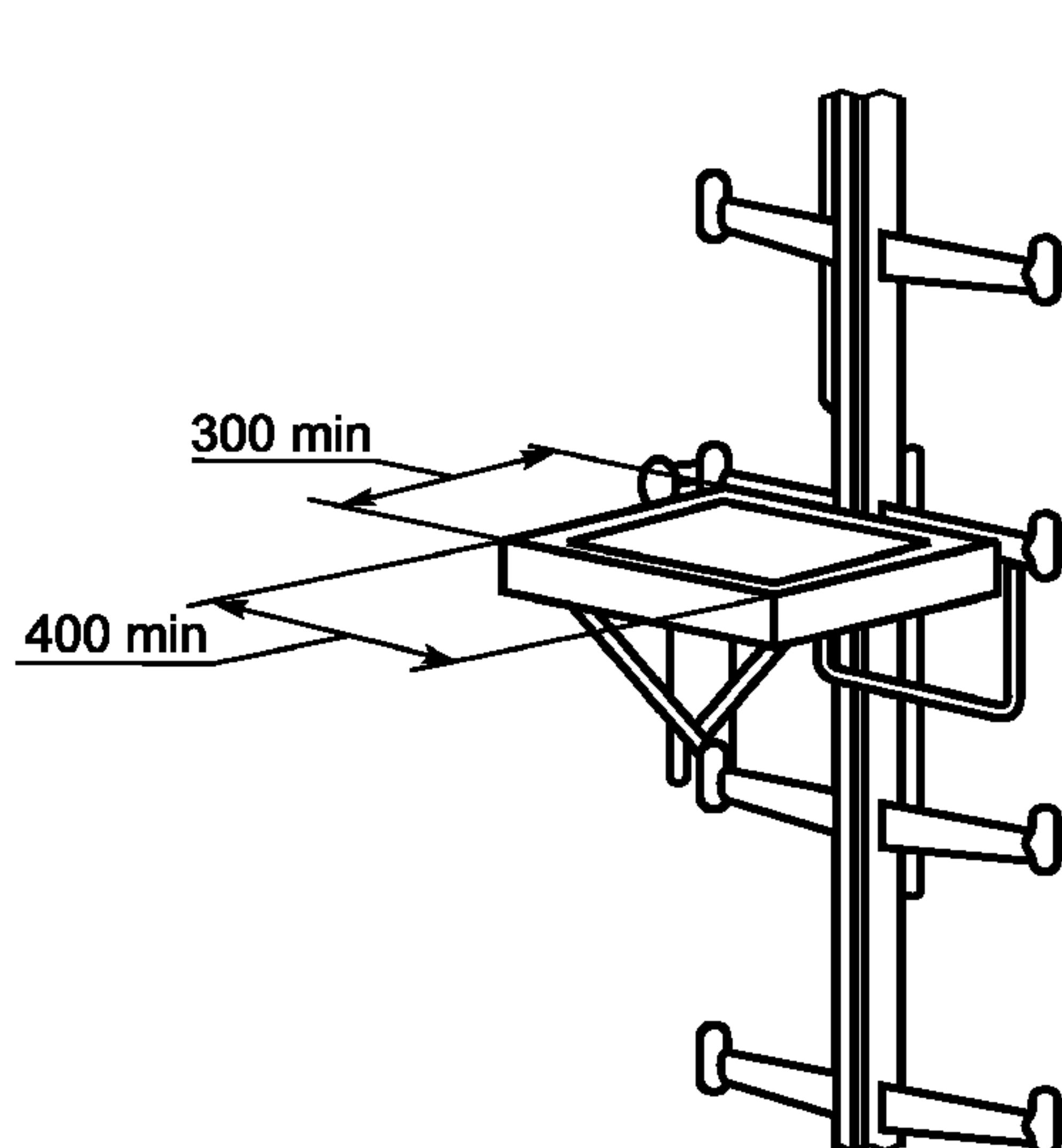
Рисунок 10 — Пример подъемной площадки для отдыха (одна часть)
