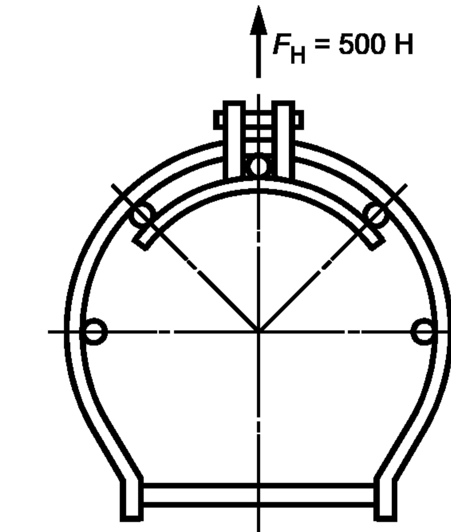
Рисунок 14 — Испытание защитного ограждения (в горизонтальном направлении)
