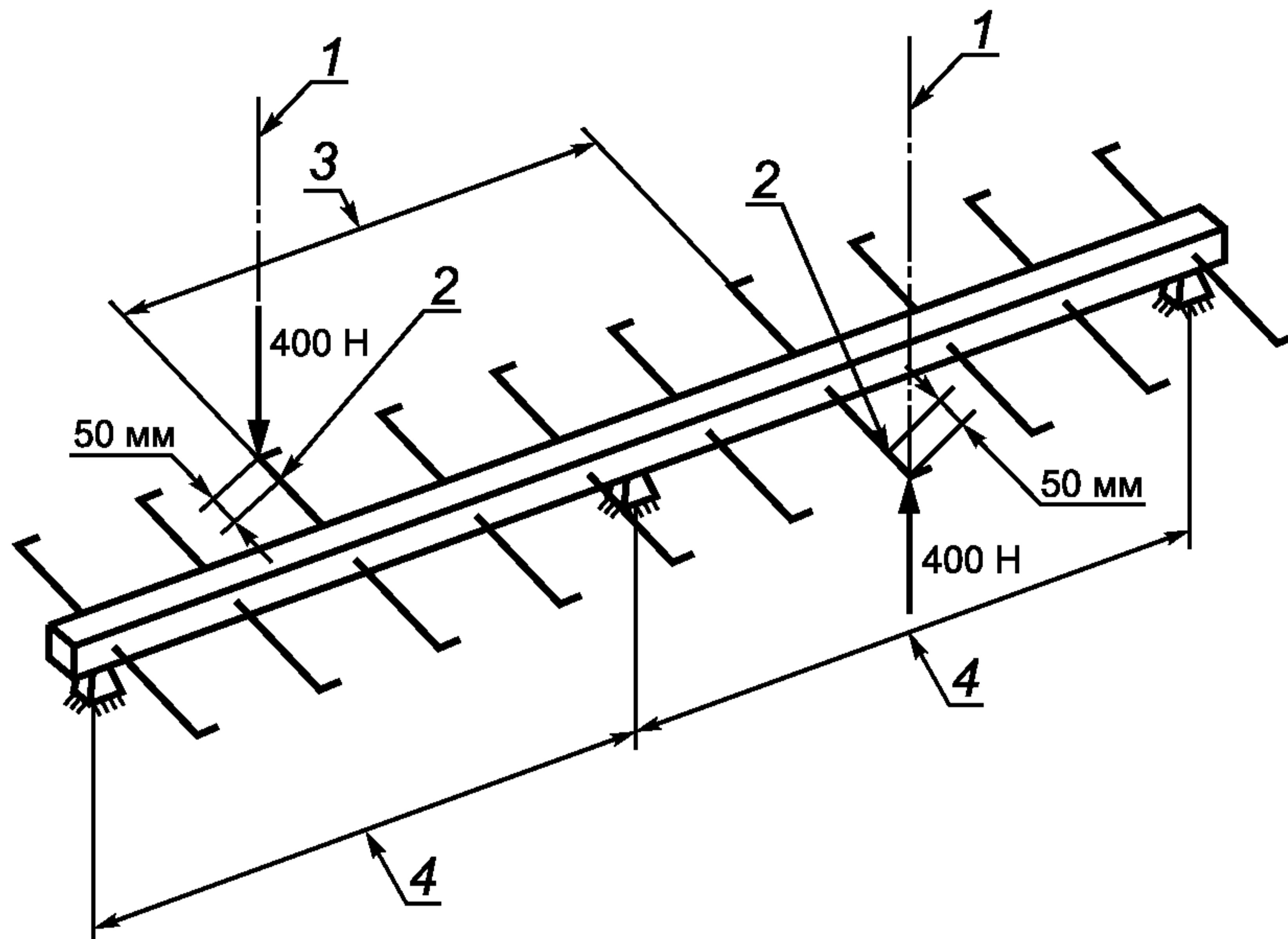
Направление обеих испытательных нагрузок по 400 Н должно быть перпендикулярно к поверхности лестницы, длина испытуемой лестницы должна быть не менее расстояний между двумя последовательными точками анкерного крепления. Лестницу следует монтировать на земле в точках анкерного крепления.
