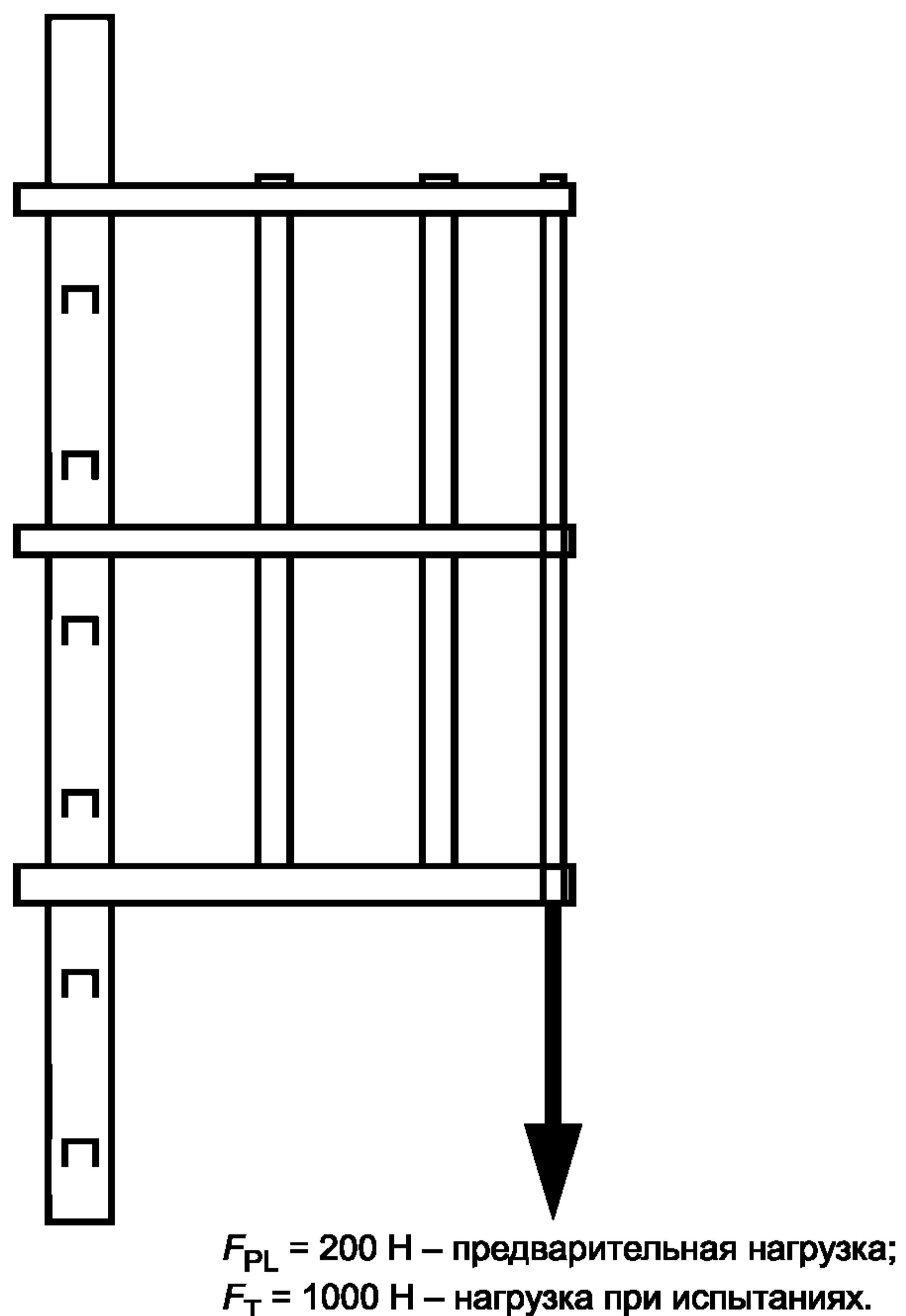
Рисунок 13 — Испытание защитного ограждения (в вертикальном направлении)
