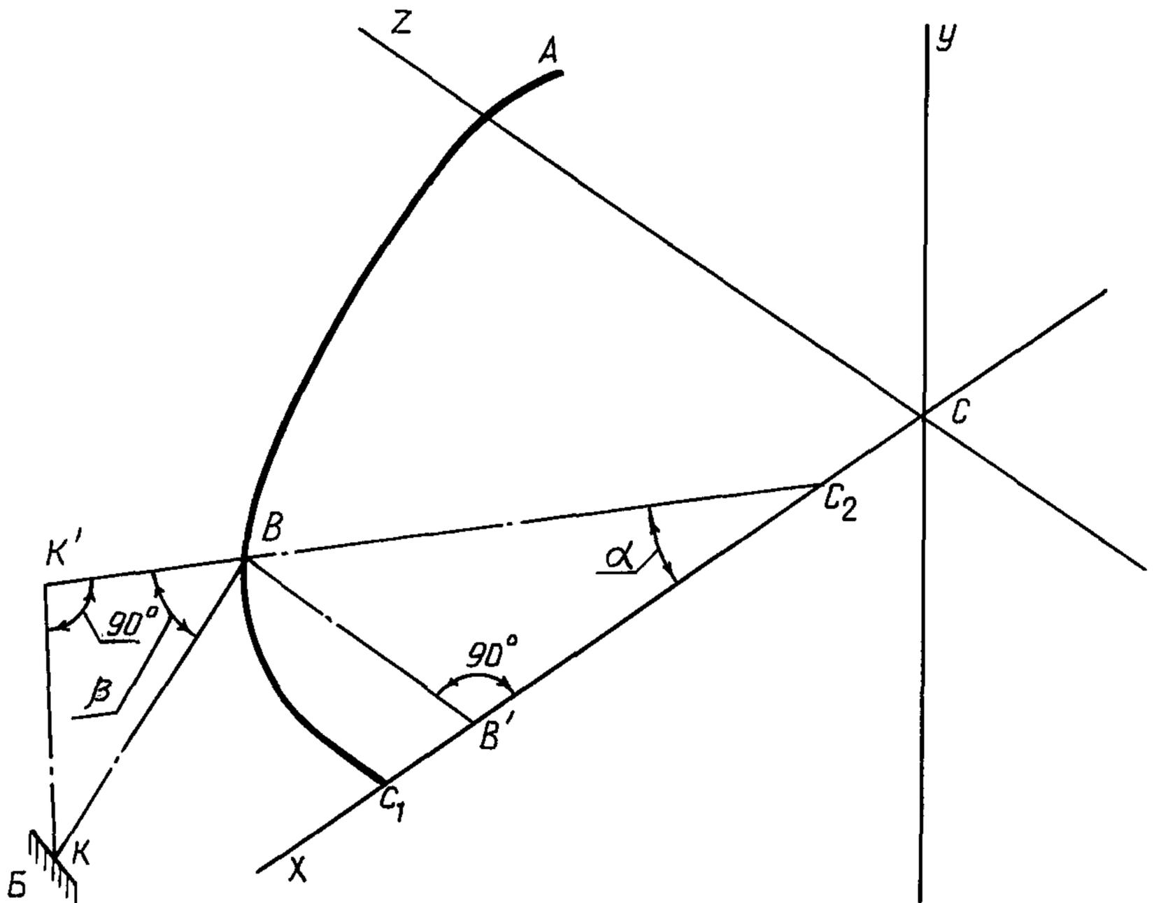
$CXYZ$  - система координат рабочего места летчика;  $C_1A$  - предельная траектория визирной точки в главной визирной плоскости;  $C_2$  - главная визирная точка (азимутальный центр);  $BK$  - линия визирования;  $BK'$  - проекция линии визирования на главную визирную плоскость;  $B'C_2$  - проекция  $BC_2$  на ось  $X$ ;  $\angle \alpha$  - горизонтальный угол обзора;  $\angle \beta$  - вертикальный угол обзора;  $B$  - граница остекления
