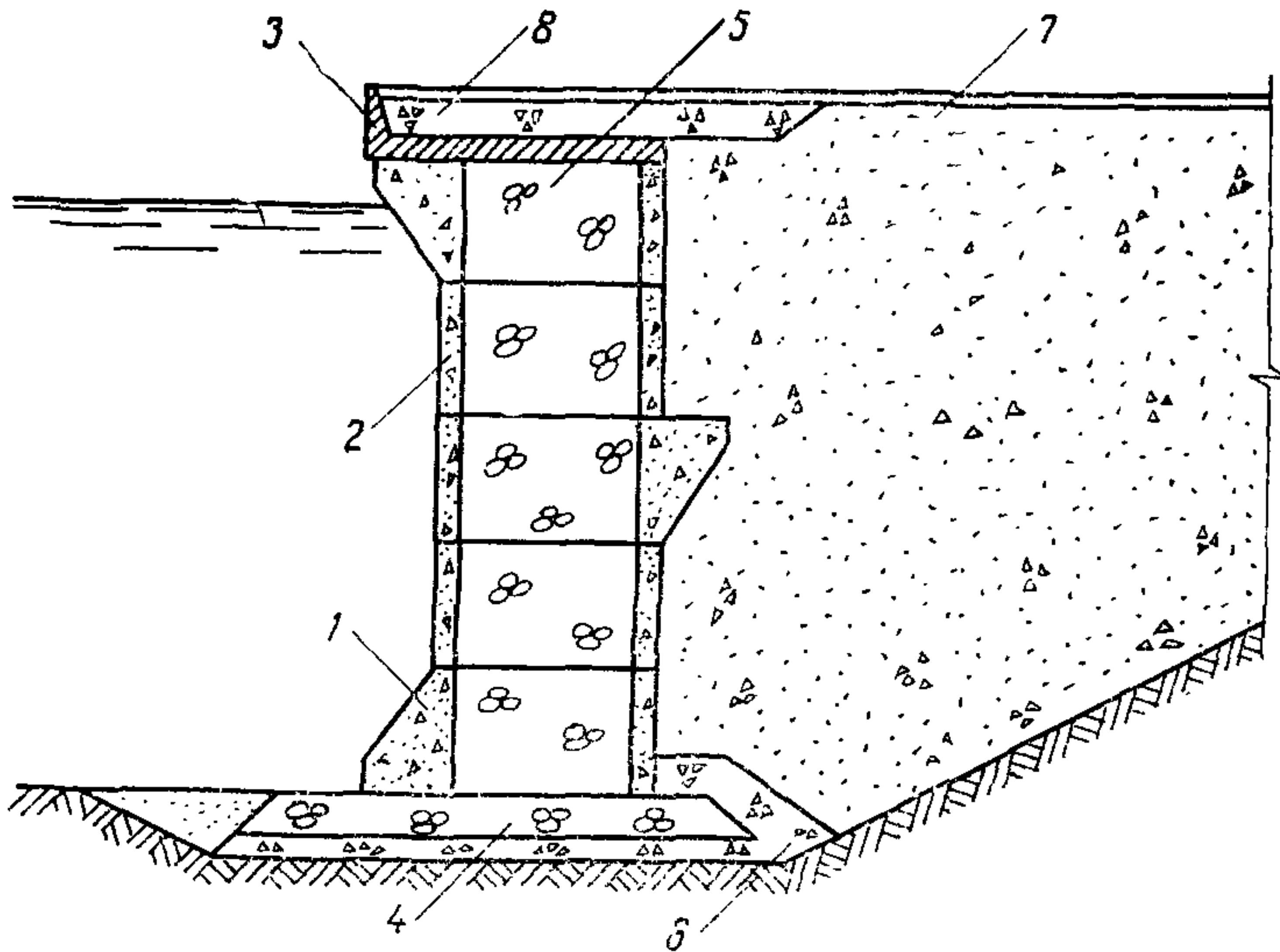
Рис. 1. Схема причального сооружения из пустотелых бетонных массивов:
