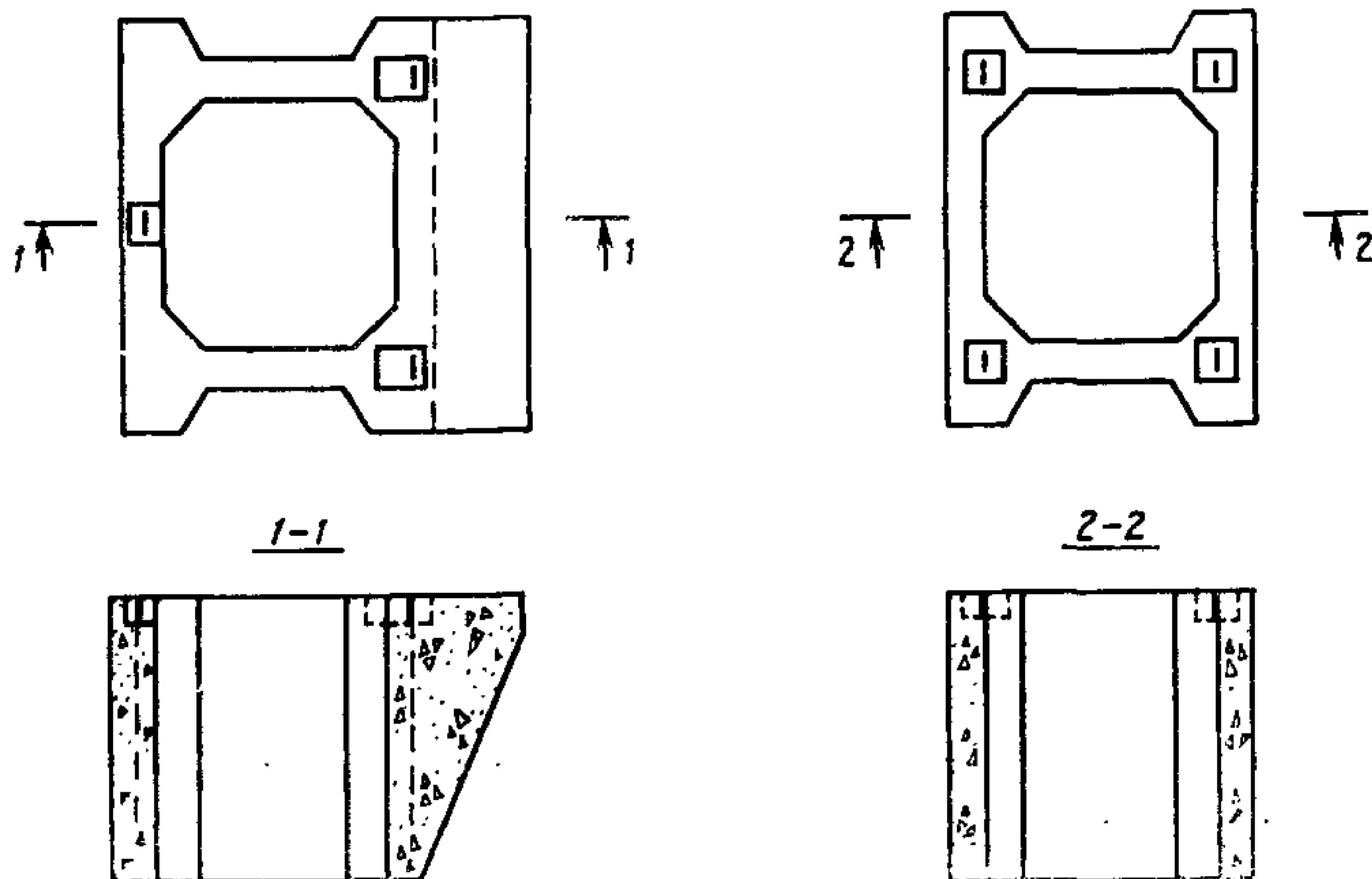
Рис. 3. Типы пустотелых бетонных массивов
