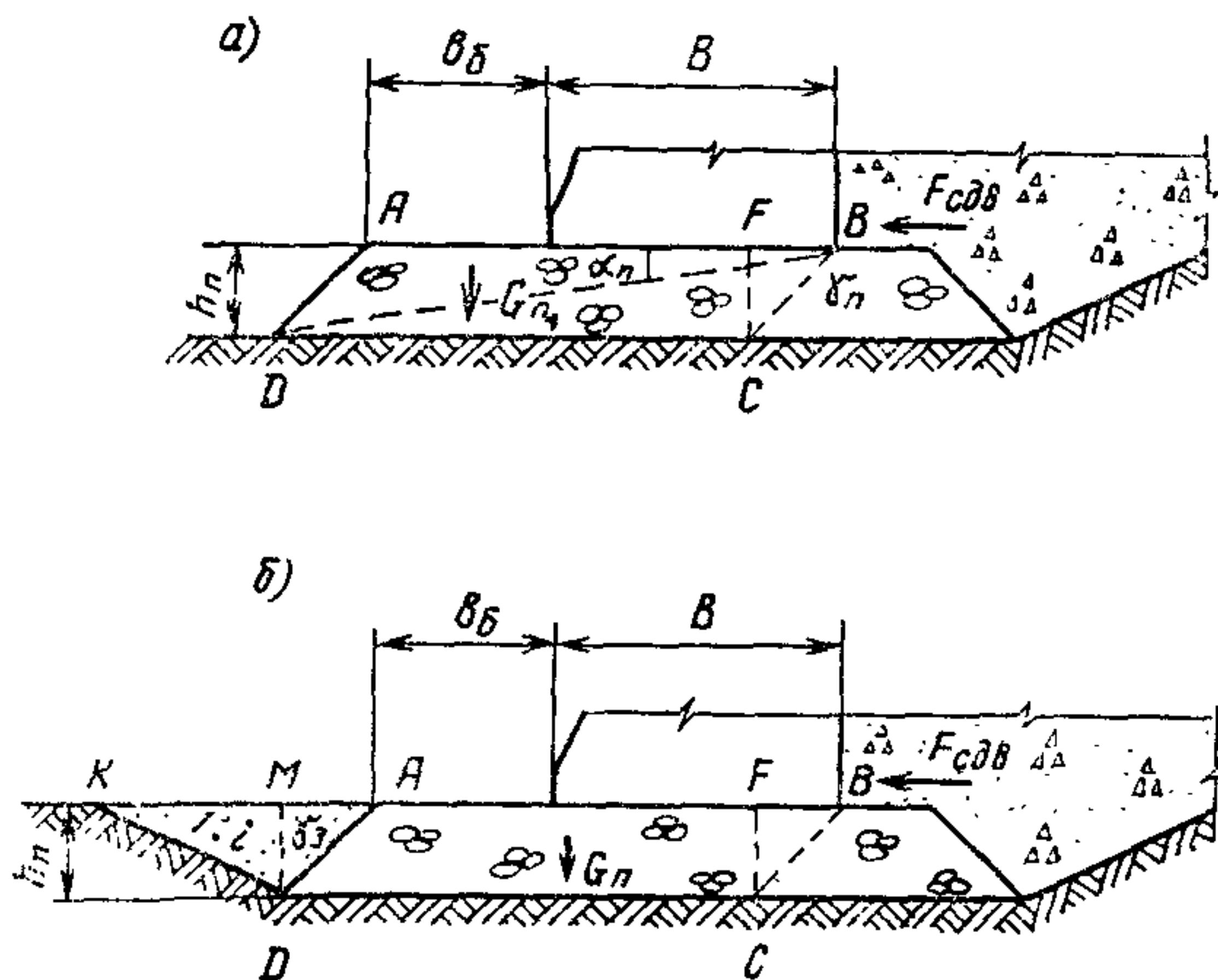
Рис. 8. Расчетная схема причального сооружения из пустотелых бетонных массивов при сдвиге:
