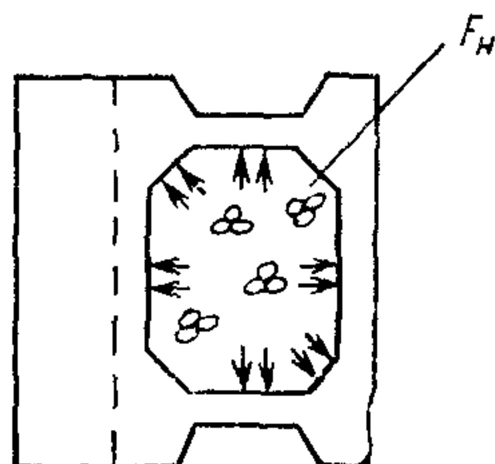
Рис. 7. Расчетная схема для определения давления грунта заполнителя на стенки массивов
