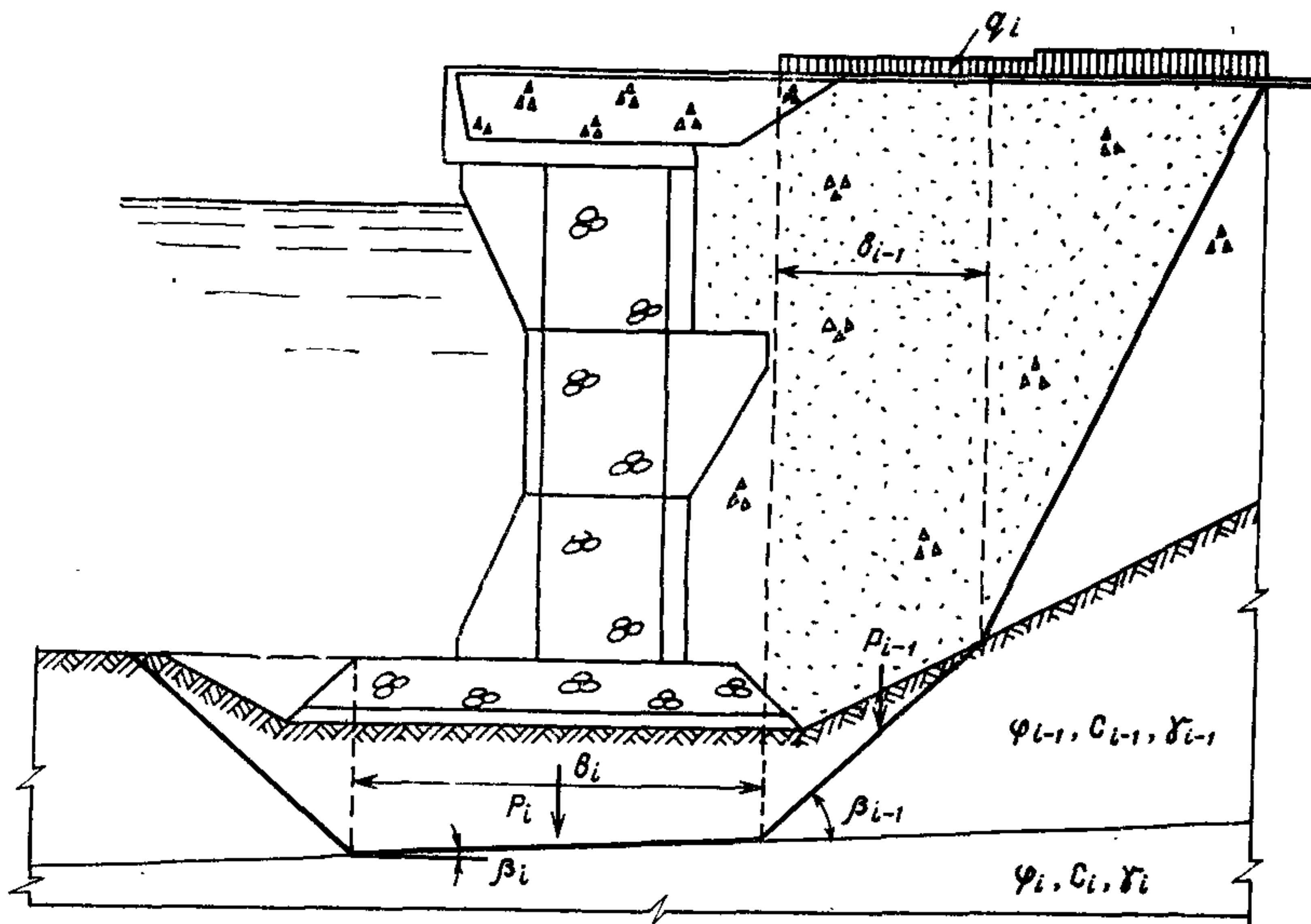
Рис. 11. Схема к расчету устойчивости причального сооружения из пустотелых бетонных массивов по методу ломанных поверхностей скольжения
