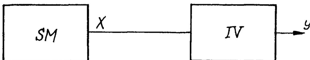
$SM$  - образцовая мера постоянного или переменного напряжения;
