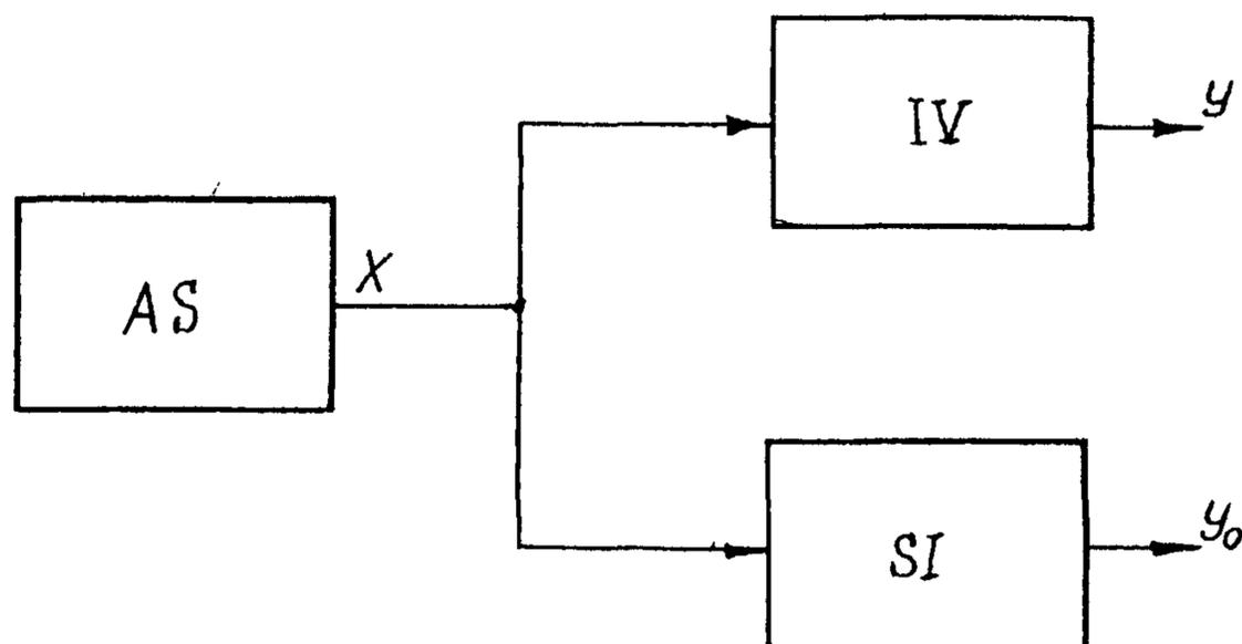
*AS* - регулируемый источник постоянного или переменного напряжения;
