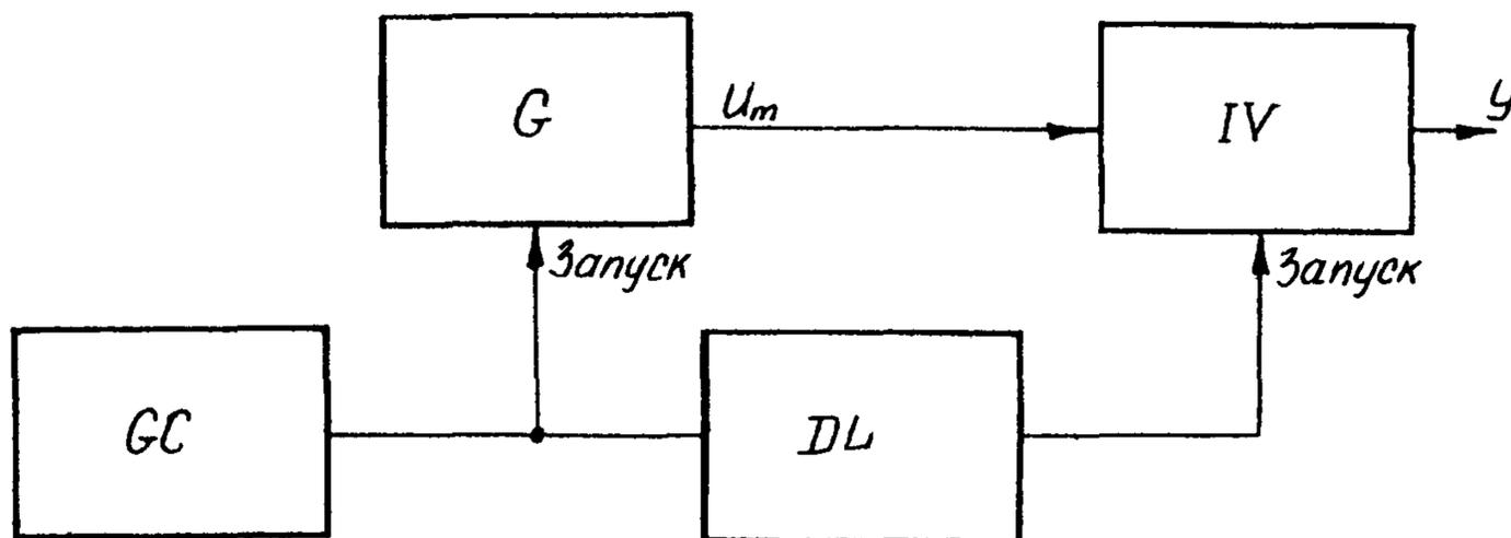
$G$  - генератор-источник ступенчатого сигнала;
