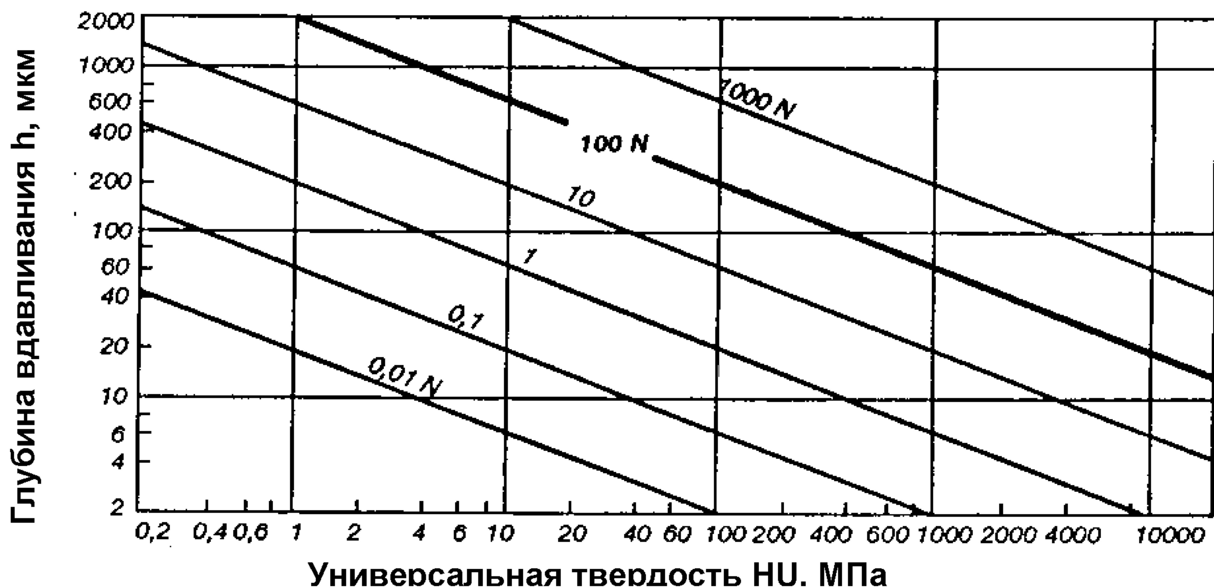
Рисунок В.3 – Номограмма определения универсальной твердости
